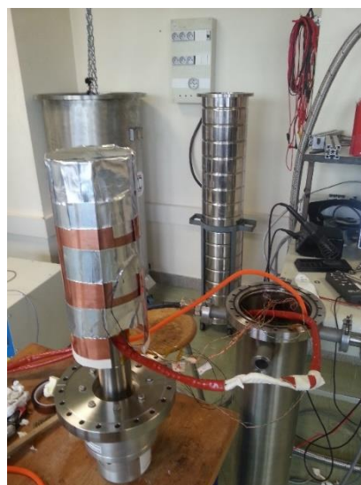
Figure 122 : Ecran thermique installé sur la tête froide.
