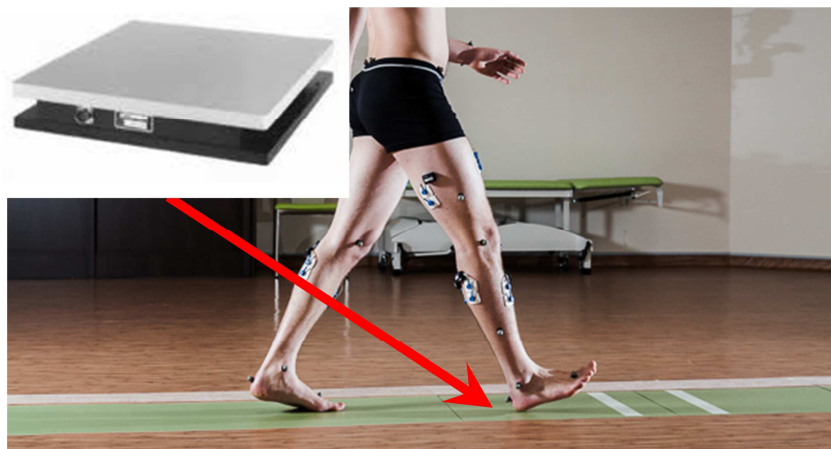
Figure 23. Plateforme de force AMTI, intégrée au sol
