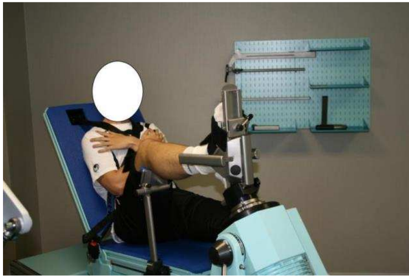
Figure 66. Positionnement des participants pendant l'évaluation des couples articulaires en inversion (INV) et en éversion (EV)
