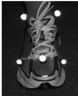
Figure 52. Placement des marqueurs sur les chaussures, étude de Chinn et al., 2013
