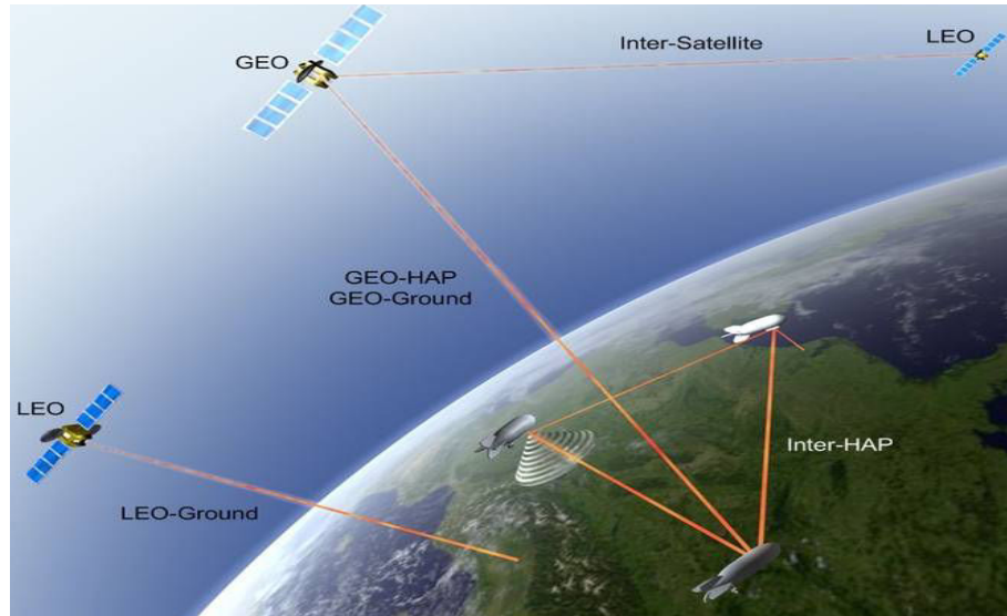
Figure 1.2 – Différentes configurations de liaisons optiques en espace libre pour le spatial.
