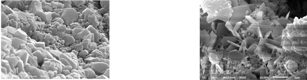
Figure 1.7 – Cristaux de carbonate de calcium \text{CaCO}_3 (à gauche) et plaquettes de portlandite \text{Ca(OH)}_2 à droite.
