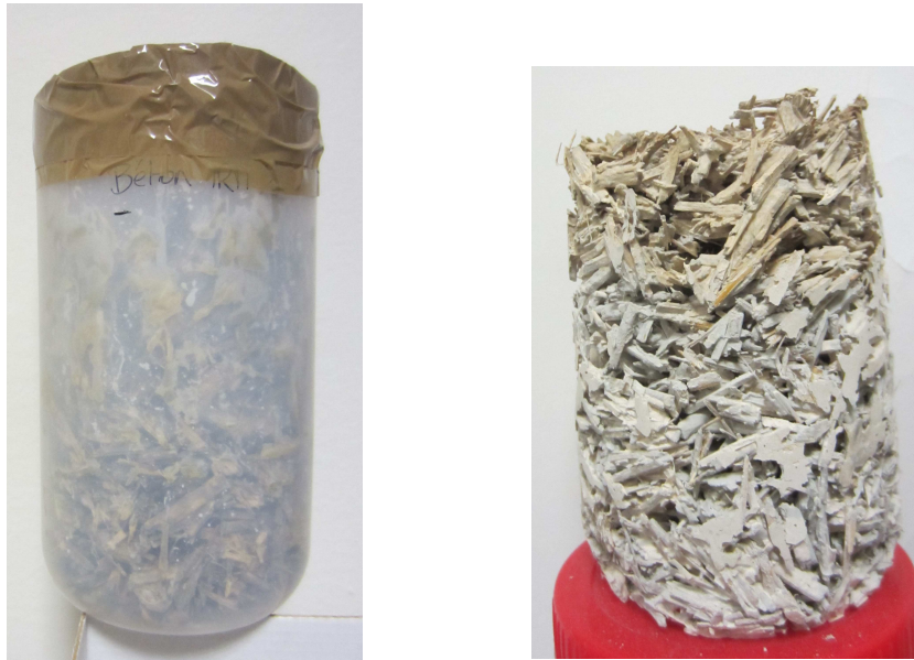
Figure 2.4 – A gauche : échantillon de béton de chanvre dans son moule avant ouverture. A droite, échantillon de béton de chanvre après les 3 mois de prise, une fois le moule intégralement retiré. Il est intéressant de noter qu’une couche plus foncée apparaît sur les premiers centimètres du haut de l’éprouvette, caractéristique d’une croûte observée dans les cas de farinage.
