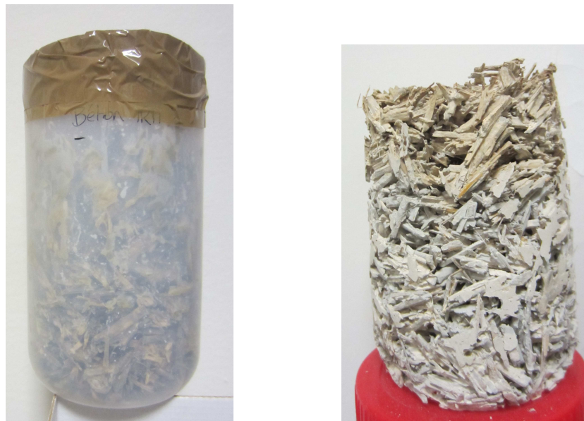
Figure 2.4 – A gauche : échantillon de béton de chanvre dans son moule avant ouverture. A droite, échantillon de béton de chanvre après les 3 mois de prise, une fois le moule intégralement retiré. Il est intéressant de noter qu’une couche plus foncée apparaît sur les premiers centimètres du haut de l’éprouvette, caractéristique d’une croûte observée dans les cas de farinage.
