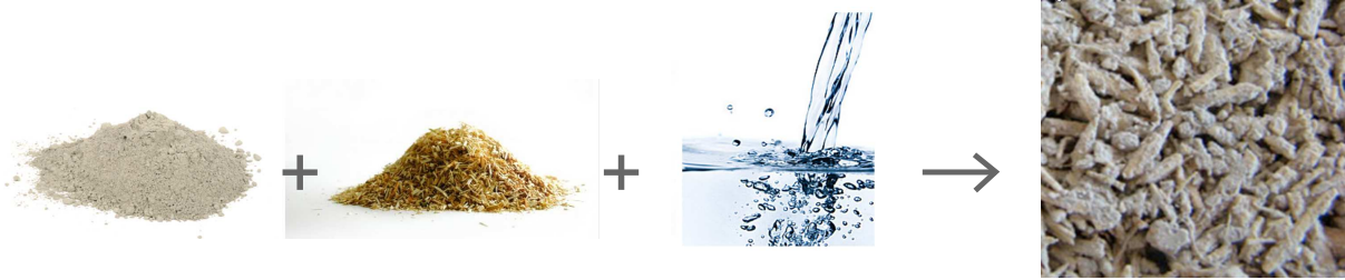
Figure 1.1 – Composition du béton de chanvre
