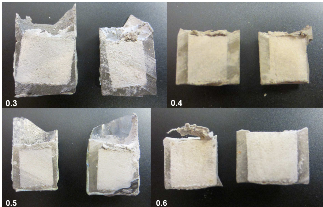
Figure 5.4 – Photos des échantillons de ciment+fritté après la prise. Le E/C initial de la pâte de ciment est indiqué pour chaque échantillon.
