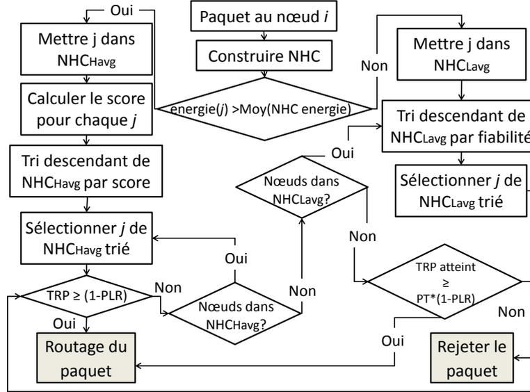
Figure 6.1 – L’algorithme de routage proposé où  $NHC_{Havg}$  et  $NHC_{Lavg}$  sont deux sous-ensembles de NHC contenant les nœuds dont l’énergie résiduelle est supérieure et inférieure à l’énergie résiduelle moyenne de NHC, respectivement.
