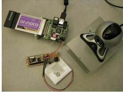
Figure 1.10 – Nœud capteur vidéo Meerkats et ses composants (Boice *et al.*, 2006)
