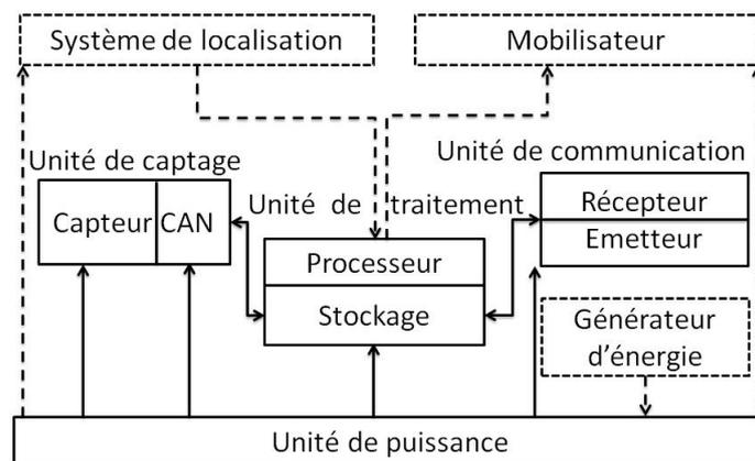
Figure 1.2 – Architecture physique d'un nœud capteur
