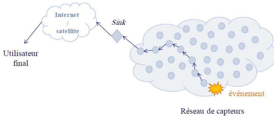
Figure 1.1 – Un réseau de capteurs sans fil
