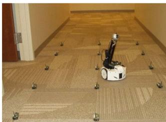
Figure 1.13 – GARCIA déployé sur le testbed agissant comme un Sink mobile et peut se déplacer vers la zone d'intérêt.
