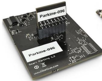
Figure 1.16 – Le module de détection de variation du champs magnétique
