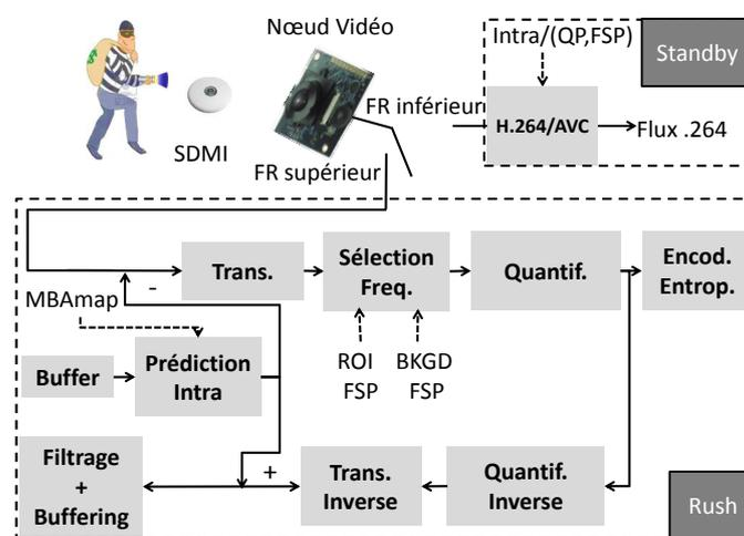
Figure 4.7 – Le diagramme en bloc du schéma d'encodage proposé
