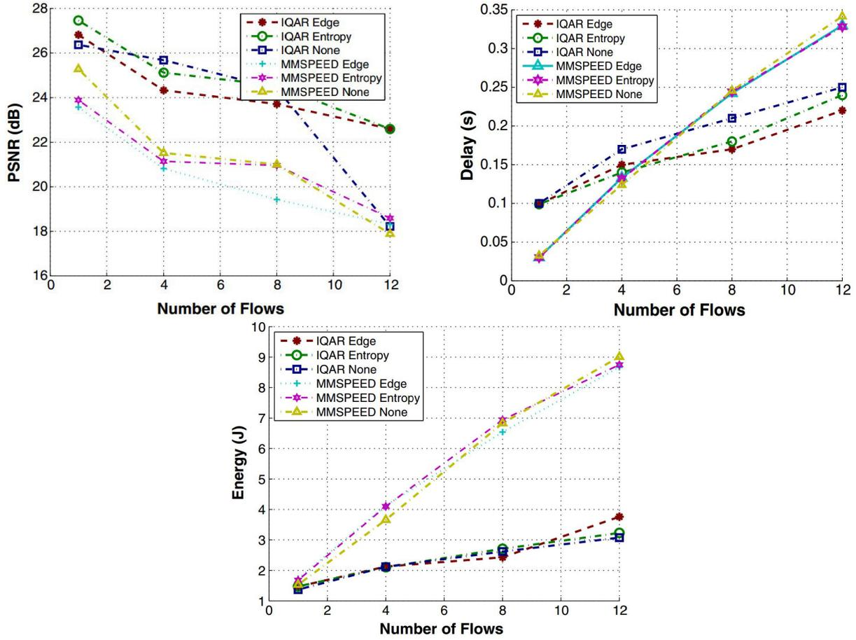
Figure 2.2 – Performances de l'approche proposée par (Boluk *et al.*, 2011b) en termes de qualité (à gauche) de délai (à droite) et de consommation d'énergie (au-dessous) comparée à l'approche utilisant le protocole MMSPEED
