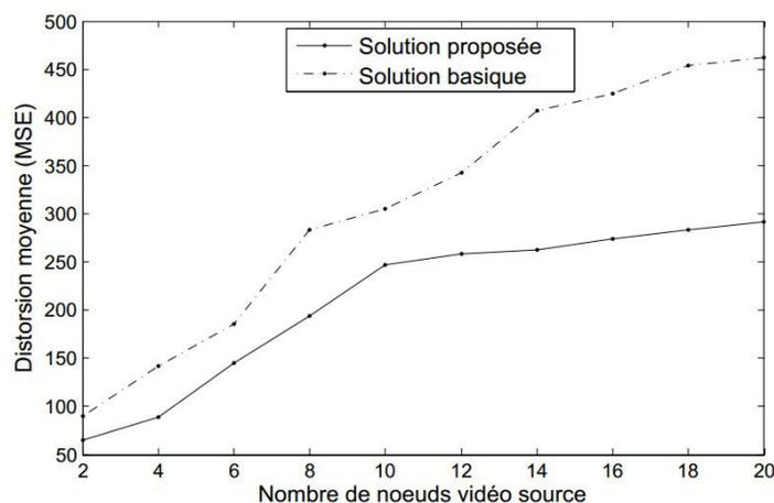
Figure 6.9 – Distorsion de bout-en-bout moyenne après dissimulation des pertes en fonction du nombre des nœuds source vidéo du réseau
