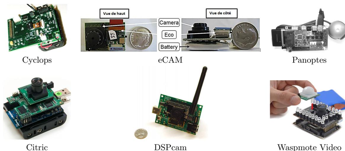
Figure 1.14 – Exemples de nœuds capteurs vidéo
