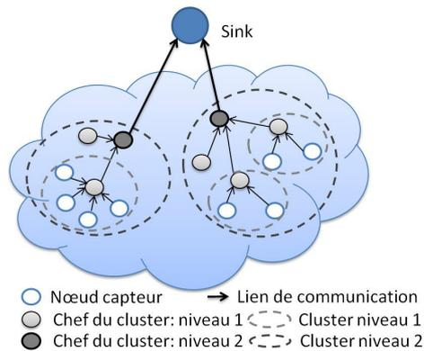
Figure 1.8 – Architecture en clusters à niveaux multiples
