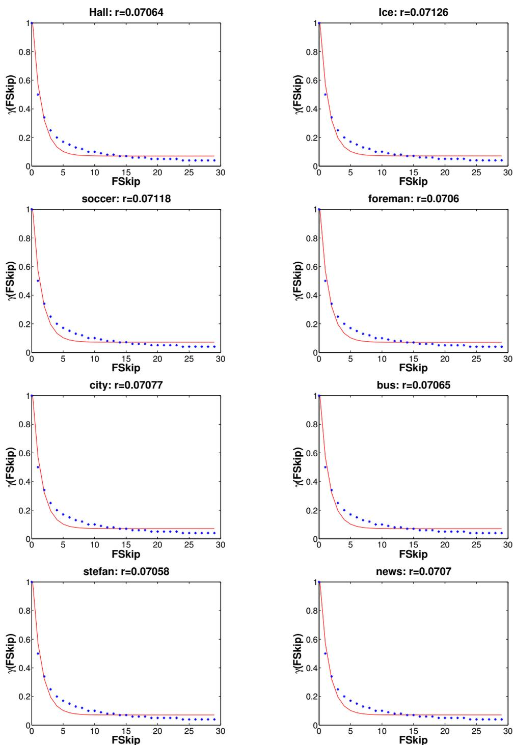
Figure 5.12 – Evolution des coefficients  $\gamma(FSkip)$  mesurés et prédits pour la transmission en fonction du paramètre  $FSkip$
