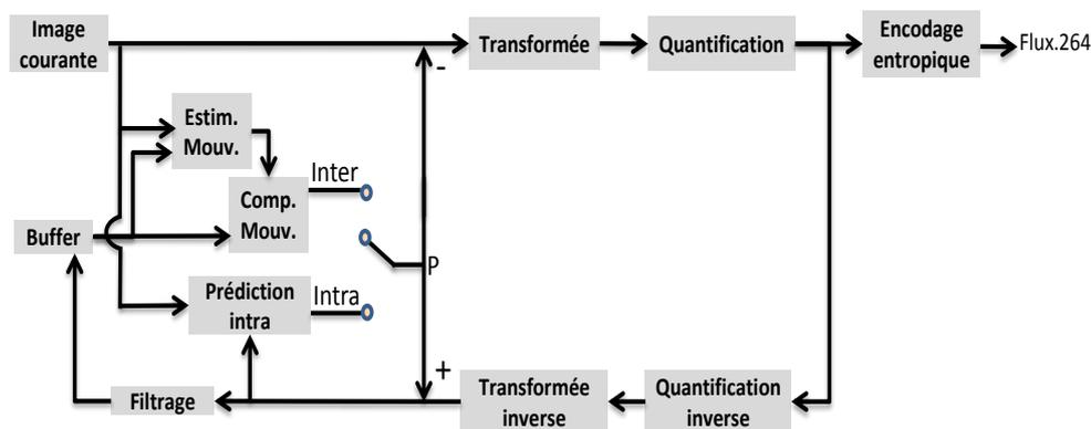
Figure 4.1 – Le schéma en blocs simplifié d'un encodeur H.264/AVC
