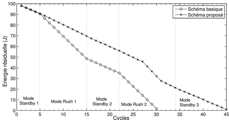
Figure 6.3 – Énergie consommée au niveau du nœud vidéo source pour encoder puis transmettre le flux vidéo
