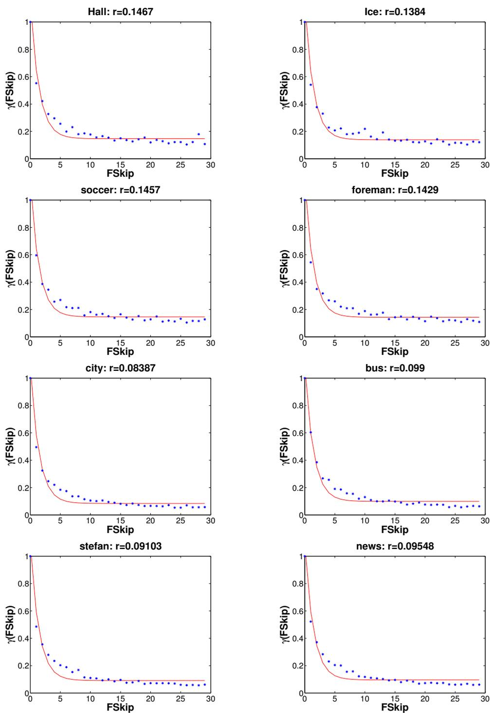
Figure 5.11 – Evolution des coefficients  $\gamma(FSkip)$  mesurés et prédits pour l'encodage en fonction du paramètre  $FSkip$
