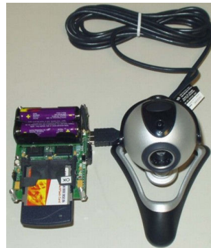
Figure 1.11 – Carte Stargate interfacée avec une webcam de résolution moyenne. Stargate intègre une carte 802.11 et un nœud MICAZ qui fonctionne comme une passerelle vers le réseau de capteurs.
