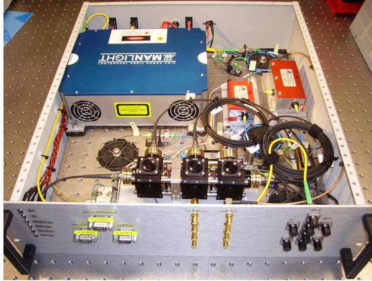
FIGURE II.16 – Photo du banc laser entièrement fibré.
