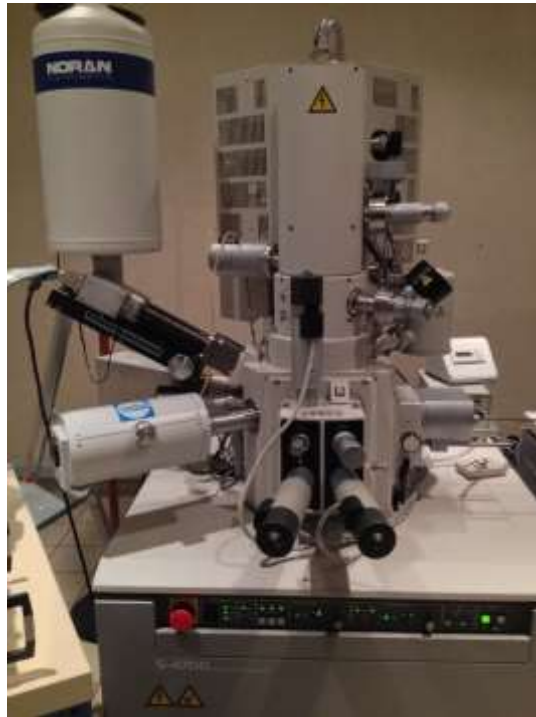
Figure 36. Microscope électronique à balayage FEG-SEM S-4700 (Hitachi) utilisé au cours de l'étude. Il permet d'obtenir des images de très haute résolution et effectue des analyses par dispersion d'énergie (SDE) pour les éléments chimiques.
