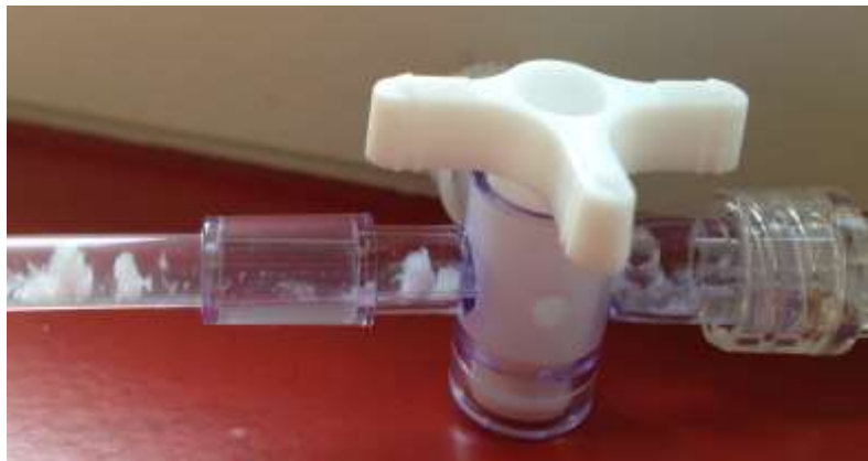
Figure 58. Précipitation au sortir du montage lorsque la vancomycine est concentrée (41,67 mg/mL).
