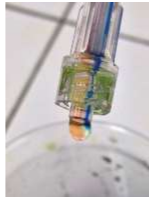
Figure 54. Distribution des flux colorés au sein du robinet 3 voies du montage de perfusion (à gauche). Photographie d'une goutte sortant du prolongateur multi-lumières (à droite).
