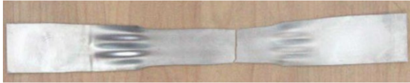
Figure 3.19 – Apparition de plissement lors d'un essai de traction. Source : Vollertsen et al. [78].
