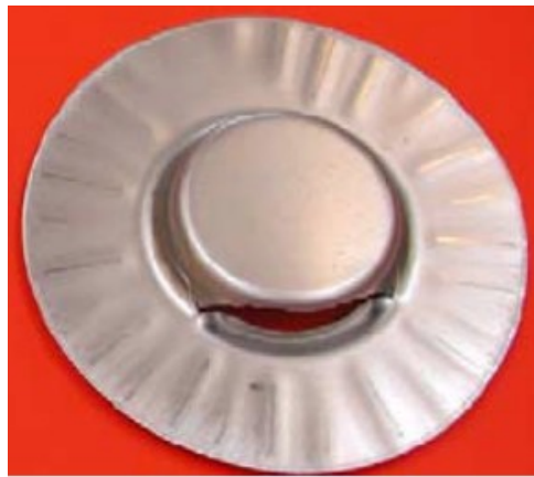
Figure 3.18 – Apparition de plissement lors d'une mise en forme d'emboutissage de type godet. Source : Lang et al. [42].
