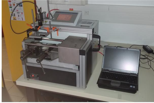
Figure 3.2 – Machine de caractérisation portable pour ligne de production.
