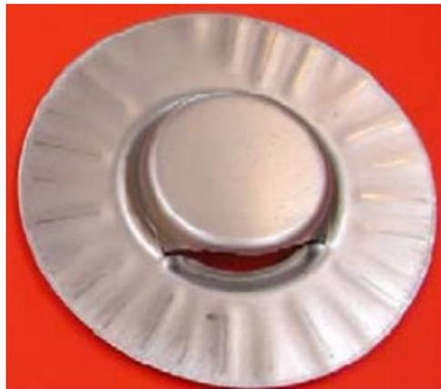
Figure 3.18 – Apparition de plissement lors d'une mise en forme d'emboutissage de type godet. Source : Lang *et al.* [42].
