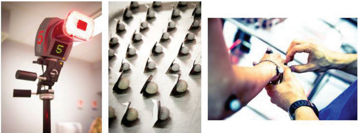
Figure 19 : Matériel de mesure optoélectronique. L'une des 8 caméras (à gauche) utilisées pour capturer, en trois dimensions, les trajectoires des marqueurs réfléchissants passifs (au centre) positionnés à l'aide d'une technique de palpation et collés à même la peau sur le sujet par l'expérimentateur (à droite).
