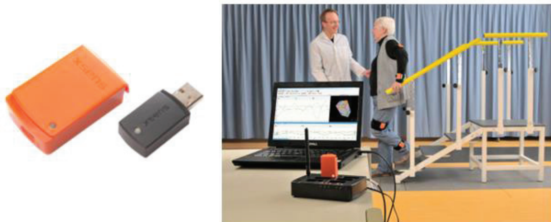
Figure 17 : Images commerciales (source : https://www.xsens.com ) illustrant l'utilisation des centrales inertielles pour l'analyse du mouvement. À gauche une centrale inertielle est représentée par le boîtier orange.
