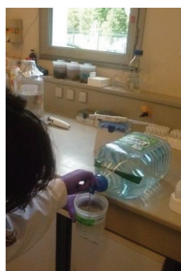
B : Renouvellement de la solution d'exposition du microcosme.
