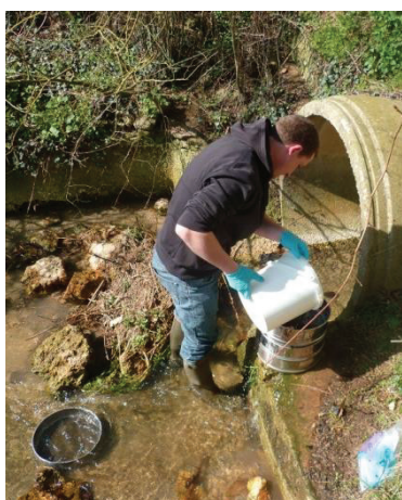
C : Tri des gammares à l'aide d'une série de tamis.
