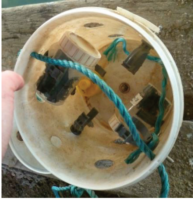
C : Seau lesté et ajouré contenant des systèmes à gammars.
