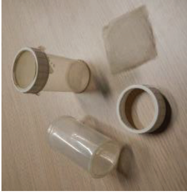
A : Éléments constituant le système destiné à recevoir les gammars (photo : J.P. Besse).
