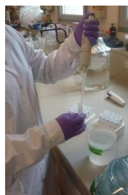
C : Prélèvement de la solution d'exposition pour mesure des métaux.
