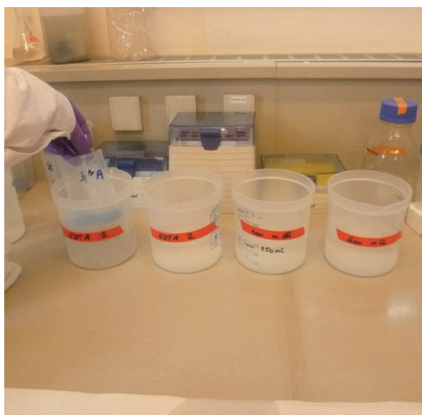
C : Bains successifs à l'EDTA puis d'eau ultra pure.
