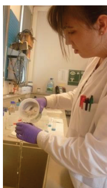
A : Vidange du microcosme et récupération des gammares dans un filet.
