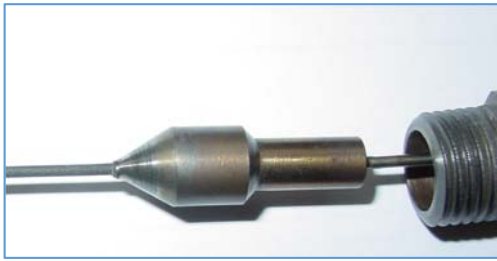
Fig. A.2. Le cône du thermocouple chromel/alumel fabriqué par l'entreprise TOP Industrie.
