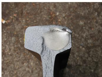
FIGURE 5.2 – Fissure interne ayant conduit à la rupture
