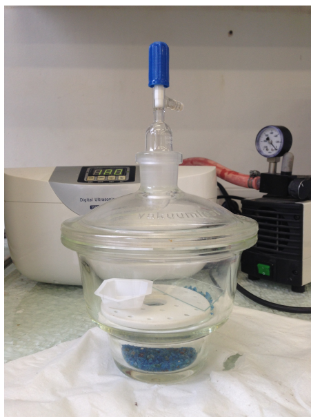
FIGURE I.7 – Silanisation d'une lame de verre dans un dessiccateur.
