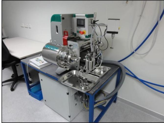
**Figure II. 15 : Broyeur à attrition NETZSCH Minipur**
