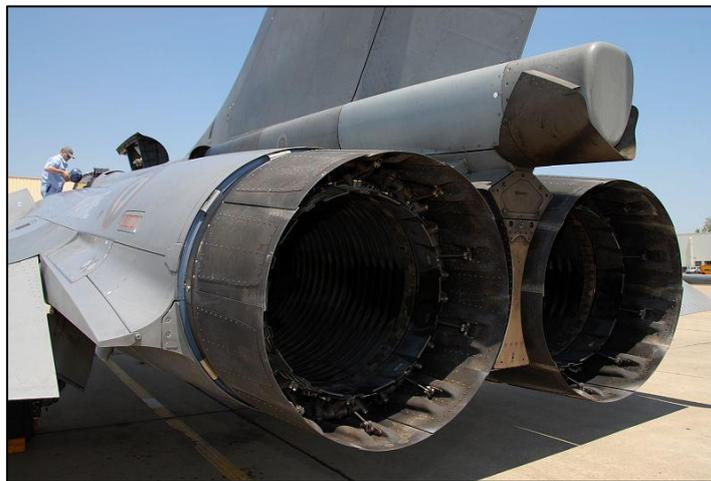
**Figure I. 21 : Moteurs M88 du rafale, équipés de ses volets en C/SiC**
