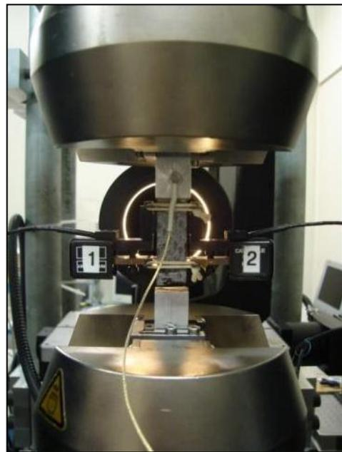
**Figure II. 6 : Machine de traction Instron 4505**
