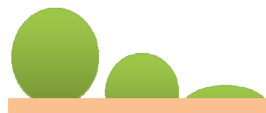
Figure II-7 : Phénomène de mouillabilité d'une surface
