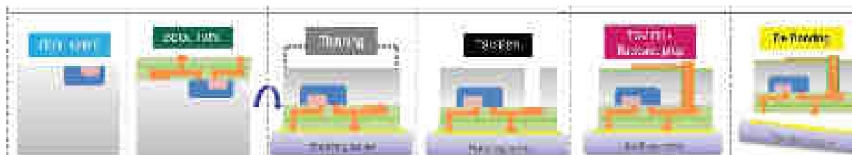
Figure I-26: Schéma d'élaboration d'un via last
