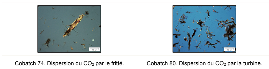
Figure V-12. Clichés de microscopie optique des cristaux obtenus par GAS. Barre d'échelle 100 \mu\text{m} .
