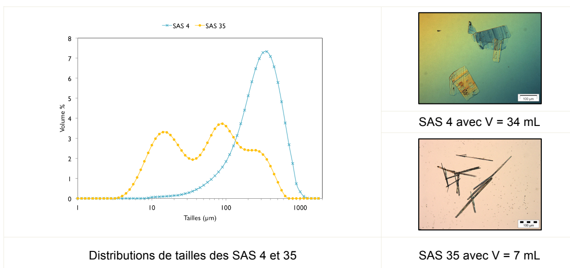
Figure III-31. Caractérisation des tailles et des morphologies des poudres SAS produites avec différents volumes de solution injectés. Barre d'échelle 100 \mu\text{m} .
