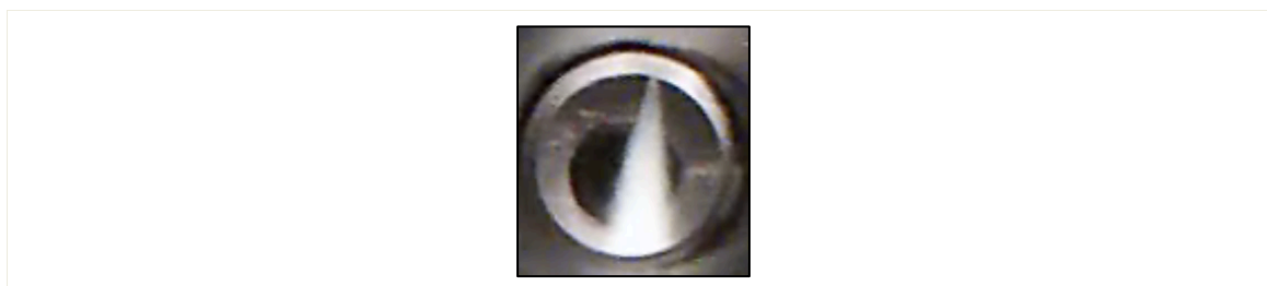
Figure III-21. Photo du jet de solution injectée dans le réacteur SAS lors du SAS 4, à 37 \pm 1^\circ\text{C} , 10.1 MPa. Débit imposé du \text{CO}_2 , \text{ICO}_2 = 56 \text{ g/min} , débit d'injection de la solution, \text{I}_{\text{sol}} = 6 \text{ mL/min} , composition globale du mélange solution- \text{CO}_2 x\text{CO}_2 = 93\% \text{ mol } \text{CO}_2 . Vitesse d'injection de la solution v_{\text{sol}} = 4.5 \text{ m/s} .
