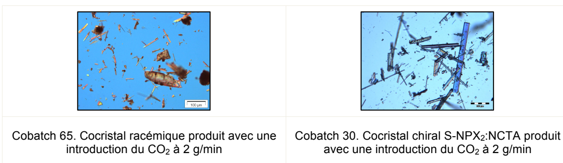
Figure IV-5. Clichés de microscopie optique des cocristaux de RS-NPX:NCTA recristallisé par GAS. Barre d'échelle 100 µm.
