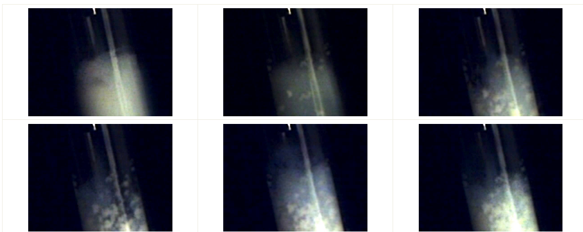
Figure III-38. Séquence de plans de l'injection de la solution, test Saphir 1. Les images sont prélevées au début de l'injection de la solution sur une durée totale de 1 min, l'injection complète de la solution s'étalant sur 2 min. L'extrémité du capillaire visible en haut de l'image mesure environ 3 mm de long.
