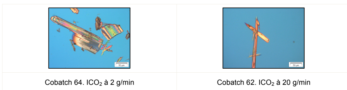
Figure IV-3. Clichés de microscopie optique du RS-NPX recristallisé par GAS à partir de solutions dans l'acétone. Barre d'échelle 50 µm.
