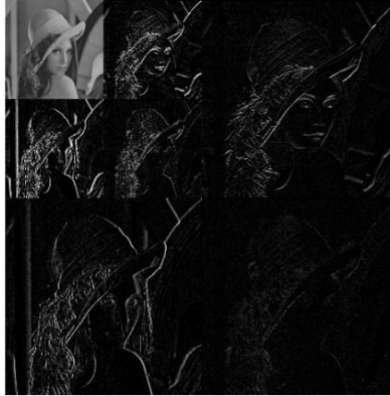
Figure 1.4 : Décomposition par la transformée en ondelettes de l'image Lena.
