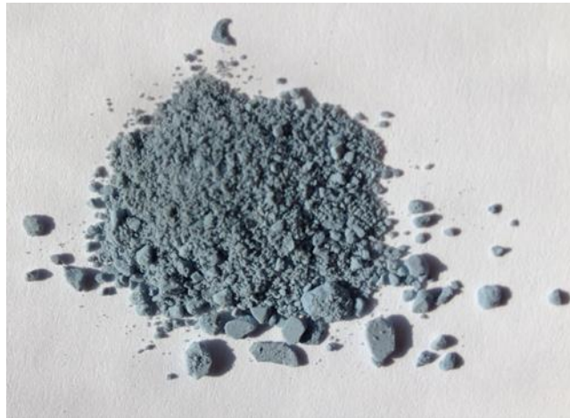
Figure III.3 : Apparence d'une poudre typique de TiO 2 modifiée avec des particules d'or après recuit
