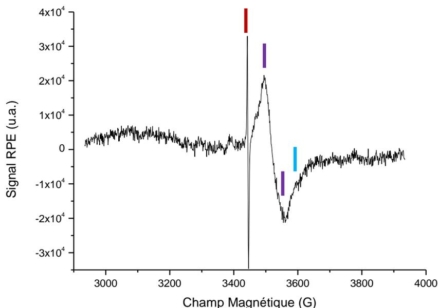
**Figure 1 : Spectre RPE de la poudre 0,16-Au/TiO<sub>2</sub> pure sans irradiation**
