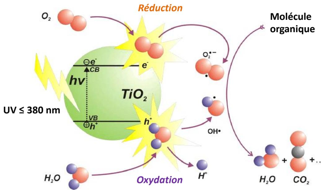
Figure I.14 : Schéma illustrant le principe de la photocatalyse
