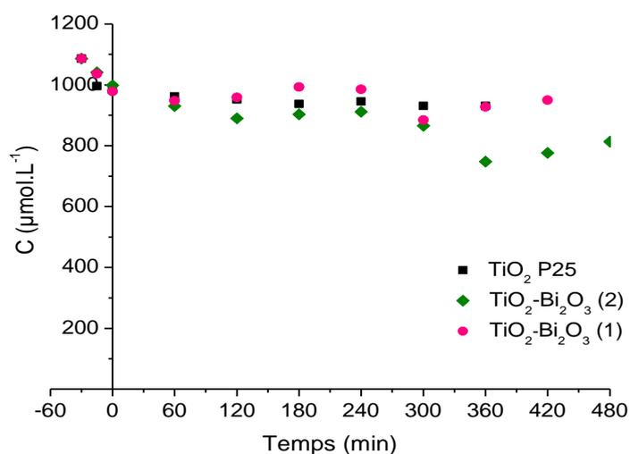
**Figure 11 : Suivi de la concentration en acide formique sous lumière visible en présence des poudres TiO<sub>2</sub> P25, TiO<sub>2</sub>-Bi<sub>2</sub>O<sub>3</sub> (1) et TiO<sub>2</sub>-Bi<sub>2</sub>O<sub>3</sub> (2)**
