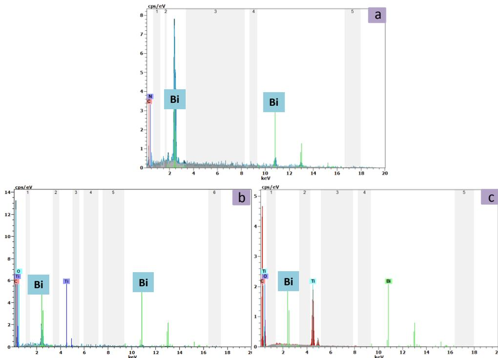
**Figure 3 : Cartographies EDX de la poudre (a)  $\text{Bi}_2\text{O}_3$  PL et des poudres  $\text{TiO}_2$  modifiées (b)  $\text{TiO}_2\text{-Bi}_2\text{O}_3$  (1) et (c)  $\text{TiO}_2\text{-Bi}_2\text{O}_3$  (2)**
