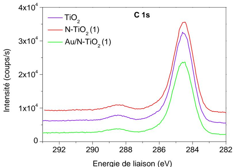
**Figure III.17 : Spectre XPS du niveau de cœur du carbone C 1s des poudres TiO<sub>2</sub>, N-TiO<sub>2</sub> (1) et Au/N-TiO<sub>2</sub> (1)**
