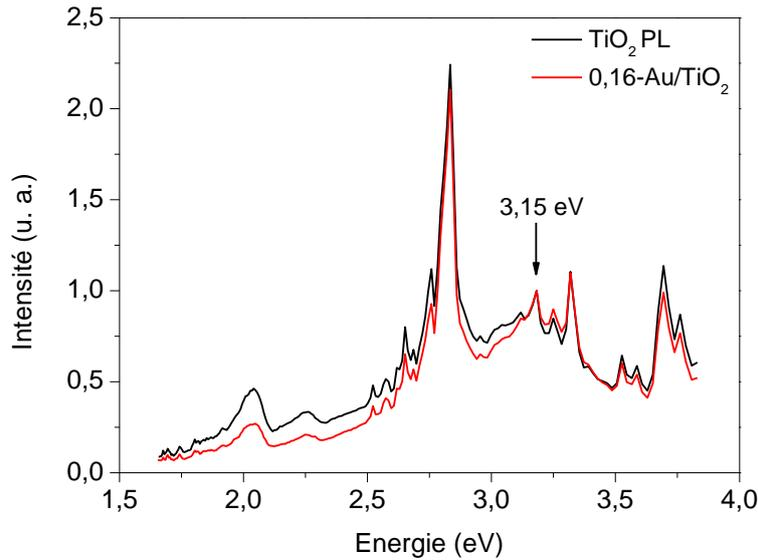
**Figure IV.12 : Spectres d'émission de photoluminescence, normalisés à 3,15 eV des poudres TiO<sub>2</sub> PL et 0,16-Au/TiO<sub>2</sub>**
