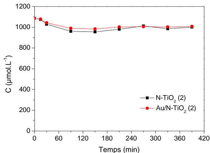
**Figure IV.17 : Evolution de la concentration de l'acide acétique en présence des poudres N-TiO<sub>2</sub> (2) et Au/N-TiO<sub>2</sub> (2) en absence de lumière (adsorption)**
