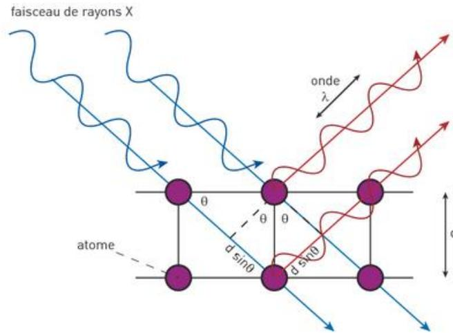
**Figure II.12 : Principe de la diffraction des rayons X**
