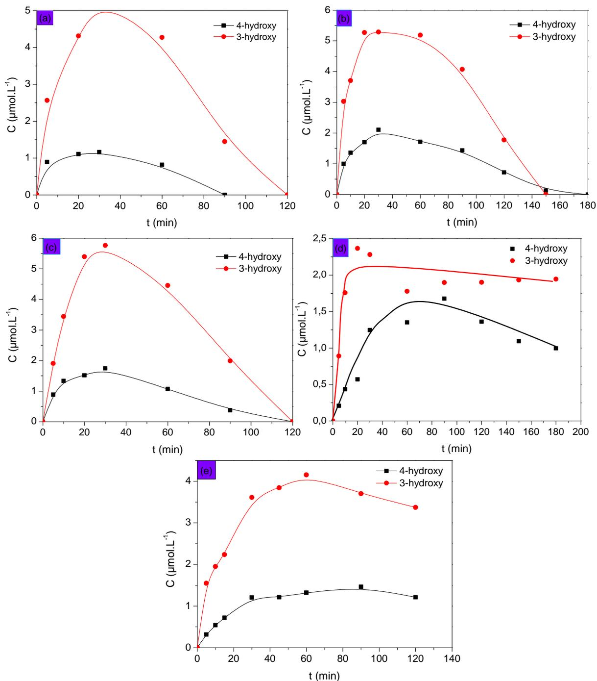
**Figure IV.28 : Suivi de l'évolution des acides 3,4-hydroxybenzoïque en fonction du temps d'irradiation UV en présence des poudres (a)  $\text{TiO}_2$  P25, (b)  $\text{TiO}_2$  PL, (c)  $\text{Au/TiO}_2(2)$ , (d)  $\text{Au/N-TiO}_2(2)$  et (e)  $\text{N-TiO}_2(2)$**
