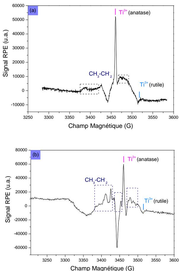
**Figure IV.23 : Spectres de RPE des poudres (a) Au/TiO<sub>2</sub> et (b) N-TiO<sub>2</sub> avec l'acide propionique sous irradiation à 365 nm à 77K**
