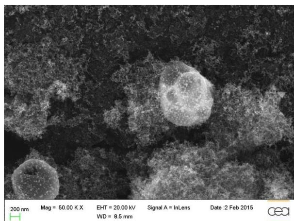
**Figure II.11 : Exemple de cliché MEB obtenue sur une poudre Au/TiO<sub>2</sub>**
