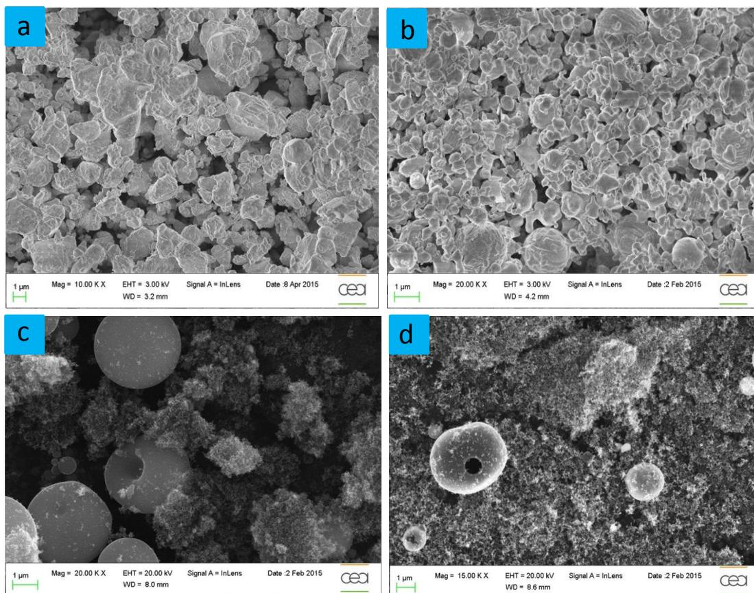
**Figure 2 : Clichés MEB des poudres (a)  $\text{Bi}_2\text{O}_3$  commerciale, (b)  $\text{Bi}_2\text{O}_3$  PL, et des poudres de  $\text{TiO}_2$  modifiées (c)  $\text{TiO}_2\text{-Bi}_2\text{O}_3$  (2) et (d)  $\text{TiO}_2\text{-Bi}_2\text{O}_3$  (1)**
