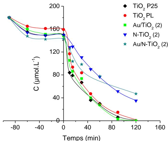
**Figure IV.26 : Suivi de la concentration de l'acide benzoïque sous irradiation UV en présence des poudres TiO<sub>2</sub> P25, TiO<sub>2</sub> PL, Au/TiO<sub>2</sub> (2), N-TiO<sub>2</sub> (2) et Au/N-TiO<sub>2</sub> (2)**
