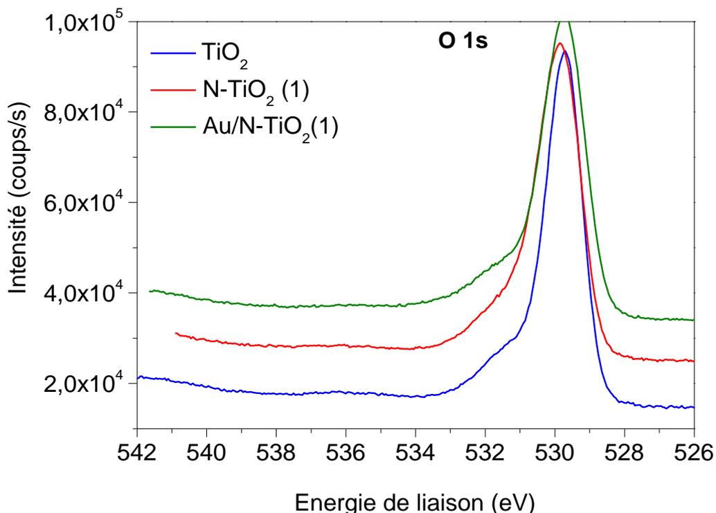
**Figure III.19 : Spectre XPS du niveau de cœur O 1s des poudres TiO<sub>2</sub>, N-TiO<sub>2</sub> (1) et Au/N-TiO<sub>2</sub> (1)**
