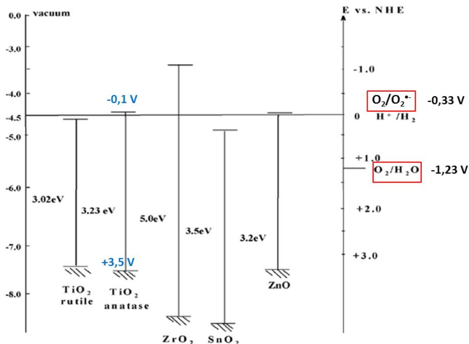
**Figure I.16 : Position des bande interdite du  $TiO_2$  et le potentiel rédox des couples  $O_2/H_2O$  et  $O_2/O_2^{\bullet -}$  [123]**
