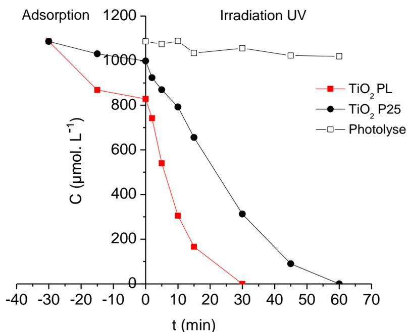
**Figure IV.7 : Suivi de la concentration de l'acide formique sous irradiation UV en fonction du temps et photolyse en présence de TiO<sub>2</sub> PL et TiO<sub>2</sub> P25**
