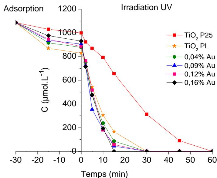
**Figure IV.9 : Suivi de la concentration de l'acide formique sous irradiation UV en présence des poudres Au/TiO<sub>2</sub>**
