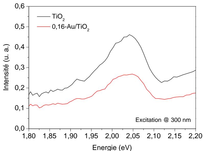
**Figure IV.13 : Spectres de photoluminescence des poudres TiO<sub>2</sub> PL et 0,16-Au/TiO<sub>2</sub> zoomés autour du pic à 2,04 eV (mesures absolues)**
