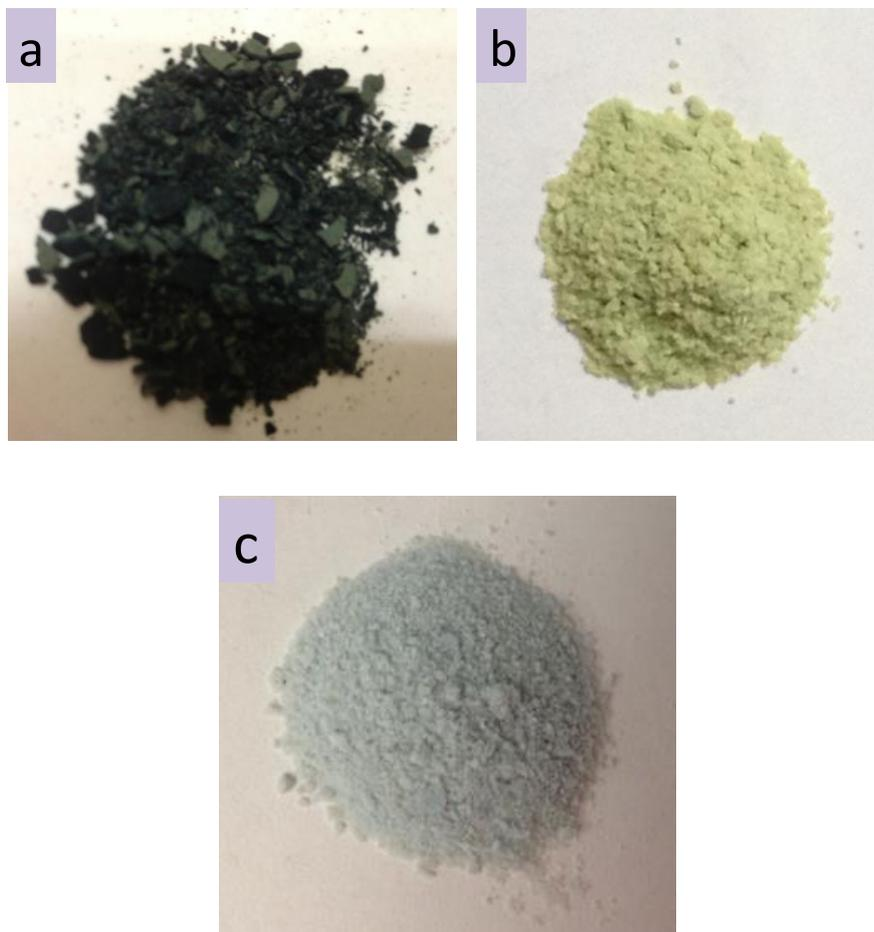
**Figure III.13 : Evolution de la couleur de la poudre N-TiO<sub>2</sub> avant (a) et après recuit (b), poudre typique Au/N-TiO<sub>2</sub> après recuit (c)**
