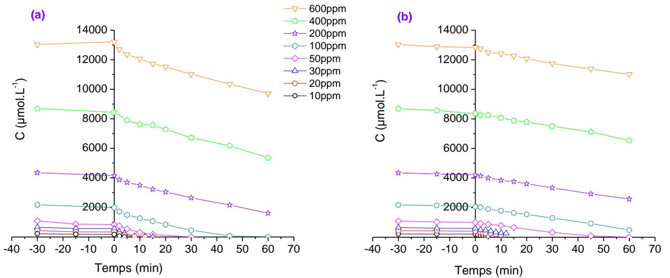
**Figure IV.3 : Suivi de la dégradation de l'acide formique à différentes concentrations en présence de la poudre (a)  $\text{TiO}_2$  PL et (b)  $\text{TiO}_2$  P25 ( $\phi = 4,2 \text{ mW}/\text{cm}^2$ )**
