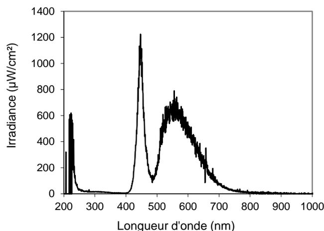
**Figure II.17 : Spectre d'émission de la lampe LED visible**
