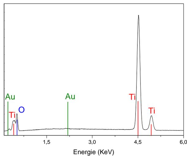
**Figure III.8 : Spectre EDX d'une poudre typique Au/TiO<sub>2</sub>**
