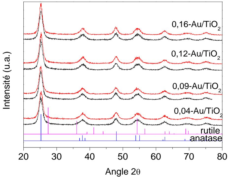
**Figure III.10 : Diffractogrammes des poudres Au/TiO<sub>2</sub> brutes en noir et recuites en rouge**
