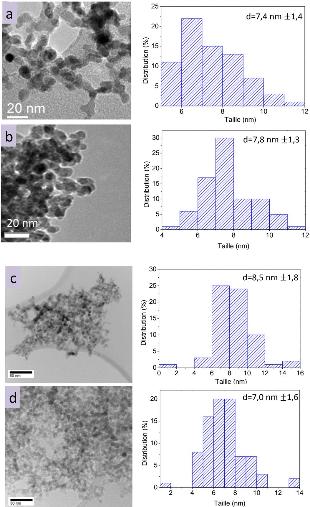
**Figure III.5 : Clichés MET et distribution en taille des différentes poudres Au/TiO<sub>2</sub> : (a) 0,04-Au/TiO<sub>2</sub>, (b) 0,09-Au/TiO<sub>2</sub>, (c) 0,12-Au/TiO<sub>2</sub> et (d) 0,16-Au/TiO<sub>2</sub>**
