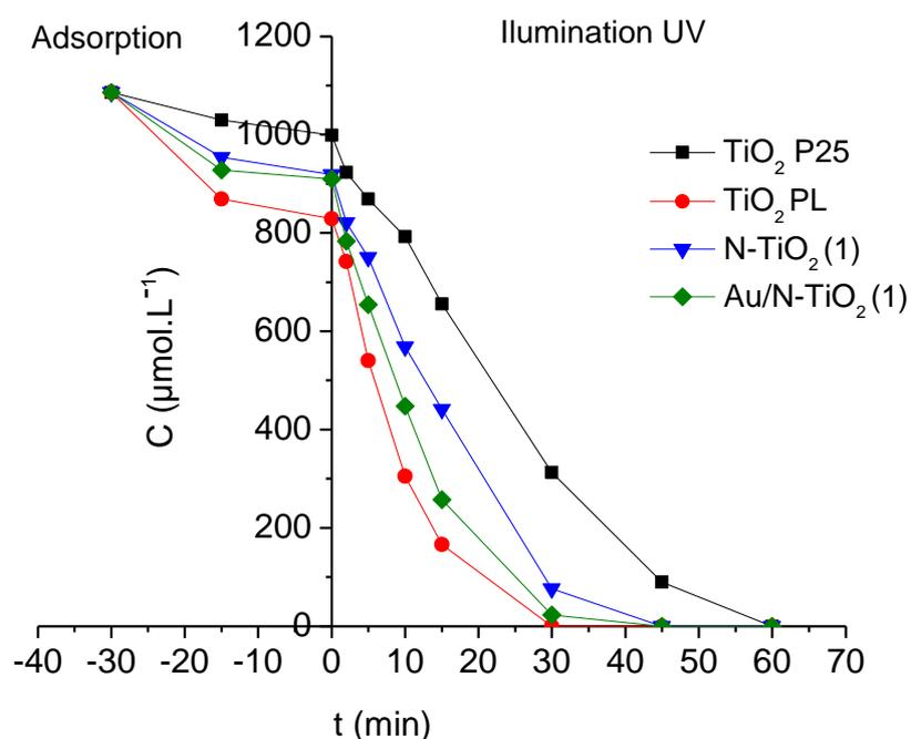
**Figure IV.14 : Suivi de la concentration de l'acide formique en fonction du temps d'irradiation UV en présence des poudres TiO<sub>2</sub> P25, TiO<sub>2</sub> PL, N-TiO<sub>2</sub> (1) et Au/N-TiO<sub>2</sub> (1)**
