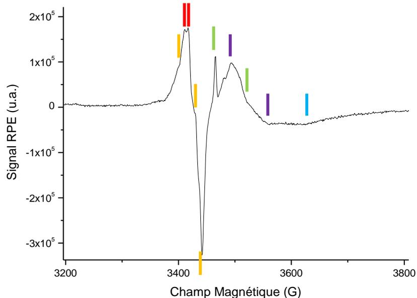
**Figure 2 : Spectre RPE de la poudre 0,16-Au/TiO<sub>2</sub> pure éclairée in-situ**
