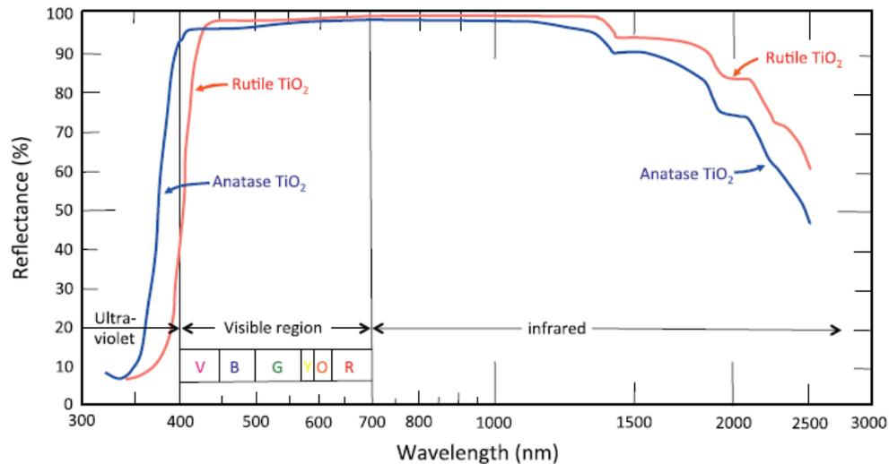
**Figure 1.4 : Spectre de réflectance du  $\text{TiO}_2$  [2]**
