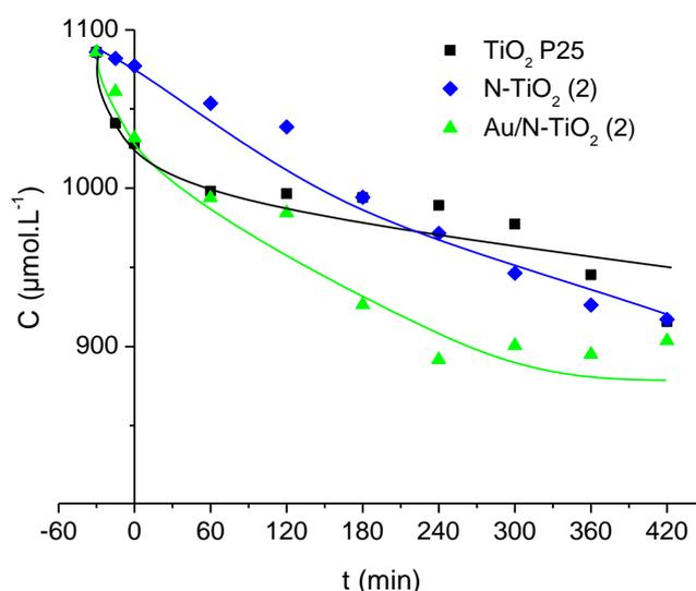
**Figure IV.24 : Suivi de la concentration de l'acide propionique sous irradiation visible en présence des poudres TiO<sub>2</sub> P25, N-TiO<sub>2</sub> (2) et Au/N-TiO<sub>2</sub> (2)**
