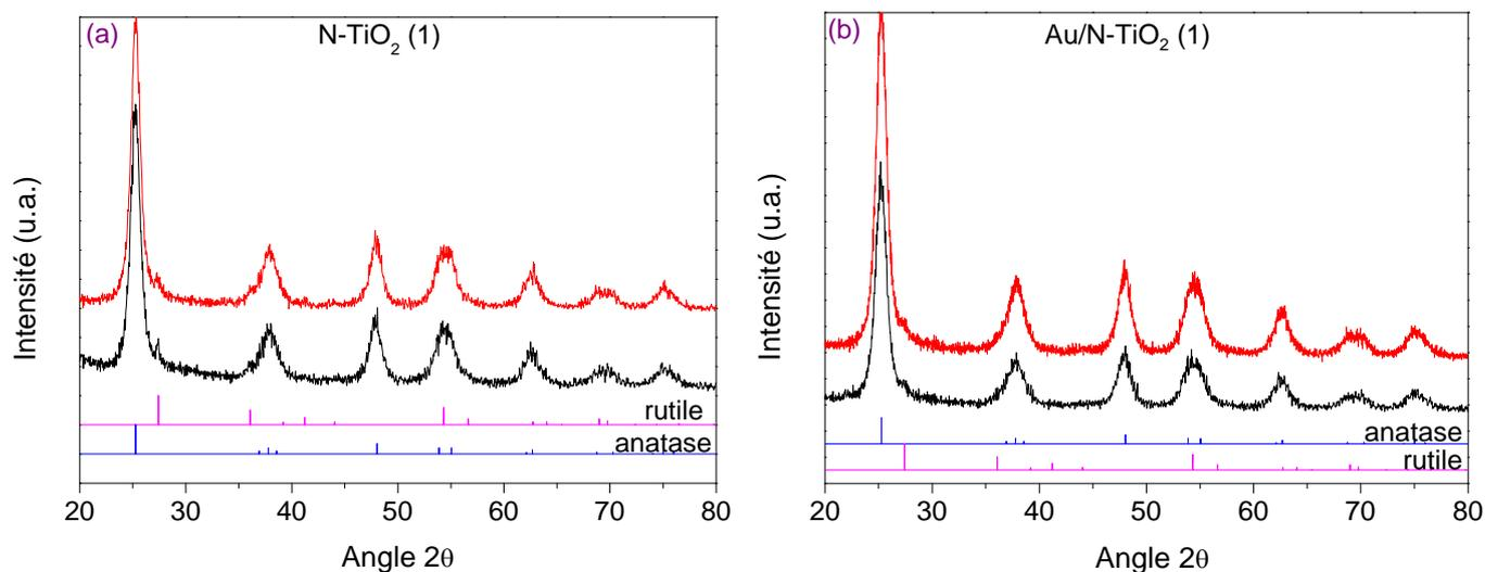
**Figure III.15 : Diffractogrammes des poudres (a) N-TiO<sub>2</sub> (1) et (b) Au/N-TiO<sub>2</sub> (1) brutes en noir et recuites en rouge**
