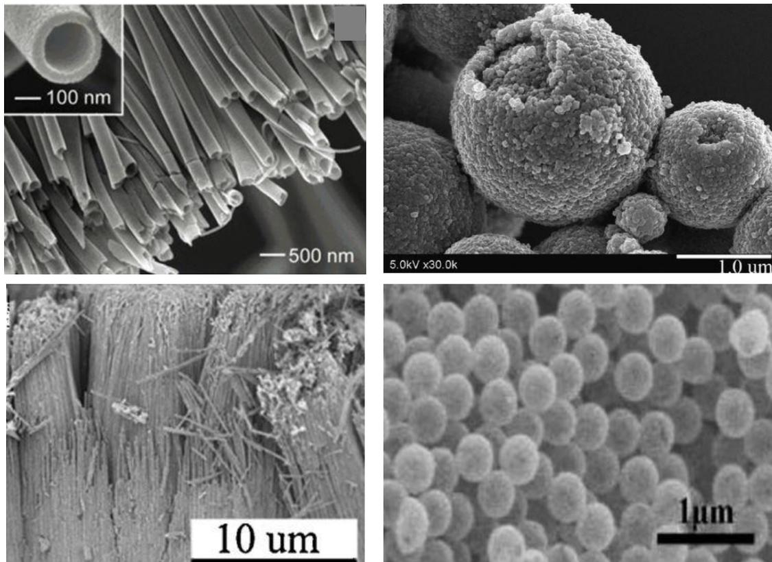
**Figure I.6 : Différentes morphologies du  $TiO_2$  [24]**
