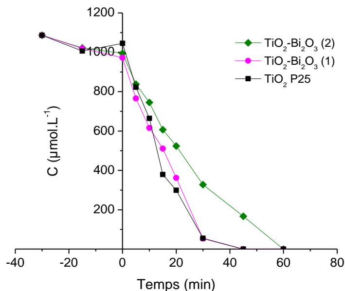
**Figure 10 : Suivi de la concentration de l'acide formique en fonction du temps d'irradiation UV en présence de poudres : TiO<sub>2</sub> P25, TiO<sub>2</sub>-Bi<sub>2</sub>O<sub>3</sub> (1) et (2)**
