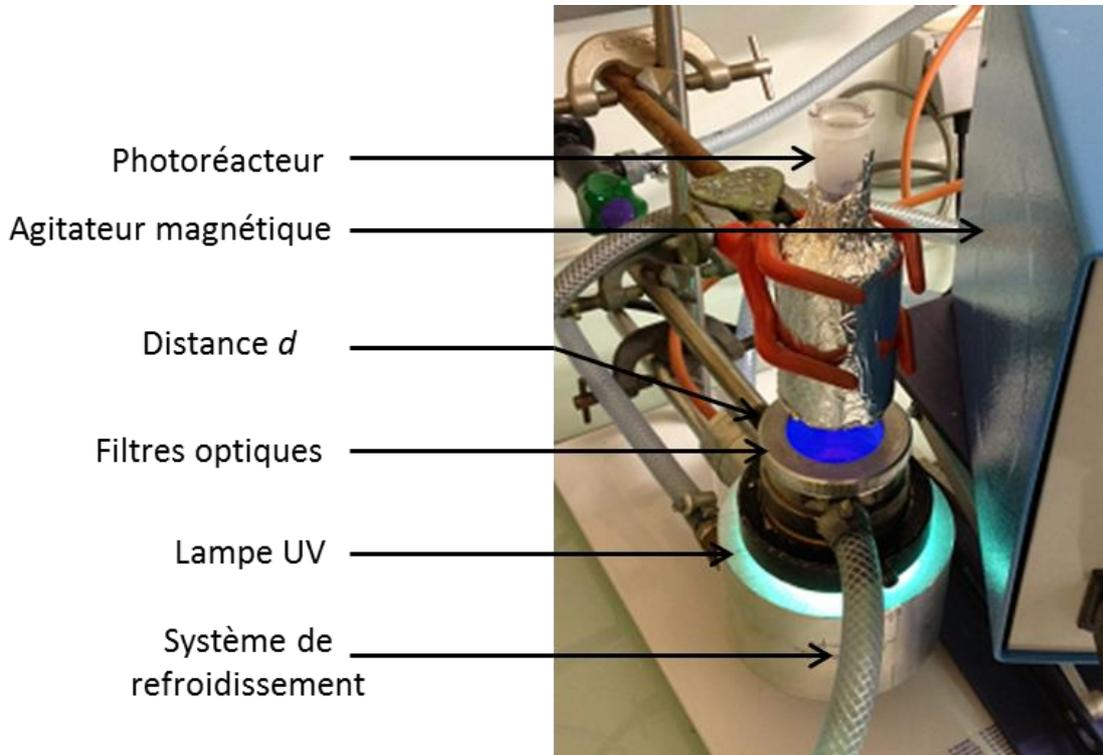
**Figure II.16 : Dispositif expérimental du test photocatalytique en milieux aqueux**
