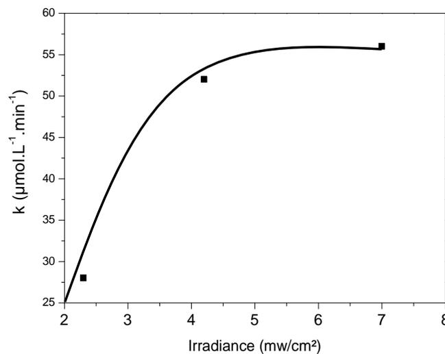
**Figure IV.6 : Constantes de vitesse de dégradation de l'acide formique en fonction de l'irradiance**
