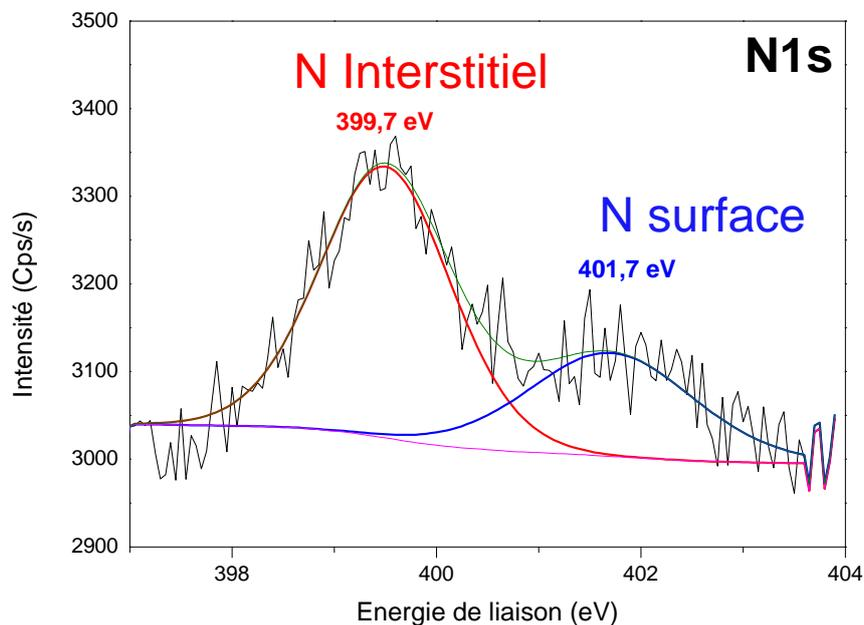
**Figure III.20 : Spectre XPS du niveau de cœur N 1s des poudres N-TiO<sub>2</sub> (1) et Au/N-TiO<sub>2</sub> (1)**
