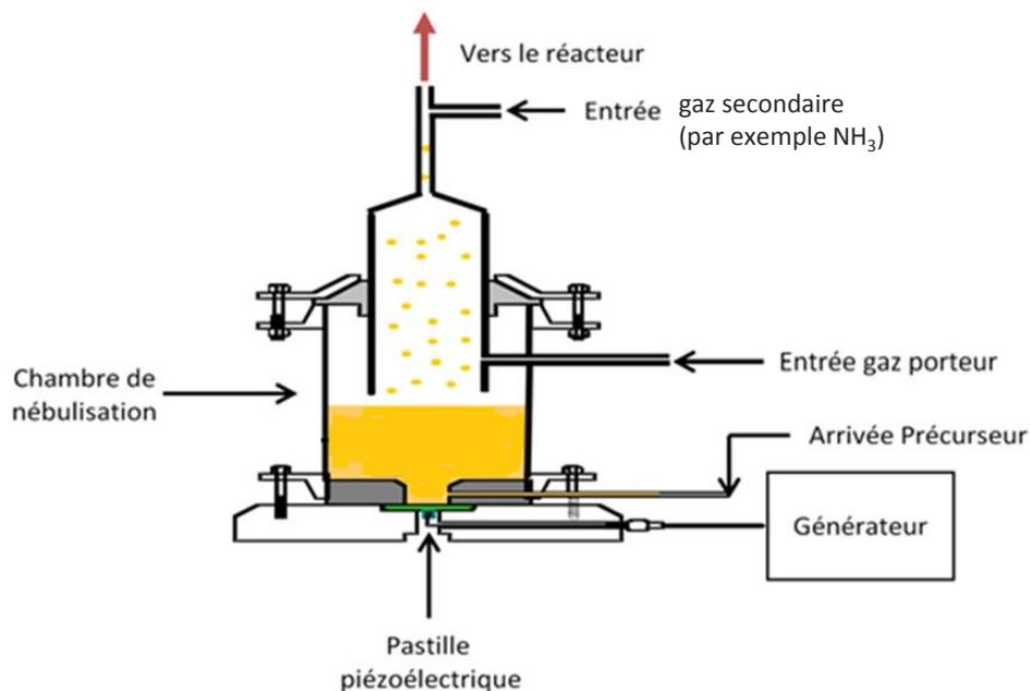
**Figure II.3 : Schéma du système d'injection : pyrosol**
