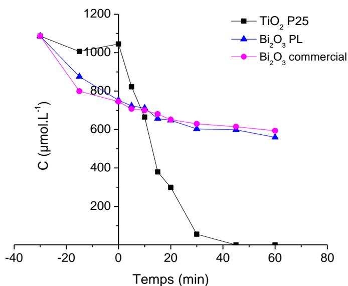
**Figure 8 : Suivi de la concentration de l'acide formique en fonction du temps d'irradiation UV en présence de poudres :  $\text{TiO}_2$  P25,  $\text{Bi}_2\text{O}_3$  PL et  $\text{Bi}_2\text{O}_3$  commerciale**
