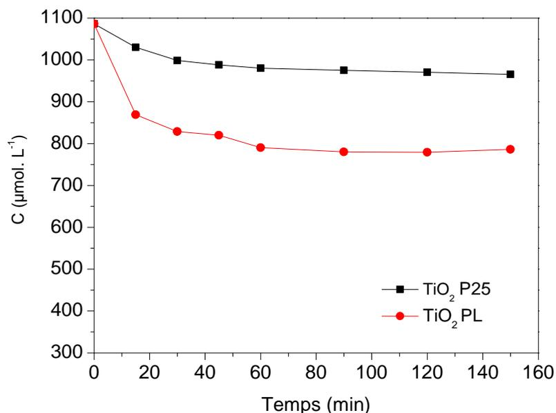
**Figure IV.1: Evolution de la concentration de l'acide formique en absence d'irradiation en fonction du temps, en présence des photocatalyseurs TiO<sub>2</sub> PL et TiO<sub>2</sub> P25**
