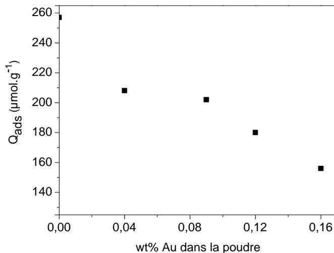
**Figure IV.8 : Quantité d'acide formique adsorbée en fonction de la teneur en or\***
