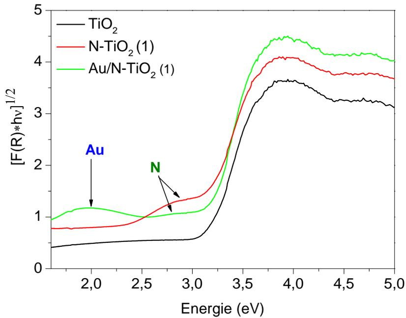
**Figure III.21 : Spectres d'absorption des poudres N-TiO<sub>2</sub> (1) et Au/N-TiO<sub>2</sub> (1)**
