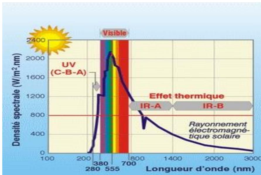
Figure I.8 : Spectre de l'énergie solaire reçue sur terre
