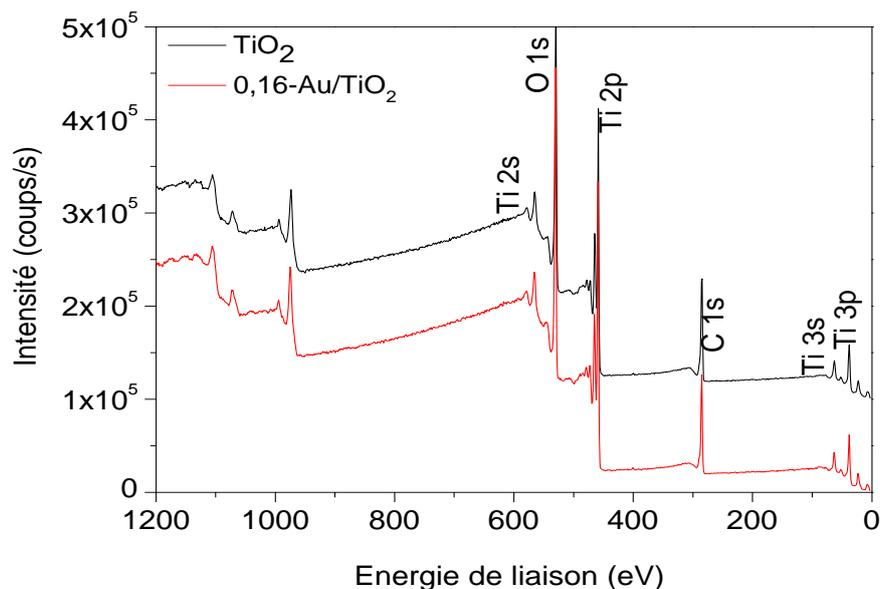
**Figure III.11 : Superposition des spectres XPS complets des poudres TiO<sub>2</sub> et 0,16 Au/TiO<sub>2</sub>**
