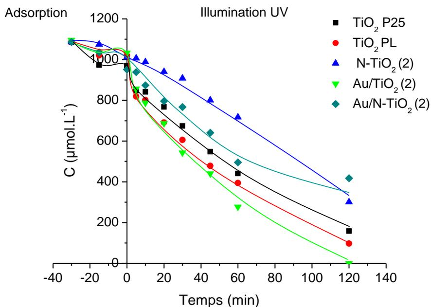
**Figure IV.21 : Suivi de la concentration de l'acide propionique en présence des poudres TiO<sub>2</sub> P25, TiO<sub>2</sub>, Au/TiO<sub>2</sub>, N-TiO<sub>2</sub> (2) et Au/N-TiO<sub>2</sub> (2) en fonction du temps d'irradiation UV**
