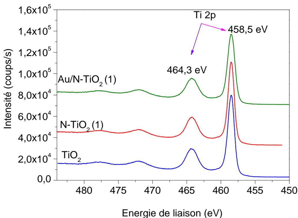
**Figure III.18 : Spectre XPS du niveau de cœur Ti 2p des poudres TiO<sub>2</sub>, N-TiO<sub>2</sub> (1) et Au/ N-TiO<sub>2</sub> (1)**
