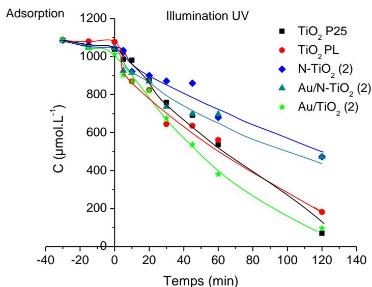
**Figure IV.18 : Suivi de la concentration de l'acide acétique en présence des poudres TiO<sub>2</sub> P25, TiO<sub>2</sub> PL, Au/TiO<sub>2</sub> (2), N-TiO<sub>2</sub> (2) et Au/N-TiO<sub>2</sub> (2) en fonction du temps d'irradiation UV**
