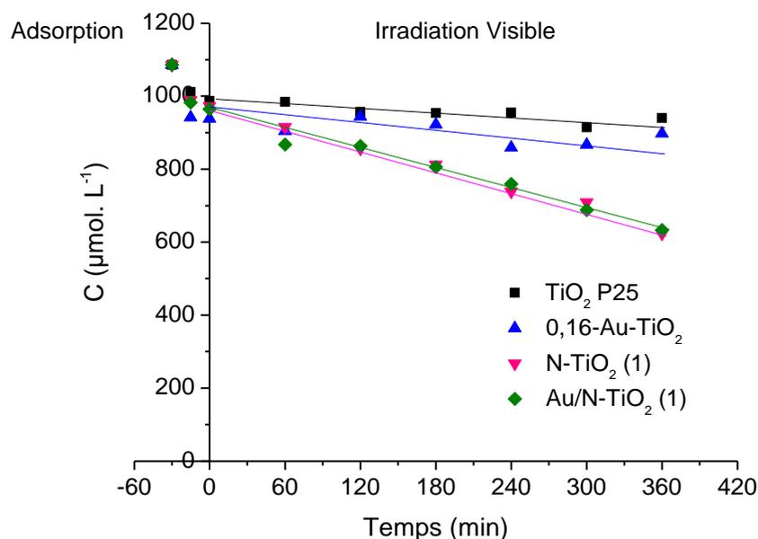
**Figure IV.15 : Suivi de la concentration de l'acide formique sous irradiation visible en présence des poudres TiO<sub>2</sub> P25, 0,16-Au/TiO<sub>2</sub>, N-TiO<sub>2</sub> (1) et Au/N-TiO<sub>2</sub> (1)**
