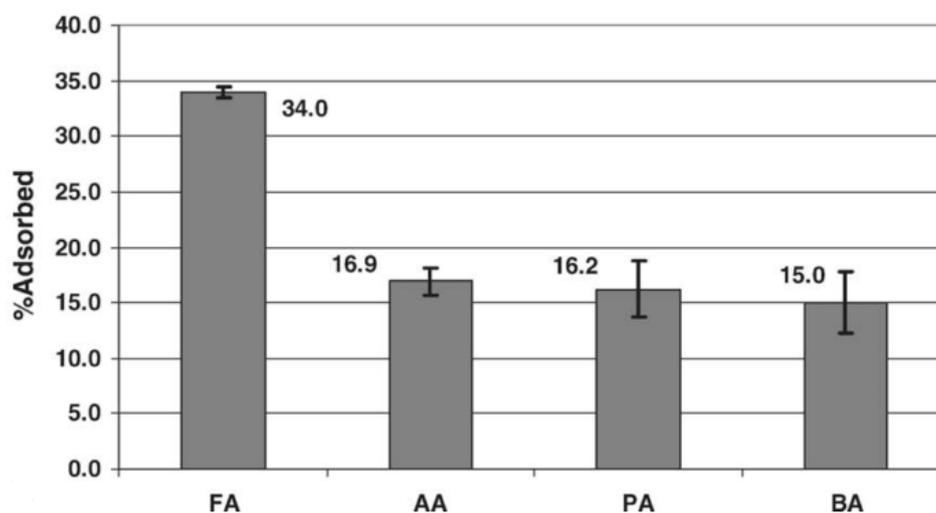
**Figure I.21 : Adsorption dans le noir des acides carboxyliques (C<sub>1</sub>-C<sub>4</sub>) à pH 3,7 en présence de TiO<sub>2</sub> (20 g/L) [165]**
