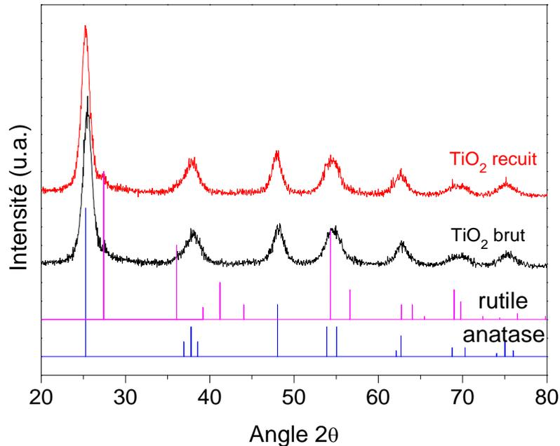
**Figure III.9 : Diffractogrammes de la poudre TiO<sub>2</sub> PL avant et après recuit**
