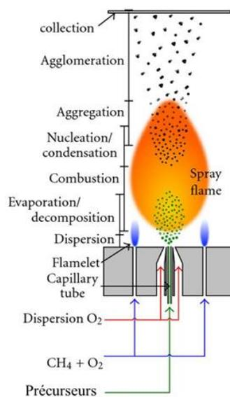
**Figure I.7 : Représentation schématique de la croissance des nanoparticules en phase gaz**
