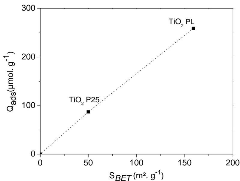
**Figure IV.2 : Quantité d'acide formique adsorbée en fonction de la surface spécifique des photocatalyseurs TiO<sub>2</sub> PL et TiO<sub>2</sub> P25**
