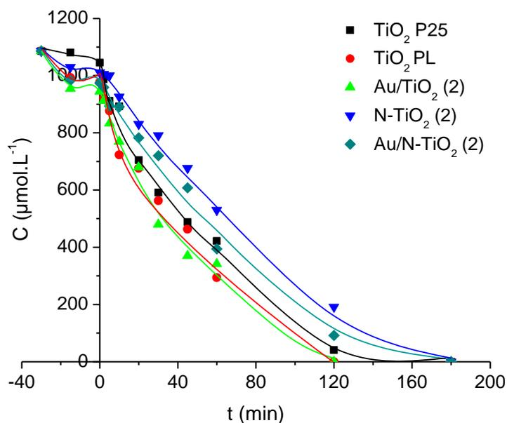
**Figure IV.25 : Suivi de la concentration de l'acide iso-butyrique sous irradiation UV en présence des poudres TiO<sub>2</sub> P25, TiO<sub>2</sub> PL, Au/TiO<sub>2</sub> (2), N-TiO<sub>2</sub> (2) et Au/N-TiO<sub>2</sub> (2)**
