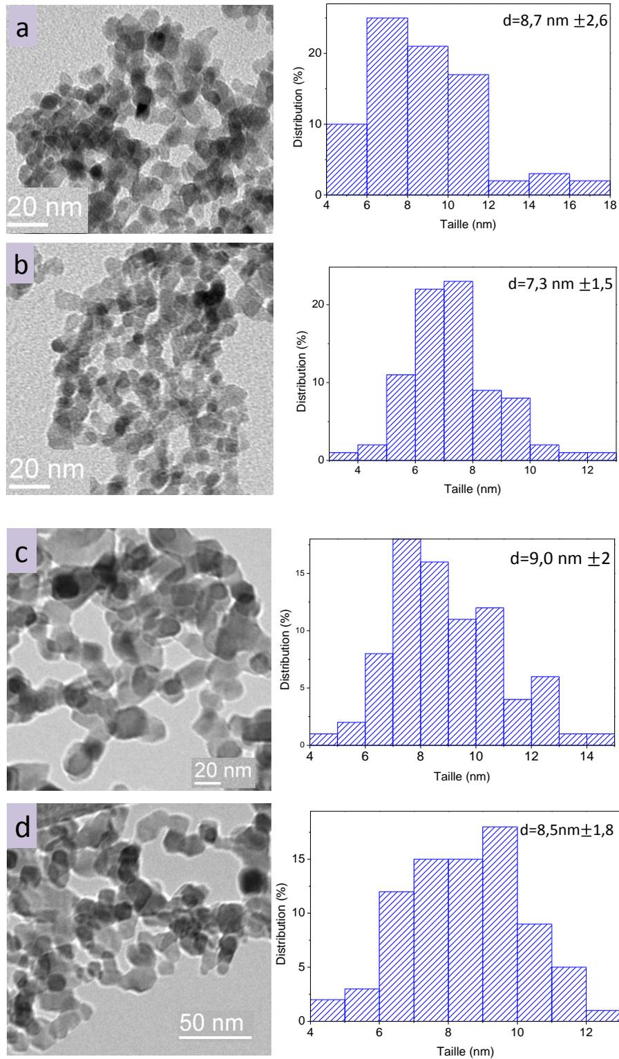
**Figure III.14: Clichés MET et distribution en taille des poudres (a) N-TiO<sub>2</sub> (1), (b) Au/N-TiO<sub>2</sub> (1), (c) N-TiO<sub>2</sub> (2) et (d) Au/N-TiO<sub>2</sub> (2)**
