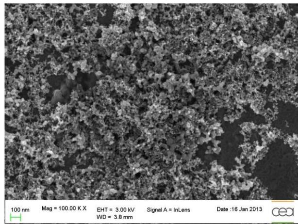
**Figure III.7 : Image MEB d'une poudre typique Au/TiO<sub>2</sub>**
