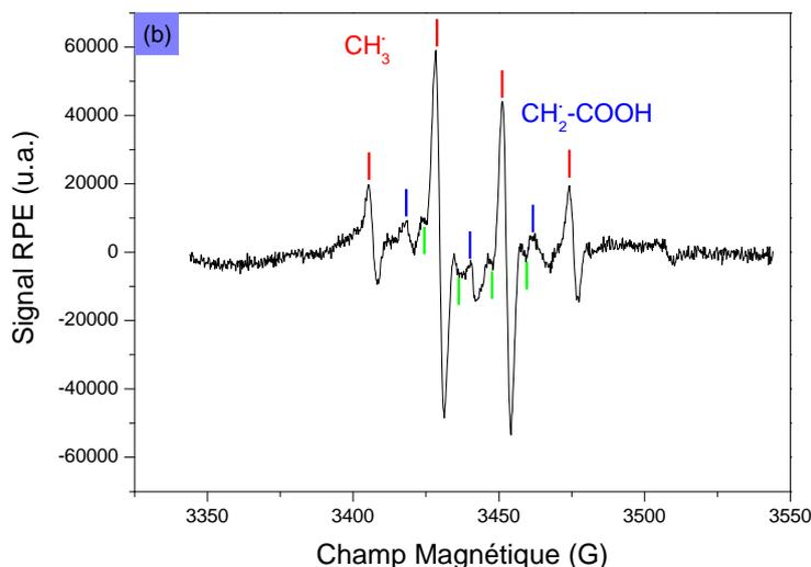
**Figure IV.19 : Spectres de RPE des poudres (a) Au/TiO<sub>2</sub> et (b) N-TiO<sub>2</sub> avec l'acide acétique sous irradiation à 365 nm à 77K**
