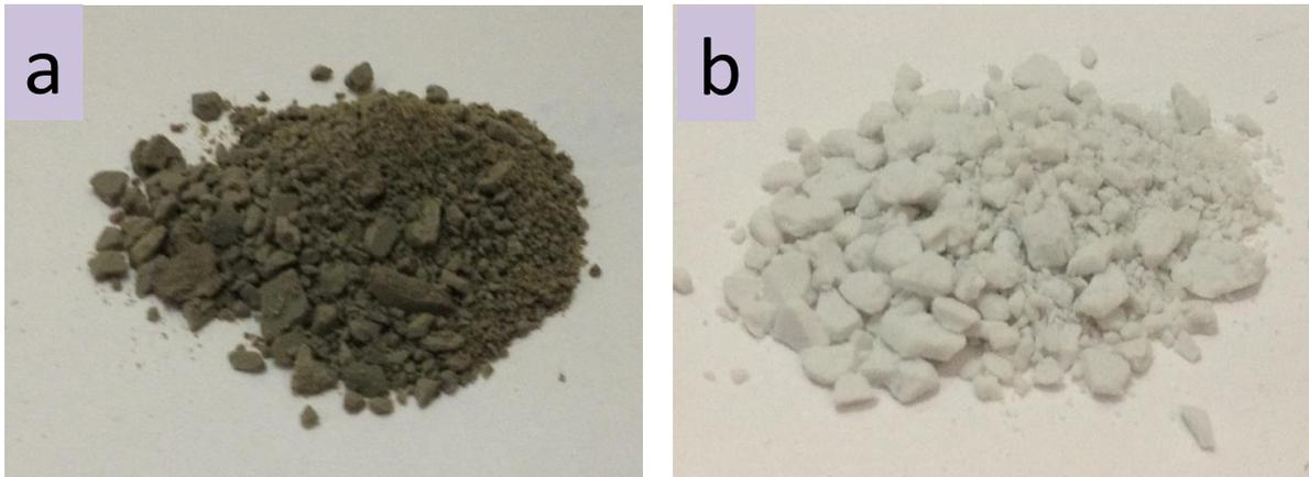
**Figure III.2 : Apparence de la poudre de TiO<sub>2</sub> avant (a) et après recuit (b)**
