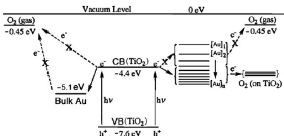
**Figure I.18 : Niveaux d'énergie des particules d'or, du TiO<sub>2</sub> ainsi que de l'O<sub>2</sub> adsorbé [161]**
