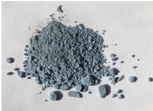
**Figure III.3 : Apparence d'une poudre typique de TiO<sub>2</sub> modifiée avec des particules d'or après recuit**
