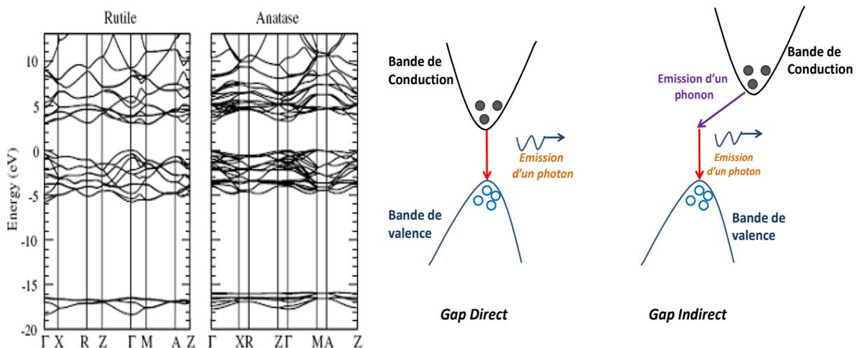
**Figure I.3 : Structure de bandes calculées du rutile et de l'anatase (gauche) et illustration des différents types de bandes interdites (droite) [9]**
