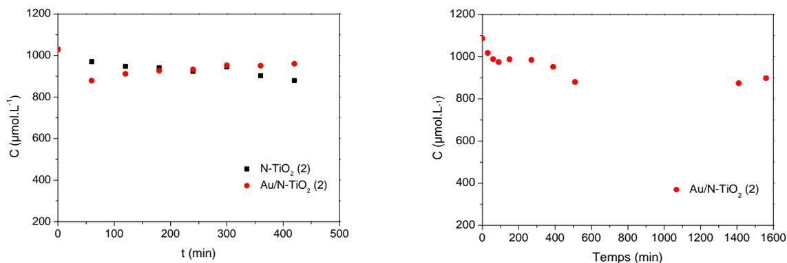
**Figure IV.20 : Suivi de l'évolution de la concentration de l'acide acétique en fonction du temps d'irradiation visible en présence des poudres (a) N-TiO<sub>2</sub> (2) et Au/N-TiO<sub>2</sub> (2) après 7h et (b) 26h d'irradiation**
