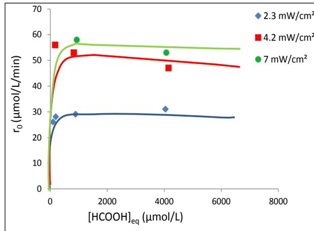
**Figure IV.5 : Evolution de la vitesse de dégradation initiale en fonction de la concentration d'acide formique en équilibre en présence de la poudre TiO<sub>2</sub> PL**
