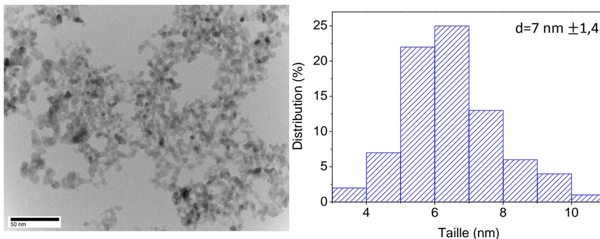
**Figure III.4 : Cliché MET et distribution en taille de la poudre TiO<sub>2</sub> PL**
