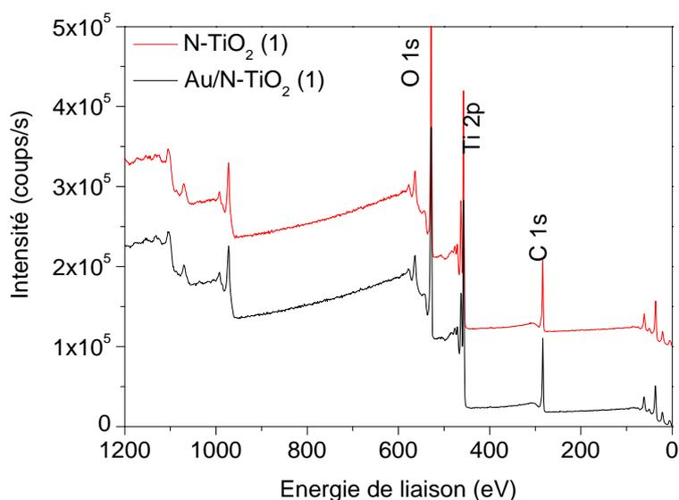
**Figure III.16 : Superposition des spectres XPS complets des poudres N-TiO<sub>2</sub> (1) et Au/N-TiO<sub>2</sub> (1)**
