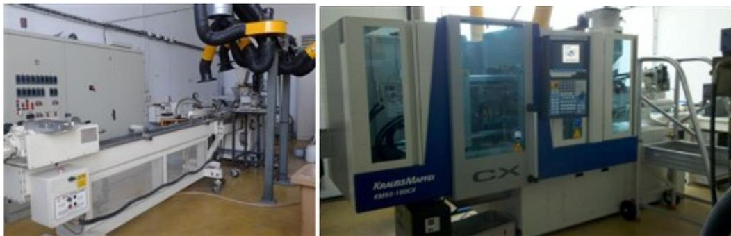
Figure II.5 : Extrudeuse 1200 mm (à gauche) et Presse à injecter (à droite) au C2MA
