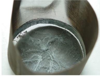
Figure III.9 : Photographie du résidu dans le porte-échantillon provenant de l'incinération de PA6/5HNTs au four tubulaire
