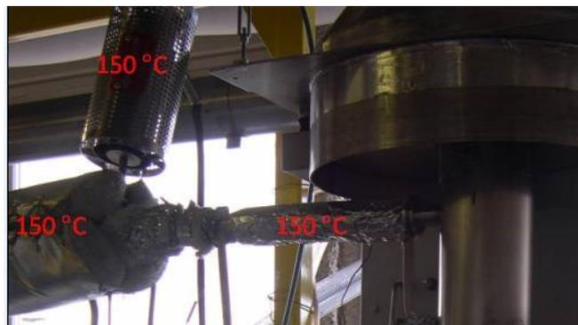
Figure A. 4 : Ligne de chauffage et de calorifugation pour échantillonnage à 150 °C – Cône calorimètre
