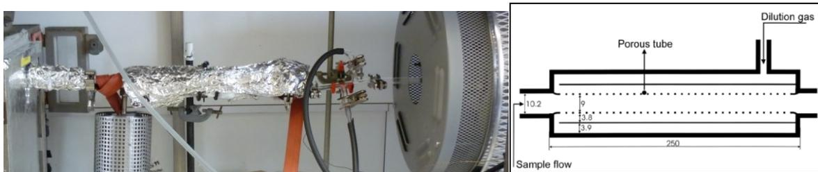
Figure A. 3 : Chauffage et calorifugation pour dilution et prélèvement par impaction à 170 °C – Four tubulaire
