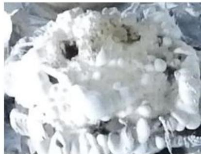
**Figure IV. 48 : Résidus de combustion – Incinération du nanocomposite PDMS/27SiO<sub>2</sub> au cône calorimètre**
