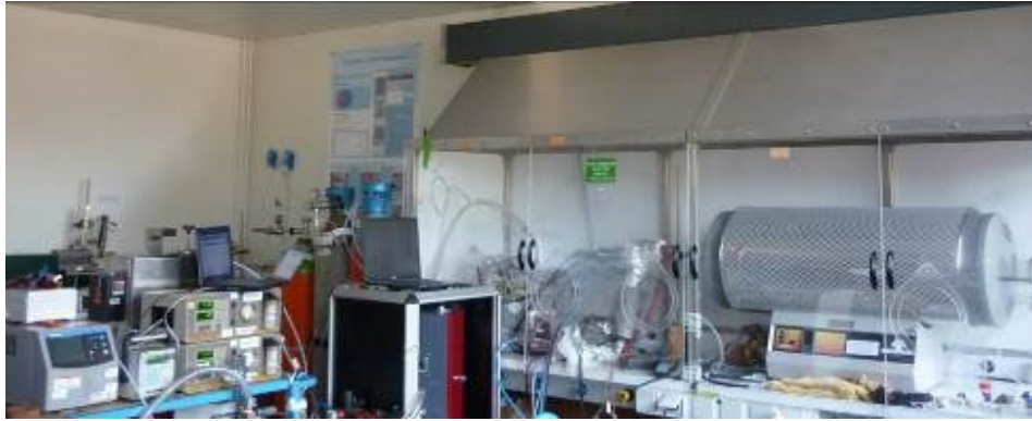
Figure II.7 : Photographie du dispositif expérimental en configuration n°1 (four/gaz/FPS/ELPI/MPS), à l'INERIS
