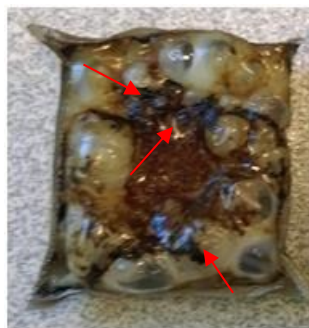
Figure III.22 : Etat de surface du nanocomposite PA6/5HNTs retiré avant l'ignition dans le cône calorimètre (t=20 s)
