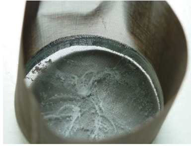
Figure III.9 : Photographie du résidu dans le porte-échantillon provenant de l'incinération de PA6/5HNTs au four tubulaire
