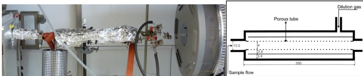
Figure A. 3 : Chauffage et calorifugation pour dilution et prélèvement par impaction à 170 °C – Four tubulaire Le diluteur à tube poreux VTT
