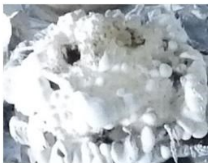
Figure IV. 48 : Résidus de combustion – Incinération du nanocomposite PDMS/27SiO 2 au cône calorimètre Photographie du résidu expansé (meringue blanche)
