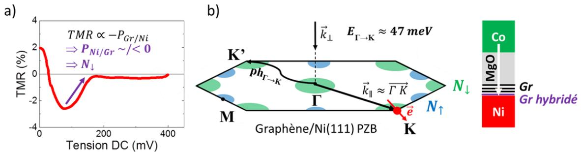
Figure 69 – a) Partie positive en tension de la TMR (V) obtenue sur la jonction de  $1 \mu\text{m}^2$ . b) Adaptation de la PZB de l'interface Ni(111)/graphène calculée par Karpan *et al.* et schéma de transport à travers la barrière.
