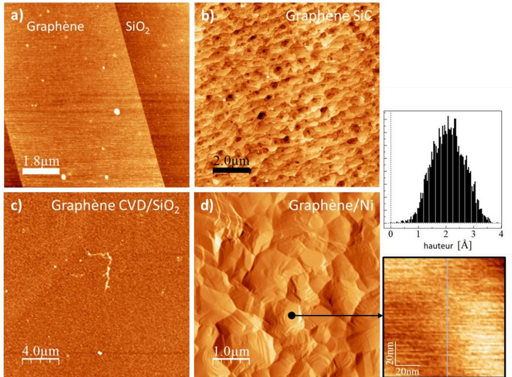
Figure 38 – Images *AFM* du graphène sur  $\text{SiO}_2$  a), du graphène sur  $\text{SiC}$  face  $\text{Si}$  b), du graphène CVD crû sur cuivre et transféré sur  $\text{SiO}_2$  c) et du graphène CVD sur nickel d). À droite, l'image *AFM* réalisée sur un cristal de nickel.
