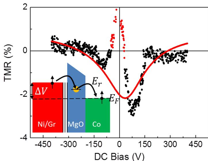
Figure 66 – *TMR(V)* de la jonction de  $1\mu\text{m}^2$  où les points proches du pas de mesure ont été masqués pour l'ajustement (points en rouge). Les points noirs représentent les données et la courbe rouge représente l'interpolation de ces points. En insert le schéma de principe de l'effet tunnel via un défaut dans la barrière de MgO où  $E_r$  représente l'énergie du défaut.
