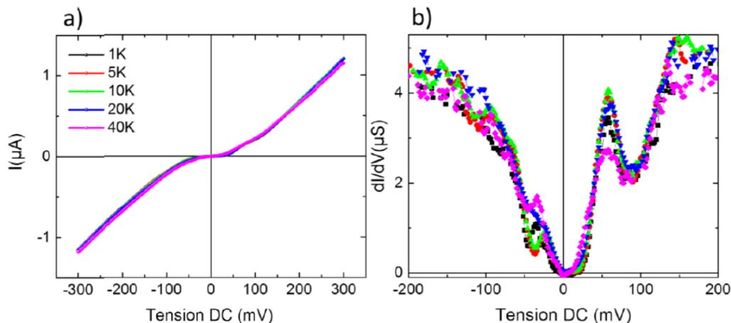
Figure 79 –  $I(V)$  a) et  $dI/dV(V)$  correspondantes b) mesurées en température à travers une jonction verticale de  $100 \mu m^2$  de  $Co/AlOx/Al/Gr/Ni$  avec une épaisseur déposée de 2,2 nm d'aluminium
