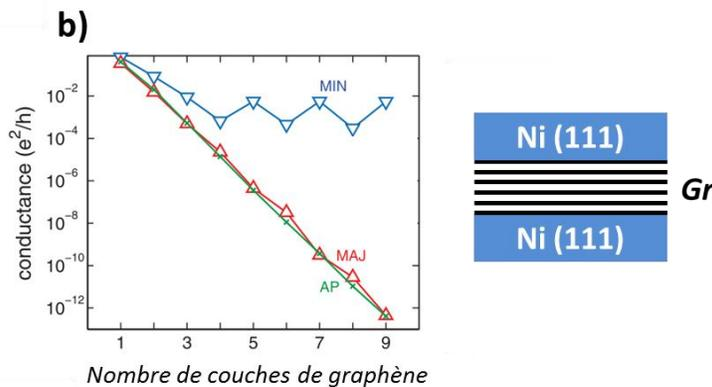
b) Evolution théorique de la conduction des porteurs majoritaires et minoritaires à travers une jonction Ni(111)/graphène/Ni(111) en fonction du nombre de couches de graphène. On voit qu'au-delà de 4 couches, les porteurs minoritaires gouvernent la conduction dans la jonction et donc le courant de spin.
