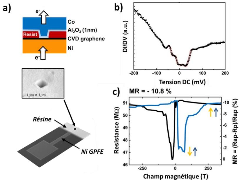
Figure 10 – Image adaptée de la référence [Dlubak 2012]. a) Réponse  $dI/dV$  en tension de la jonction de  $1\mu\text{m}^2$  mesurée à 1,5K et réalisée par l'équipe de l'UMP/Thales b) Vue schématique du dispositif montrant l'empilement des couches (b). c) Courbe de magnétorésistance mesurée à 1,5K à travers la jonction de  $1\mu\text{m}^2$  de Co/AlOx/GPFE. Les auteurs ont pu déduire de cette mesure une polarisation en spin de l'interface Ni/Gr de l'ordre de -42%.
