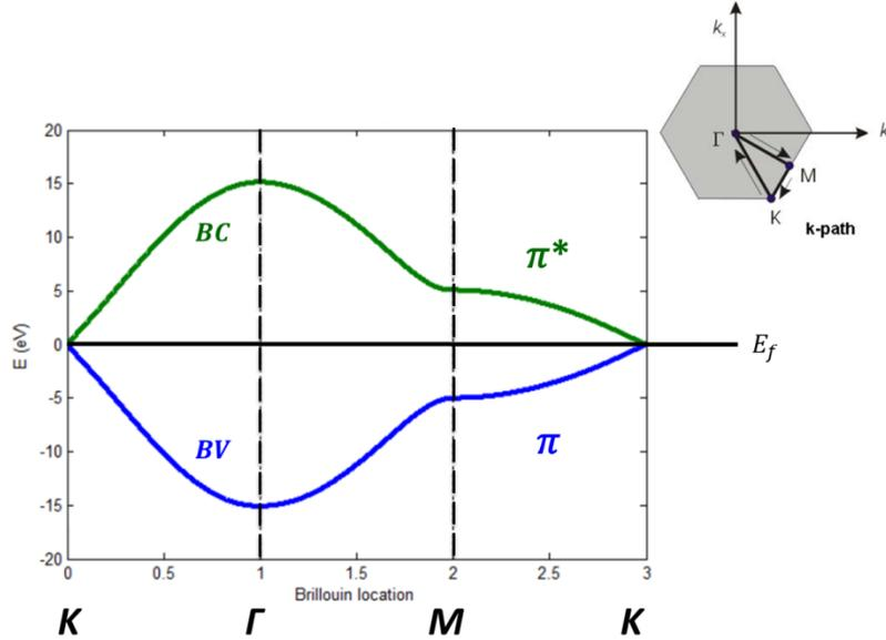
Figure 88 – Relation de dispersion électronique du graphène suivant le chemin  $K\text{-}\Gamma\text{-}M\text{-}K$  centrée au niveau de Fermi  $E_f$  où la bande de conduction  $BC$  apparaît en vert et la bande de valence  $BV$  apparaît en bleu. En haut à droite, le chemin suivant lequel est tracé la structure de bande dans la PZB du graphène.
