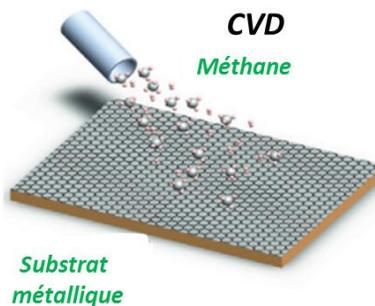
Figure 17 – Schématisation du dépôt de graphène sur un substrat métallique adapté de la référence [Bonaccorso 2012].
