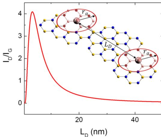
Figure 23 – Rapport de l'intensité du pic D avec celle du pic G du graphène en fonction de la distance inter-défauts  $L_D$ . En insert, le schéma d'une partie de graphène présentant deux défauts distants de  $L_D$ , de rayons d'influence  $r_a$  et localisé en  $r_s$ .
