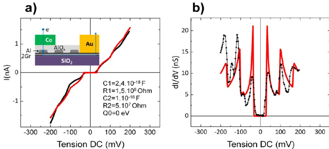
Figure 80 – Courbes  $I(V)$  a) et  $dI/dV(V)$  associée b) mesurées à 1,5K (courbes noires) et ajustées avec les paramètres en insert suivant le modèle de blocage de Coulomb (courbes rouges) pour un dispositif latéral avec un dépôt de 2,2 nm d'aluminium. En insert de l'  $I(V)$  le schéma du dispositif étudié.
