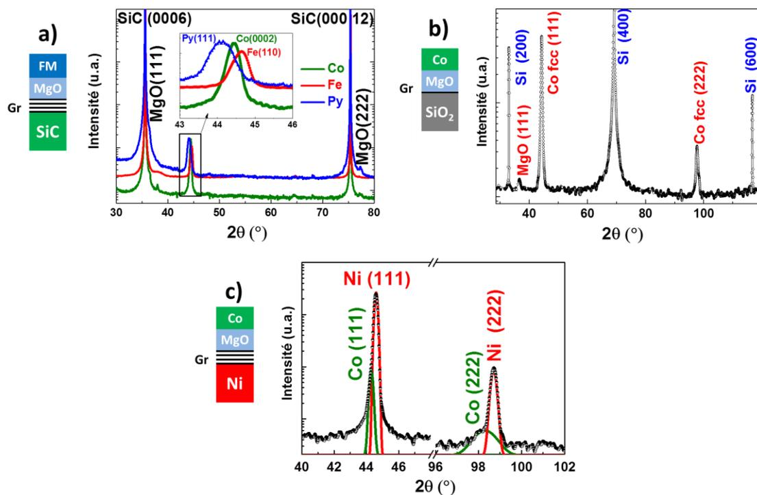
Figure 52 - Mesures par diffraction de rayons X en configuration  $2\theta$  du dépôt de 10 nm de Fe, Co, Py par EJM sur le graphène SiC face Si a), de 10 nm de Co sur le graphène CVD cuivre transféré sur SiO<sub>2</sub> b) et sur le graphène CVD nickel c). La source X utilisée dans notre cas est une anode de cuivre dont la raie principale  $K\alpha$  émet à une longueur d'onde  $\lambda$  de 1,5406 Å.
