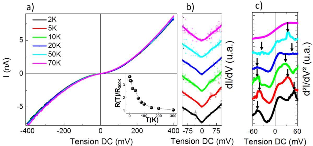
Figure 62 – a) Réponse courant-tension en température d'une jonction verticale de  $1\mu\text{m}^2$  de Co/MgO/Gr/Ni avec en insert l'évolution de la résistance normalisée du dispositif en fonction de la température. b)  $dI/dV$  (V) et c)  $d^2I/dV^2$  correspondantes à basse tension en température.
