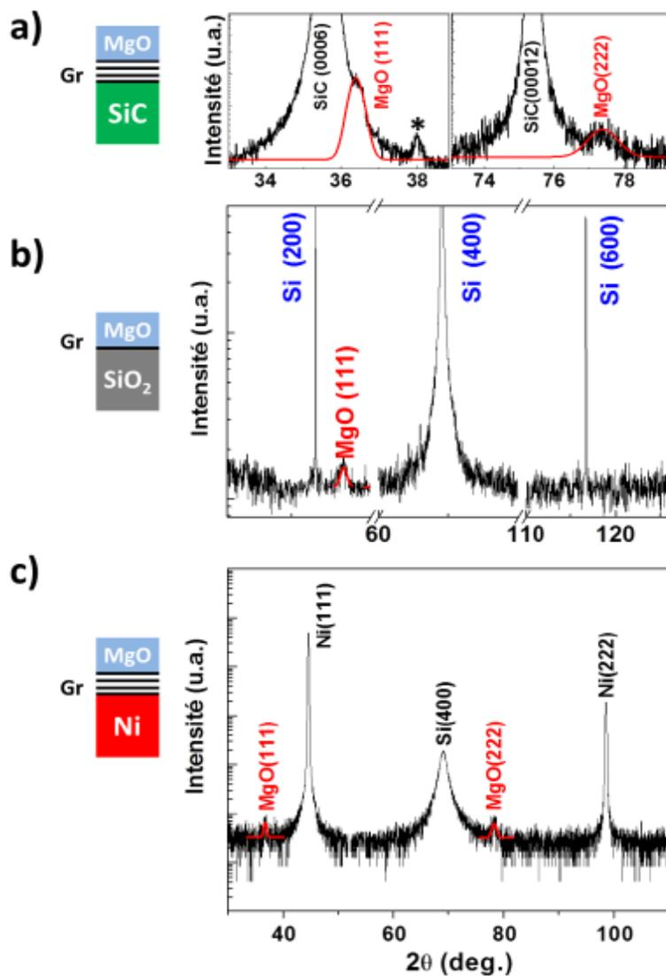
Figure 42 – Mesures par diffraction de rayons X en configuration  $2\theta$  du dépôt de 0,12 nm de Ti suivi de 3nm de MgO par EJM sur le graphène SiC face Si a), le graphène CVD cuivre transféré sur SiO<sub>2</sub> b) et sur le graphène CVD nickel c). La source X utilisée dans notre cas est une anode de cuivre dont la raie principale Ka émet à une longueur d'onde de 1,5406 Å.
