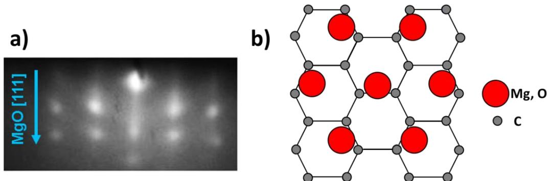
Figure 40 – a) Diagramme *RHEED* *in situ* de la croissance de 0,12 nm de Ti suivi de 3nm de MgO sur graphène SiC. Le diagramme montre clairement un ordre cristallographique du MgO que l'on peut assigner à la direction de croissance (111). b) Hypothèse concernant l'arrangement des atomes de magnésium ou d'oxygène terminant la face (111) du MgO sur graphène.
