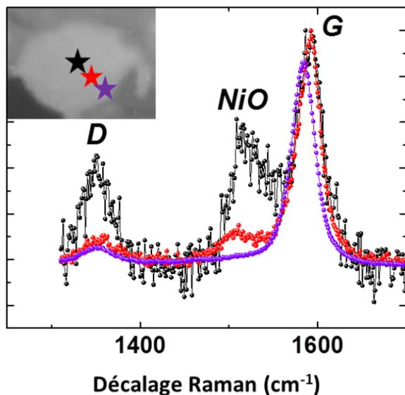
Figure 36 – Spectres Raman collectés sur la zone définie par le rectangle noir de l'image optique de la Figure 35 a) à l'aide d'un laser 532 nm (2,33 eV) de puissance 1mW, de taille de spot  $0,6\mu\text{m}$  et intégré durant 300 s. Les spectres Raman sont collectés sur zone de mono couche de graphène. L'insert montre à quel endroit les spectres sont collectés.
