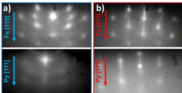
Figure 51 –a) Diagrammes RHEED *in situ* de la croissance de 10 nm de fer (haut) et 10 nm de permalloy (bas) par EJM sur une barrière de MgO(111) sur graphène SiC face Si. b) Diagrammes RHEED des mêmes dépôts après un recuit à  $450^{\circ}\text{C}$  sous ultravide pendant 1h. On remarque clairement qu'après recuit, la cristallinité des électrodes ferromagnétiques s'est améliorée.
