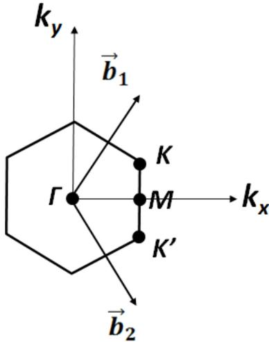
Figure 86 – Première zone de Brillouin du graphène centrée au point  $\Gamma$ .
