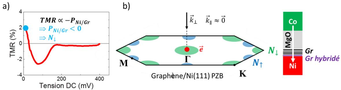
Figure 67 – a) Partie positive en tension de la TMR (V) obtenue sur la jonction de  $1\mu\text{m}^2$ . b) adaptation de la PZB de l'interface Ni(111)/graphène calculée par Karpan *et al.* et schéma de transport à travers la barrière.
