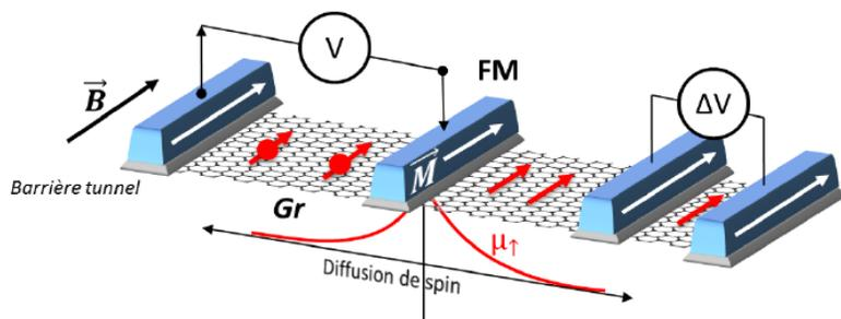
Figure 1 – Schéma classique d'un dispositif d'électronique de spin en configuration latérale à base de graphène.  $B$  représente le champ magnétique et  $M$  l'aimantation de la couche ferromagnétique. En rouge les électrons avec leurs spins associés (flèches).
