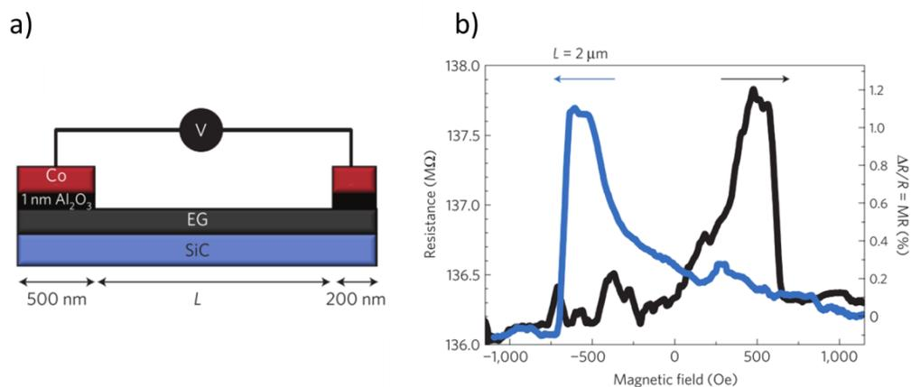
Figure 3 – Image adaptée de la référence [Dlubak 2012b]. a) Schéma de principe de la mesure en configuration locale étudiée par Dlubak *et al.* dans des jonctions de Co/AlOx/graphène épitaxié sur face C. b) Mesure de magnétorésistance pour une distance inter-électrode de 2 μm où un signal de 1,2 % a été mesuré.
