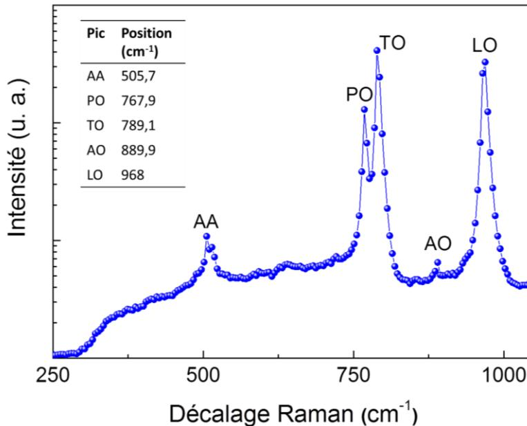
Figure 33 – Spectre Raman collecté à l'aide d'un laser 532 nm de puissance 0.87 mW et de taille de spot 0.6 μm et ce à basse énergie (250 – 1000 cm<sup>-1</sup>) sur notre graphène SiC face Si. Les pics relatifs aux phonons longitudinaux et transverses apparaissent clairement, acoustiques et optiques du SiC dont la position est relevée dans le tableau en insert. La position du pic LO permet d'estimer la concentration de dopants dans le SiC [Li 2010].
