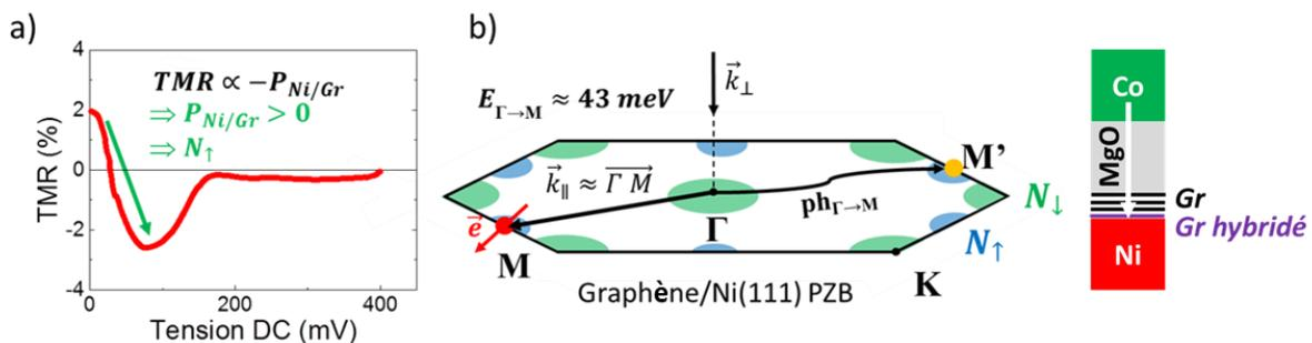
Figure 68 – a) Partie positive en tension de la TMR (V) obtenue sur la jonction de  $1\mu\text{m}^2$ . b) Adaptation de la PZB de l'interface Ni(111)/graphène calculée par Karpan *et al.* et schéma de transport à travers la barrière.
