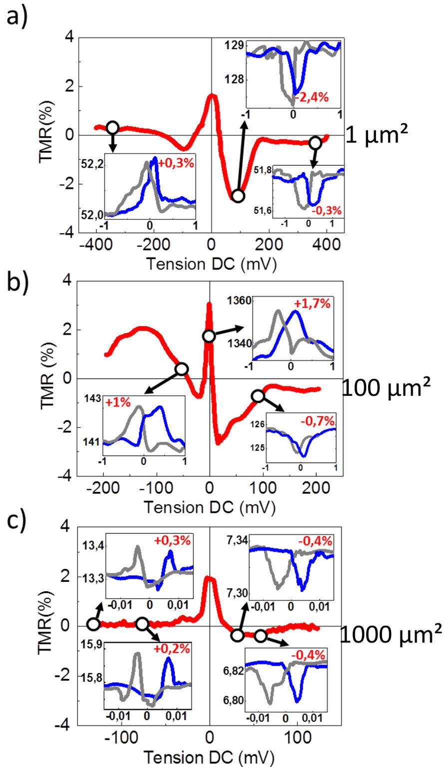
Figure 64 – TMR(V) à 1,5 K calculées pour chaque taille de jonction verticale, a)  $1 \mu\text{m}^2$ , b)  $100 \mu\text{m}^2$  et c)  $1000 \mu\text{m}^2$  à partir des  $I(V)$  collectées dans l'état parallèle et antiparallèle de chaque jonction. En insert, les TMR(B) mesurées à tension fixe définie par les cercles noirs et sont exprimées en  $\text{M}\Omega$  pour a) et  $\text{k}\Omega$  pour b) et c).
