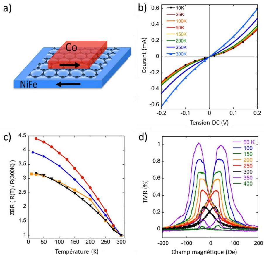
Figure 5 – Images adaptée de la référence [Cobas 2012]. A) Schéma de principe du dispositif utilisé par l'équipe de Jonker. b) courbe  $I(V)$  mesurées à travers la jonction de Co/Gr/Py en température. c) évolution de la résistance à basse tension normalisée par la résistance mesurée à 300K en fonction de la température pour quatre jonctions identiques (chaque couleur correspondante à une jonction différente). d) mesure de magnétorésistance en fonction de la température.
