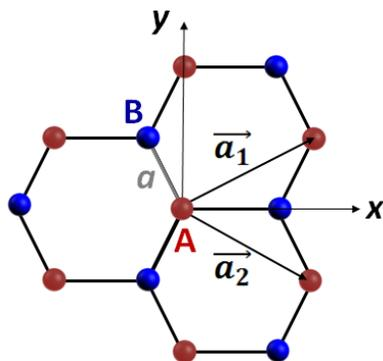
Figure 85 – Réseau en nid d'abeille du graphène avec la localisation des atomes de carbone du sous réseau A en rouge et ceux du sous réseau B en bleu. La distance interatomique entre un atome du sous réseau A avec celui du sous réseau B est de  $1.42 \text{ \AA}$ . La maille triangulaire élémentaire du graphène est définie dans l'espace réel par les vecteurs  $(\vec{a}_1, \vec{a}_2)$ .
