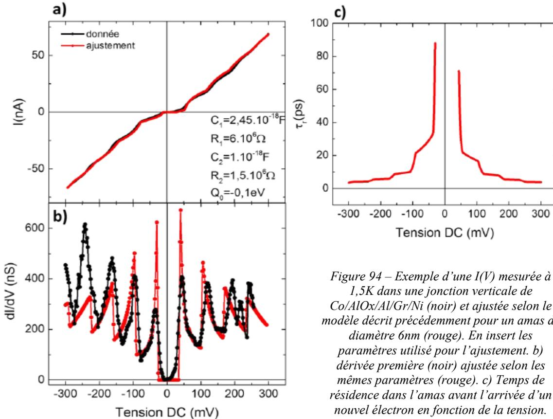
Figure 94 – Exemple d'une  $I(V)$  mesurée à 1,5K dans une jonction verticale de Co/AlOx/Al/Gr/Ni (noir) et ajustée selon le modèle décrit précédemment pour un amas de diamètre 6nm (rouge). En insert les paramètres utilisé pour l'ajustement. b) dérivée première (noir) ajustée selon les mêmes paramètres (rouge). c) Temps de résidence dans l'amas avant l'arrivée d'un nouvel électron en fonction de la tension.
