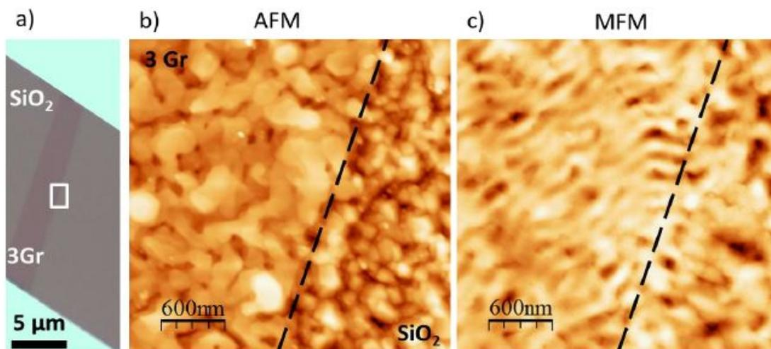
Figure 56 – a) Image optique d'un morceau de trois couches de graphène exfolié sur SiO<sub>2</sub> et contacté par des électrodes en or. Le carré blanc correspond à la zone où nous avons effectué la mesure *AFM* et *MFM*, suite au dépôt de Ti (0,12 nm) / MgO (3nm) / Py (30 nm).
