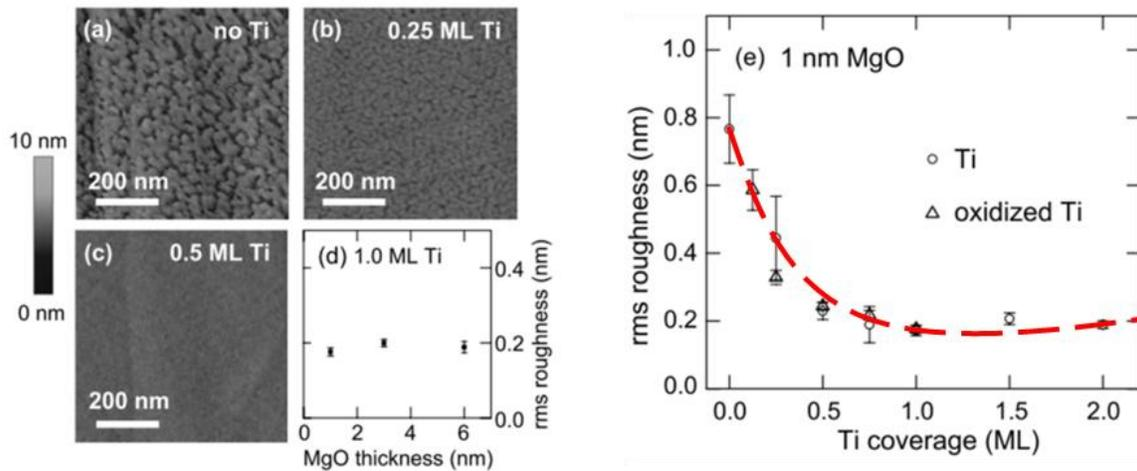
Figure 39 – Image tirée de [Wang 2008]. Gauche : Image AFM du dépôt de MgO sur HOPG après dégazage à  $160^{\circ}\text{C}$  : sans dépôt de Ti (a), avec 0.25 mono couche de Ti 5(b), avec 0.5 monocouche de Ti (c), évolution de la rugosité moyenne du MgO en fonction de l'épaisseur de son dépôt avec une pré-monocouche de Ti (d). Droite : Évolution de la rugosité d'1 nm de MgO en fonction du nombre de monocouche de Ti déposées au préalable. Le tracé rouge sert de guide pour les yeux.
