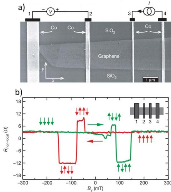
Figure 2 – Image adaptée de la référence [Tombros 2007]. a) Image SEM du dispositif latéral à base de graphène exfolié où sont déposées des électrodes de Co/AlOx. Le courant est injecté entre les contacts 3 et 4 et la diffusion de spin dans le graphène est détectée entre les contacts 1 et 2 via une différence de potentiel.
