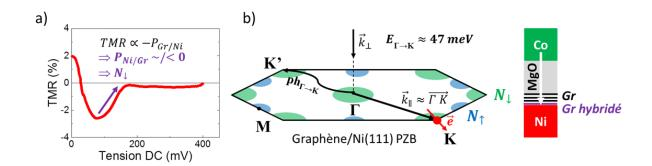
Figure 69 – a) Partie positive en tension de la TMR (V) obtenue sur la jonction de  $1\mu m^2$ . b) Adaptation de la PZB de l'interface Ni(111)/graphène calculée par Karpan et al. et schéma de transport à travers la barrière.
