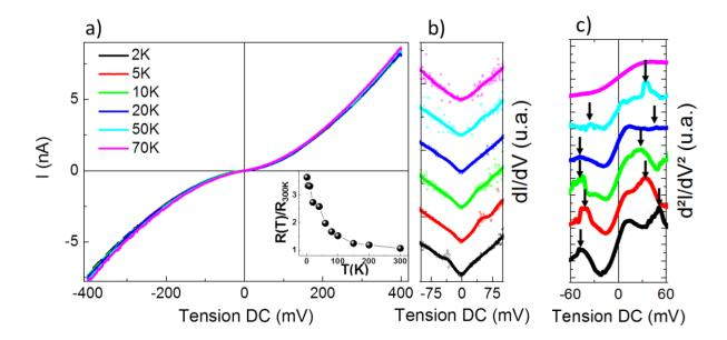
Figure 62 – a) Réponse courant-tension en température d'une jonction verticale de  $1\mu m^2$  de Co/MgO/Gr/Ni avec en insert l'évolution de la résistance normalisée du dispositif en fonction de la température. b) dI/dV (V) et c  $d^2I/dV^2$  correspondantes à basse tension en température.
