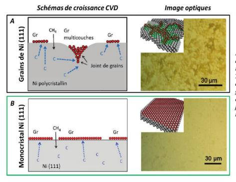
Figure 82 *Images* adaptées de référence [Zhang 2010]. Schémas de croissance CVDgraphène et images optiques sur un substrat polycristallin A) monocristallin B) de Ni.
