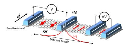
Figure 1 – Schéma classique d'un dispositif d'électronique de spin en configuration latérale à base de graphène. B représente le champ magnétique et M l'aimantation de la couche ferromagnétique. En rouge les électrons avec leurs spins associés (flèches).
