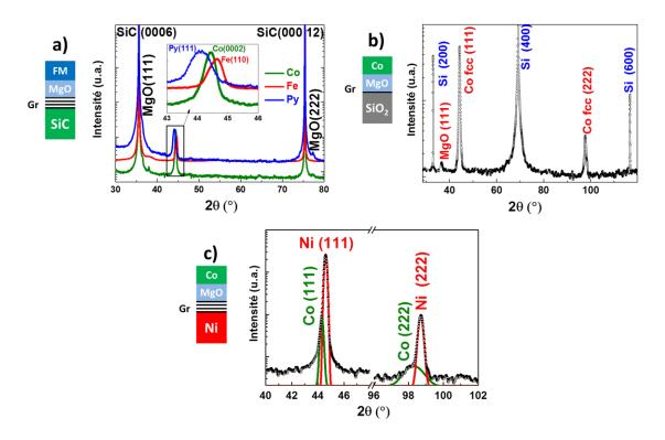
Figure 52 - Mesures par diffraction de rayons X en configuration 2θ du dépôt de 10 nm de Fe, Co, Py par EJM sur le graphène SiC face Si a), de 10 nm de Co sur le graphène CVD cuivre transféré sur SiO<sub>2</sub> b) et sur le graphène CVD nickel c). La source X utilisée dans notre cas est une anode de cuivre dont la raie principale Kα émet à une longueur d'onde λ de 1,5406 Å.
