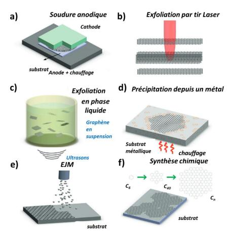
Figure 19 – Schémas de la production du graphène par soudure anodique a), par exfoliation laser b), par exfoliation en phase liquide c), par précipitation depuis un métal d), par épitaxie par jets moléculaire e) et par synthèse chimique f). Tous ces schémas sont adaptés de la référence [Bonaccorso 2012].
