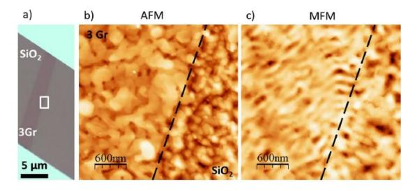
Figure 56 - a) Image optique d'un morceau de trois couches de graphène exfolié sur  $SiO_2$  et contacté par des électrodes en or. Le carré blanc correspond à la zone où nous avons effectué la mesure AFM et MFM, suite au dépôt de Ti (0,12 nm) / MgO (3nm) / Py (30 nm).
