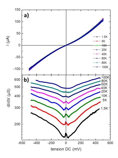
Figure 99 – a) courbes I(V) en température pour une jonction verticale Co/MgO/Gr/Ni de 1μm². Conductances associées b).
