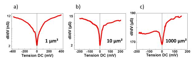
Figure 63 – Dérivées des réponses courant-tension mesurées à 1,5 K pour des jonctions verticales de Co/MgO/Gr/Ni de 1μm² a), 100μm² b) et 1000μm².
