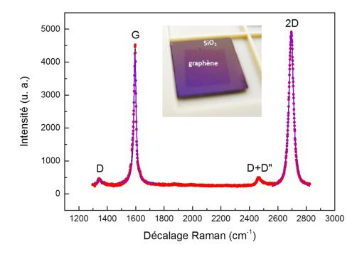
Figure 34 – Spectre Raman du graphène CVD transféré sur SiO<sub>2</sub> mesuré avec un laser de longueur d'onde 532 nm (2.33 e.V), de spot d'environ 1µm, avec une puissance de 1 mW et intégré durant 30s. Les courbes violettes correspondent à l'ajustement du pic G par une Lorentzienne, le pic 2D est ajusté à l'aide d'une Lorentzienne à la puissance 3/2.
