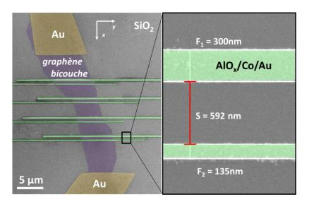
Figure 74 – Images SEM prise à 20ke.V de l'échantillon de graphène bicouche connecté par les pistes d'AlOx/Co et les électrodes d'or.
