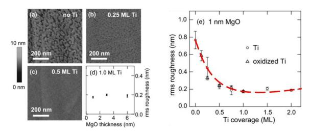
Figure 39 – Image tirée de [Wang 2008]. Gauche : Image AFM du dépôt de MgO sur HOPG après dégazage à 160°C : sans dépôt de Ti (a), avec 0.25 mono couche de Ti 5(b), avec 0.5 monocouche de Ti (c), évolution de la rugosité moyenne du MgO en fonction de l'épaisseur de son dépôt avec une pré-monocouche de Ti (d). Droite : Évolution de la rugosité d'1 nm de MgO en fonction du nombre de monocouche de Ti déposées au préalable. Le tracé rouge sert de guide pour les yeux.
