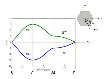
Figure 88 – Relation de dispersion électronique du graphène suivant le chemin K-Γ-M-K centrée au niveau de Fermi Ef où la bande de conduction BC apparait en vert et la bande de valence BV apparait en bleu. En haut à droite, le chemin suivant lequel est tracé la structure de bande dans la PZB du graphène.
