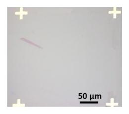
Figure 72 – Image optique d'un feuillet de tricouche de graphène après lithographie électronique des croix d'alignement.
