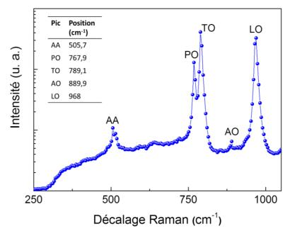
Figure 33 - Spectre Raman collecté à l'aide d'un laser 532 nm de puissance 0.87 mW et de taille de spot 0.6 µm et ce à basse énergie (250 – 1000 cm<sup>-1</sup>) sur notre graphène SiC face Si. Les pics relatifs aux phonons longitudinaux transverses apparaissent clairement, acoustiques optiques du SiC dont la position est relevée dans le tableau en insert. La position du pic LO permet d'estimer la concentration de dopants dans le SiC [Li 2010].
