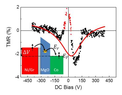
Figure 66 – TMR(V) de la jonction de 1μm² où les points proches du pas de mesure ont été masqués pour l'ajustement (points en rouge). Les points noirs représentent les données et la courbe rouge représente l'interpolation de ces points. En insert le schéma de principe de l'effet tunnel via un défaut dans la barrière de MgO où E<sub>R</sub> représente l'énergie du défaut.
