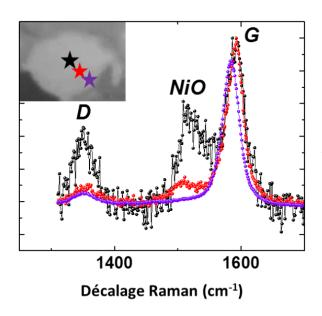
Figure 36 – Spectres Raman collectés sur la zone définie par le rectangle noir de l'image optique de la Figure 35 a) à l'aide d'un laser 532 nm (2,33 e.V) de puissance 1mW, de taille de spot 0,6µm et intégré durant 300 s. Les spectres Raman sont collectés sur zone de mono couche de graphène. L'insert montre à quel endroit les spectres sont collectés.
