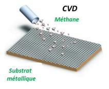
Figure 17 – Schématique du dépôt de graphène sur un substrat métallique adapté de la référence [Bonaccorso 2012].
