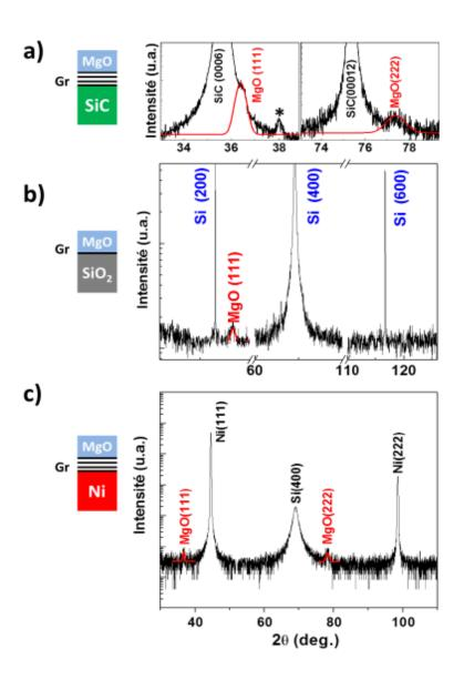
Figure 42 – Mesures par diffraction de rayons X en configuration  $2\theta$  du dépôt de 0,12 nm de Ti suivi de 3nm de MgO par EJM sur le graphène SiC face Si a), le graphène CVD cuivre transféré sur SiO $_2$  b) et sur le graphène CVD nickel c). La source X utilisée dans notre cas est une anode de cuivre dont la raie principale  $K\alpha$  émet à une longueur d'onde de 1,5406  $\mathring{A}$ .
