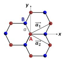
Figure 85 – Réseau en nid d'abeille du graphène avec la localisation des atomes de carbone du sous réseau A en rouge et ceux du sous réseau B en bleu. La distance interatomique entre un atome du sous réseau A avec celui du sous réseau B est de 1.42 Å. La maille triangulaire élémentaire du graphène est définie dans l'espace réel par les vecteurs  $(\overrightarrow{a_1}, \overrightarrow{a_2})$ .
