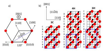
Figure 15 – a) Plan hexagonal définissant la zone d'intérêt, ici le plan (11-20). b)
