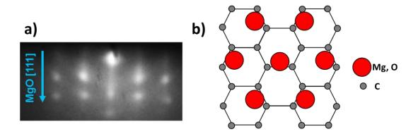
Figure 40 – a) Diagramme RHEED in situ de la croissance de 0,12 nm de Ti suivi de 3nm de MgO sur graphène SiC. Le diagramme montre clairement un ordre cristallographique du MgO que l'on peut assigner à la direction de croissance (111). b) Hypothèse concernant l'arrangement des atomes de magnésium ou d'oxygène terminant la face (111) du MgO sur graphène.
