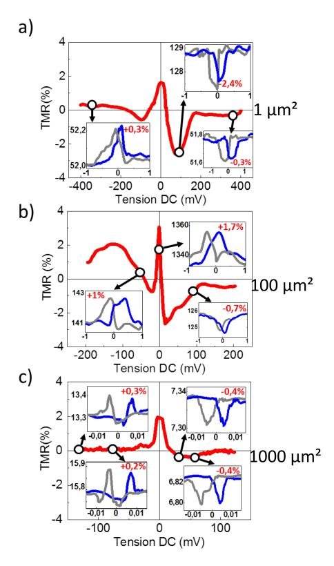
Figure 64 – TMR(V) à 1,5 K calculées pour chaque taille de jonction verticale, a)  $1\mu m^2$ , b)  $100\mu m^2$  et c)  $1000\mu m^2$  à partir des I(V) collectées dans l'état parallèle et antiparallèle de chaque jonction. En insert, les TMR(B) mesurées à tension fixe définie par les cercles noirs et sont exprimées en  $M\Omega$  pour a) et  $k\Omega$  pour b) et c).
