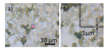
Figure 58 – Image optique d'une jonction (zone rose) de a)  $10 \mu m^2$  et b)  $1\mu m^2$  ouverte dans la résine (zone grise.
