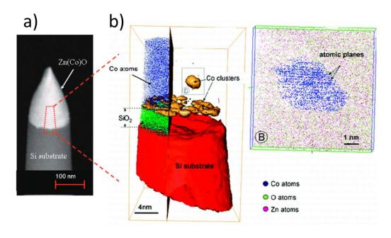
Figure 84 – Images adaptée de la référence [Lardé 2011]. A) Image SEM de la pointe réalisée par FIB d'un empilement de ZnCoO sur substrat de Si. b) Reconstruction par tomographie de l'empilement dans la pointe.
