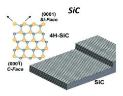
Figure 16 – Schéma adapté de la référence [Bonaccorso 2012]. Schéma de la croissance de graphène par sublimation des atomes de silicium du SiC.
