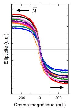
Figure 65 – Courbes d'aimantation obtenues à 4 K par effet Kerr sur 10 échantillons différents de Gr/Ni de graphene-supermarket
