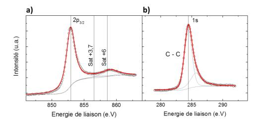
Figure 37 –Mesures XPS réalisées sur un échantillon de graphène multicouches sur nickel à l'aide d'une anode d'alumium comme source de rayon X de longeur d'onde 8.3 Å (1,5 Ke.V) et taille de spot de l'odre du millimètre pour le nickel a) et pour le carbone b).
