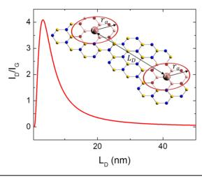
Figure 23 – Rapport de l'intensité du pic D avec celle du pic G du graphène en fonction de la distance inter-défauts L<sub>D</sub>. En insert, le schéma d'une partie de graphène présentant deux défauts distants de L<sub>D</sub>, de rayons d'influence r<sub>a</sub> et localisé en r<sub>s</sub>.
