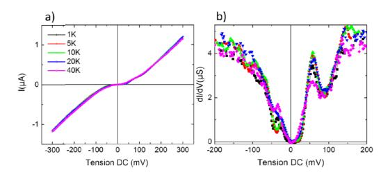
Figure 79 – I(V) a) et dI/dV(V) correspondantes b) mesurées en température à travers une jonction verticale de  $100~\mu\text{m}^2$  de Co/AlOx/Al/Gr/Ni avec une épaisseur déposée de 2,2 nm d'aluminium
