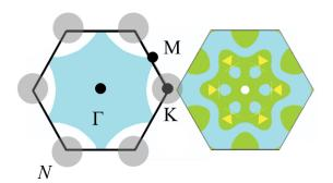
Figure 83 – Projection des surfaces de Fermi résolue en spin pour les porteurs majoritaires et minoritaires dans le plan la PZB du Co (0001)/graphène, où la PZB du graphène est schématisé en noir où les porteurs de charge sont localisés aux points K.
