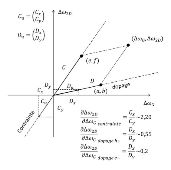
Figure 90 – Repére contraintes-dopage du graphène dans l'espace des pics Raman 2D vs. G. L'axe des contraintes est matérialisé par une droite de coefficient directeur 2,2, celui du dopage par une droite de coefficient 0,55 pour un dopage par des trous et 0,2 pour un dopage par des électrons.
