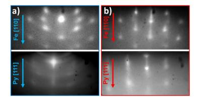
Figure 51—a) Diagrammes RHEED in situ de la croissance de 10 nm de fer (haut) et 10 nm de permalloy (bas) par EJM sur une barrière de MgO(111) sur graphène SiC face Si. b) Diagrammes RHEED des mêmes dépôts après un recuit à 450°C sous ultravide pendant 1h. On remarque clairement qu'après recuit, la cristallinité des électrodes ferromagnétiques s'est améliorée.
