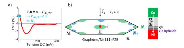
Figure 67 – a) Partie positive en tension de la TMR (V) obtenue sur la jonction de  $1 \mu m^2$ . b) adaptation de la PZB de l'interface Ni(111)/graphène calculée par Karpan et al. et schéma de transport à travers la barrière.
