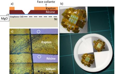
Figure 59 – a) Schéma de l'empilement des couches sur notre échantillon suite à la lithographie électronique. b) Image optique du masque réalisé en Kapton sur deux échantillons. c) positionnement du masque réalisé à partir de scotch Kapton dont la face collante est vers le haut a).
