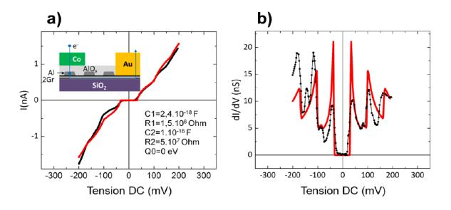
Figure 80 – Courbes I(V) a) et dI/dV(V) associée b) mesurées à 1,5K (courbes noires) et ajustées avec les paramètres en insert suivant le modèle de blocage de Coulomb (courbes rouges) pour un dispositif latéral avec un dépôt de 2,2 nm d'aluminium. En insert de l' I(V) le schéma du dispositif étudié.
