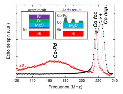
Figure 53 – Mesures RMN réalisées à 4 K sur un échantillon de Co (50 nm)/MgO (3nm)/Gr/Ni (200 nm) collectées avant et après le recuit à 450 °C. Chaque pic a été indexé en fonction de la configuration cristallographique du Co. Le spectre avant recuit a été ajusté à l'aide de gaussiennes qui apparaissent en pointillés gris. En insert, le schéma de la structure de l'empilement avant et après le recuit à 450 °C.
