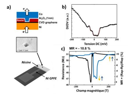
Figure 10 – Image adaptée de la référence [Dlubak 2012]. a) Réponse dI/dV en tension de la jonction de 1μm² mesurée à 1,5K et réalisée par l'équipe de *l'UMP/Thales b) Vue* schématique du dispositif avec la coupe verticale montrant l'empilement des couches (b). c) Courbe de magnétorésistance mesurée à 1,5K à travers la jonction de 1µm² de Co/AlOx/GPFE. Les auteurs ont pu déduire de cette mesure une polarisation en spin de l'interface Ni/Gr de l'ordre de -42%.
