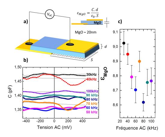
Figure 48 - a) Schéma du dispositf de mesure de la capacité du MgO sur graphène. b) Mesure de la capacité du MgO en tension à différentes fréquences et ajustement à l'aide d'une régréssion linéaire (lignes grises). c) Constante diéléctrique du MgO extraite des mesures C(V) en fonction de la fréquence de la tension. La barre d'erreur provient de l'incertitude dans la detérmination de la surface en jeu ainsi que de la varition de la capacité en fonction de la tension.
