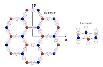
Figure 87 – Schéma des orbitales 2s,  $2p_x$   $2p_y$   $(\sigma)$  et  $2p_z(\pi)$  dans le graphène. Les points rouges correspondent aux carbones du réseau A et le bleus au réseau B.
