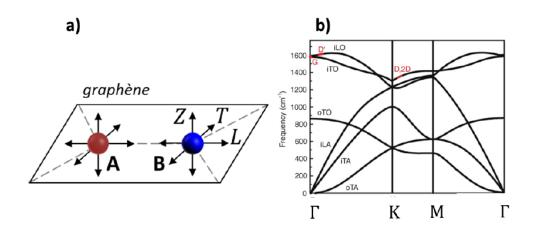
Figure 20-a) Déplacement atomique des atomes du sous réseau A et B des atomes de carbone selon l'axe Z hors du plan, T transverse et L longitudinal B) Relation de dispersion des phonons selon le chemin  $\Gamma$ -M-K- $\Gamma$ .
