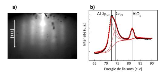
Figure 71 – a) Digramme RHEED de la croissance in situ de l'aluminium sur un substrat de graphène/Ni. b)
