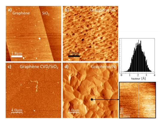
Figure 38 – Images AFM du graphène sur SiO<sub>2</sub> a), du graphène sur SiC face Si b), du graphène CVD crû sur cuivre et transféré sur SiO<sub>2</sub> c) et du graphène CVD sur nickel d). À droite, l'image AFM réalisée sur un cristal de nickel.
