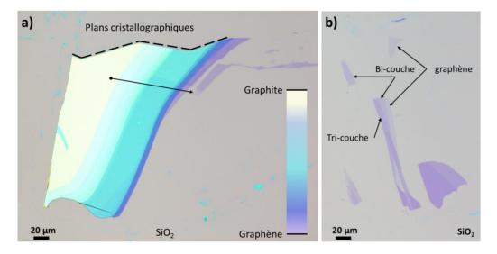
Figure 14 – a) Image optique grossissement 50 d'un « escalier » de graphène: la barre de couleur en insert donne une idée de l'évolution du nombre de couches en fonction de la couleur observée pour une épaisseur d'oxyde de silicium de 280 nm. b) Image optique grossissement 50 de mono-, bi- et tri- couches de graphène isolées.
