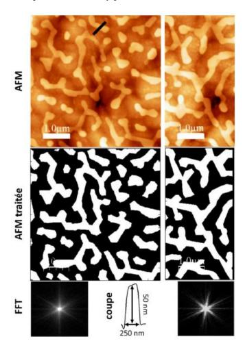
Figure 55 – Mesures AFM sur un échantillon de 20 nm de Py déposés sur du MgO(111)/graphène CVD sur nickel après un recuit sous ultravide à 450°C. En dessous, les images AFM traitées puis transformées dans l'espace réciproque. Une coupe de profile a été réalisée pour montrer la taille de mesas de Py qui font en moyenne 50 nm de haut sur 200 nm.
