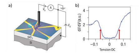
Figure 6 – Image adaptée de la référence [Zhang 2008]. a) Schéma de principe de l'expérience d'injection par STM d'un courant d'électron dans le graphène. b) Mesure de la conductance entre la pointe STM et le graphène.
