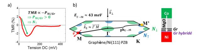
Figure 68 - a) Partie positive en tension de la TMR (V) obtenue sur la jonction de  $1\mu m^2$ . b) Adaptation de la PZB de l'interface Ni(111)/graphène calculée par Karpan et al. et schéma de transport à travers la barrière.
