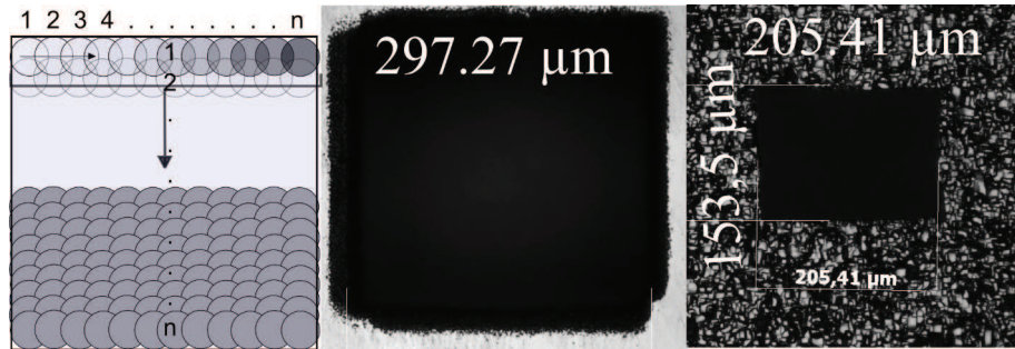
FIGURE 3.8 – Schéma décrivant le processus d’ablation pour une répétition (à gauche). Ablation du silicium par le laser Ti :Sa, 50 pulses par cavité, 20 répétitions, 5 J/cm^2 . La face du dessus au milieu et la face arrière à droite.
