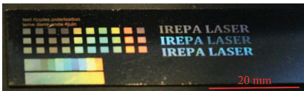
FIGURE 4.5 – Visualisation de ripples sur de l'inox orientés différemment en changeant la polarisation du laser. Utilisation du laser Tangerine à 10 kHz, 70% de recouvrement et avec une fluence de 500 \text{ mJ/cm}^2
