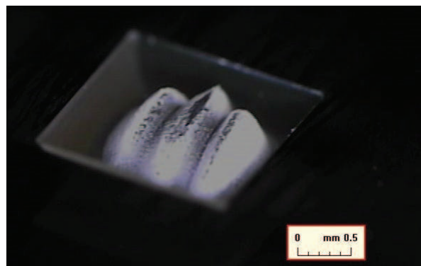
FIGURE 4.9 – Ecaille faite sur du verre avec le laser Tangerine en infra-rouge. l’écaille mesure 1,8 mm de large
