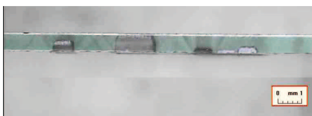
FIGURE 4.16 – Vue de profil de l’ablation de la lame de verre faite avec le laser Tangerine en infra-rouge. On distingue des lignes de changement d’indice dans le verre, démarrants au niveaux de l’usinage. Certaines lignes sont perpendiculaires à la surface.
