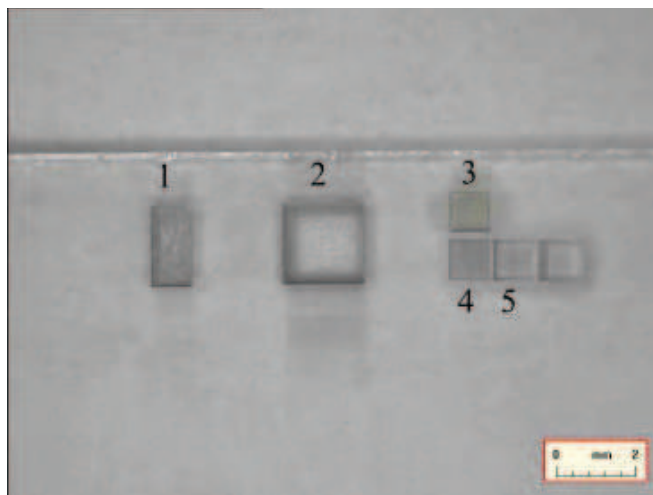
FIGURE 4.15 – Ablation profonde du verre avec le laser Tangerine en infra-rouge. Les numérotations correspondent aux numéros des essais dans le texte
