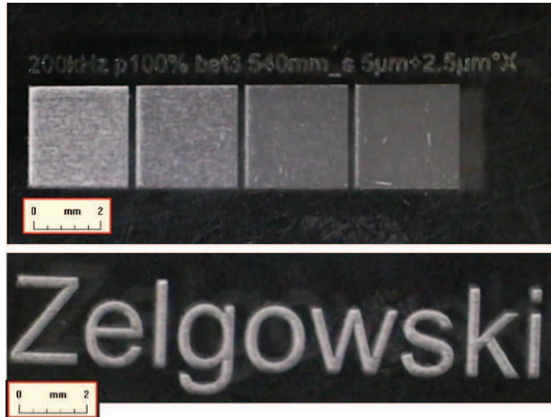
FIGURE 4.14 – Création d'un effet dépoli sur le verre. Utilisation du laser Tangerine en infra-rouge pour une fluence de 13 \text{ J/cm}^2 pour l'essai en haut à gauche et pour le marquage du bas.
