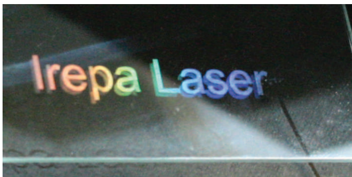
FIGURE 4.17 – Texturation du verre avec ripples, effet d’irisation réalisé avec le laser Tangerine en infra-rouge et une fluence de 10 J/cm^2
