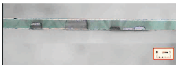
FIGURE 4.16 – Vue de profil de l’ablation de la lame de verre faite avec le laser Tangerine en infra-rouge. On distingue des lignes de changement d’indice dans le verre, démarrnant au niveaux de l’usinage. Certaines lignes sont perpendiculaires à la surface.
