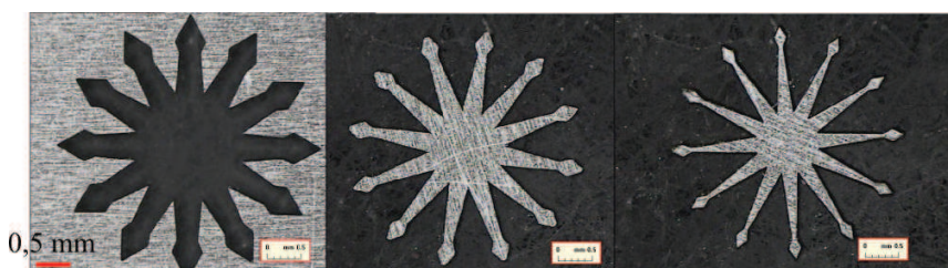
FIGURE 4.3 – Usinage d'un feuillet de 100 \mu\text{m} d'épaisseur avec le laser Tangerine en infra-rouge, une fréquence de 25 kHz avec une fluence de 200 puis 600 \text{ mJ}/\text{cm}^2 . La face avant se trouve à droite, la face arrière au milieu et la partie complémentaire à gauche.
