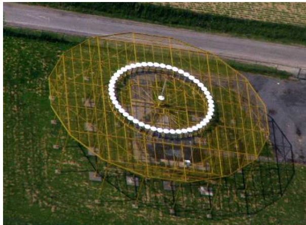
FIGURE 1.13 – Exemple de VOR Doppler [wikimedia commons].
