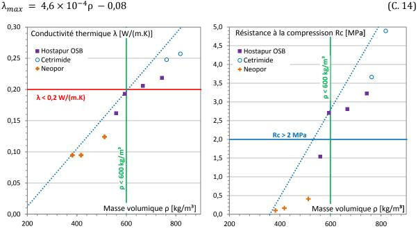
Figure C. 14. Mousse préformée : Propriétés thermomécaniques des mousses.
