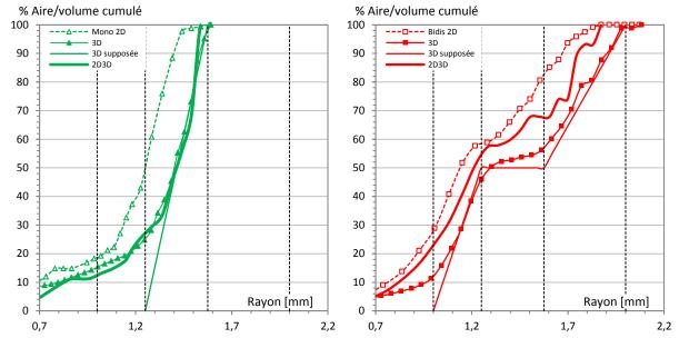
Figure D. 26. Monodiperse E11 et bidisperse E16: Passage de la distribution alvéolaire 2D à la 3D.
