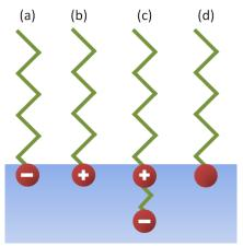
Figure B. 5. Types de tensioactif: (a) anionique; (b) cationique; (c) amphotère; (d) non ionique.
