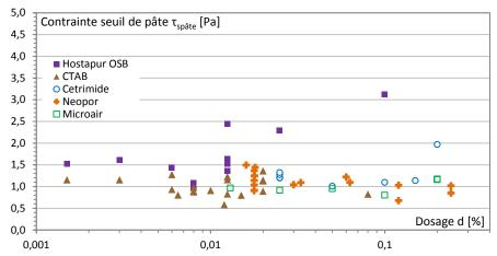
Figure C. 20. Méthode dissociée : Evolution de la contrainte seuil de pâte fraîche avant la phase de moussage en fonction du dosage en tensioactif.
