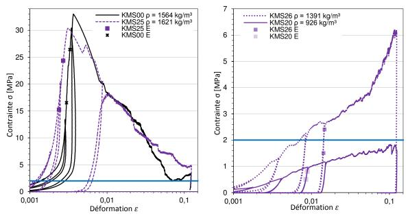
Figure C. 17. Malaxage simple : Essais en compression : KMS00 et KMS25 (gauche) ; KMS26 et KMS20 (droite).
