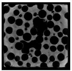
Figure D. 9. Echantillon monodisperse E13: Tranche 360, présence d'une grande quantité d'air.
