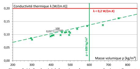
Figure C. 11. Conductivité thermique des mousses de ciment Prompt.
