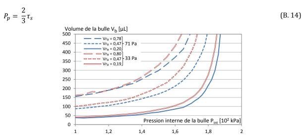
Figure B. 23. Evolution du volume en fonction de la pression interne de la bulle.
