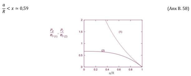
Figure B. 33. Evolution de  $P_{E}$  et  $P_{p}$  en fonction de a/R
