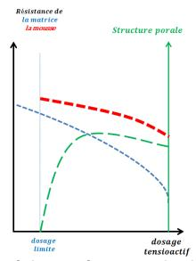
Figure D. 32. Second groupe : Relation entre dosage en tensioactif et performances mécaniques pour une masse volumique donnée.
