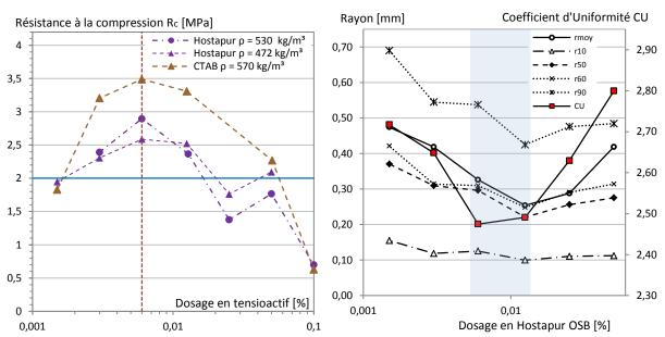
Figure D. 31. Effet de la structure : Evolution des performances mécaniques (gauche) et des paramètres géométriques de la série ( $\rho$  = 472 kg/m3) (droite) en fonction du dosage en tensioactif.
