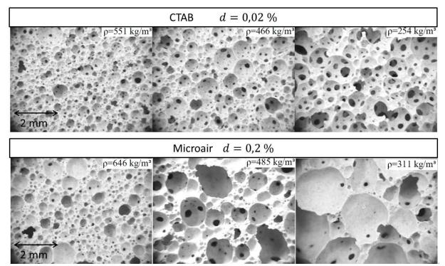
Figure C. 23. Exemple d'évolution de structure porale à dosage en tensioactif constant
