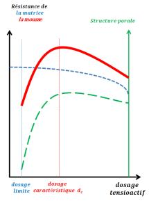
Figure D. 30. Premier groupe : Relation entre dosage en tensioactif et performances mécaniques pour une masse volumique donnée.
