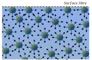
Figure B. 1. Origine de la tension de surface de l'eau.
