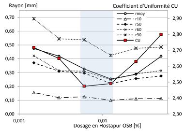
Figure D. 16. Evolution du Coefficient d'Uniformité CU et des rayons r<sub>90</sub>, r<sub>60</sub>, r<sub>50</sub> et r<sub>10</sub> en fonction du dosage en tensioactif pour les 6 échantillons étudiés.
