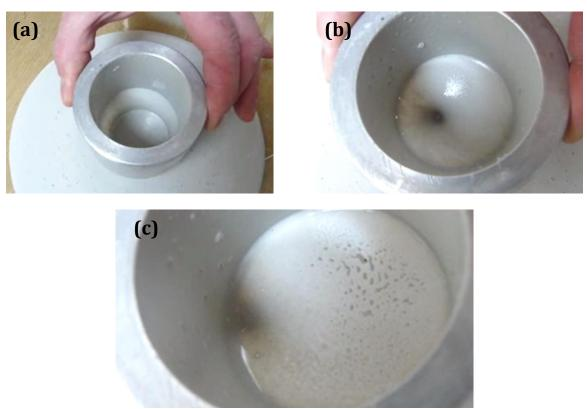
Figure C. 22. Essai d'étalement : mise en évidence du phénomène de démixtion.
