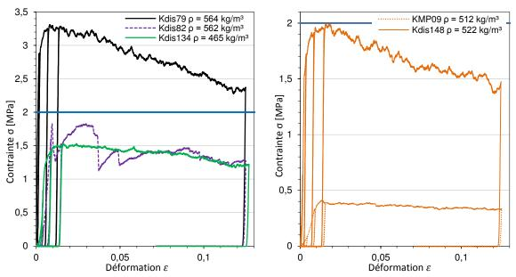
Figure C. 28. Essais en compression : Hostapur OSB Kdis79, Kdis82 et Kdis134 (gauche) ; Mousses Neopor KMP09 et Kdis148 (droite).
