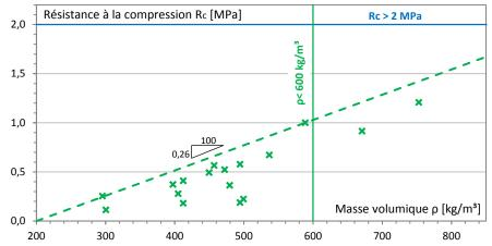
Figure C. 12. Résistance à la compression des mousses de ciment Prompt.
