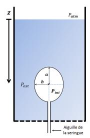
Figure B. 14. Container (gauche) ; Schéma de principe de l'injection d'une bulle (droite).
