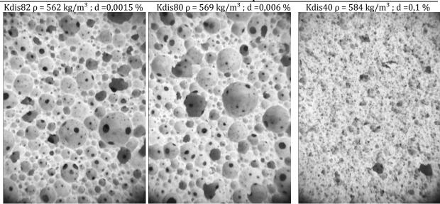
L'étude la structure porale de ces 2 séries révèle que l'optimum de résistance mécanique est associé à une structure plutôt polydisperse. Pour les trois séries étudiées, l'optimum de résistance est obtenu pour une valeur commune du dosage en tensioactif appelé dosage caractéristique,  $d_c = 0,006$  %. Ce dosage caractéristique en Hostapur OSB est très proche du dosage (d = 0,0045 %), présenté (partie B.4.4), permettant un bon maintien de la membrane
