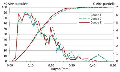
Figure D. 5. Mousse Kdis77: Distributions alvéolaires surfaciques de trois coupes.
