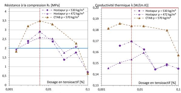
Figure C. 32. Evolution de la résistance en compression et de la conductivité thermique pour les trois séries.
