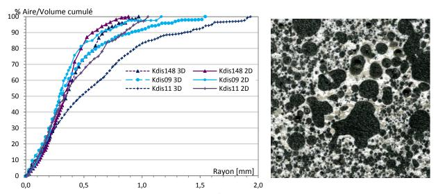
Figure D. 23. Comparaison des distributions alvéolaires surfaciques et volumiques des mousses Kdis148, Kdis07 et Kdis11 (gauche) – Mousse Kdis11 engluée (droite).
