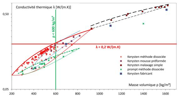
Figure C. 54. Conductivité thermique  $\lambda$  : Comparaisons des performances de l'ensemble des mousses produites
