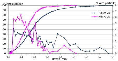
Figure D. 17. Distributions alvéolaires surfaciques des mousses d'Hostapur OSB Kdis24 et Kdis77.
