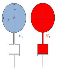
Figure B. 15. Volume de bulle V<sub>b</sub> et volume total V<sub>t</sub>.
