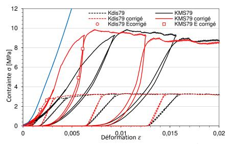
Figure C. 7. Correction du module d'Young de la mousse Kdis79 et de l'échantillon KMS79.
