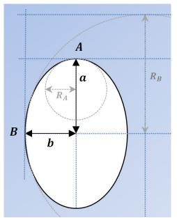
Figure B. 2. Géométrie d'une bulle ellipsoïdale
