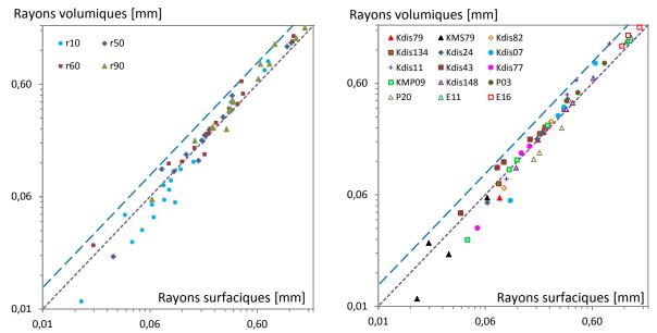
Figure D. 24. Comparaison des paramètres géométriques des distributions alvéolaires surfaciques et volumiques (échelle logarithmique) en fonction des paramètres géométriques (gauche), des mousses (droite).
