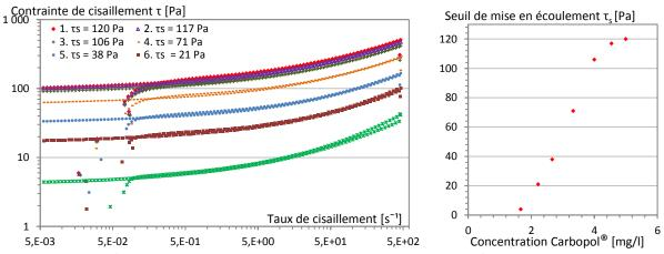
Figure B. 17. Rhéogramme de gel de Carbopol® de concentrations différentes (gauche) et seuil de mise en écoulement associés (droite).
