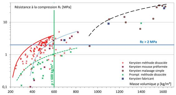
Figure C. 55. Résistance à la compression  $R_c$ : Comparaisons des mousses de Kerysten\$ et de ciment Prompt ainsi que des méthodes utilisées
