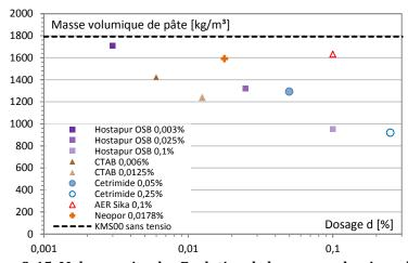
Figure C. 15. Malaxage simple : Evolution de la masse volumique de pâte
