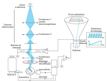
Figure C. 10. Principe de fonctionnement du MEB [147].
