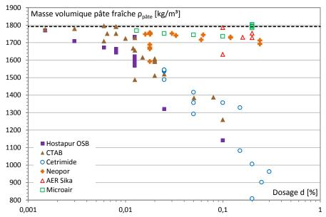
Figure C. 19. Méthode dissociée : Evolution de la masse volumique de pâte en fonction de la nature et dosage en tensioactif.
