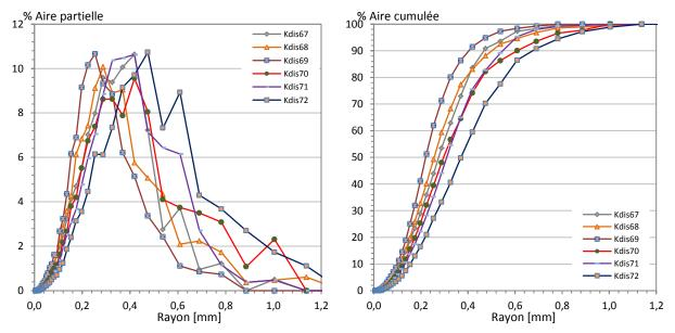
Figure D. 15. Distributions alvéolaires en fréquence (gauche) et en cumulé (droite) des 6 échantillons de mousse dont le dosage en tensioactif évolue de 0,0015 % (Kdis72) à 0,05 % (Kdis67).
