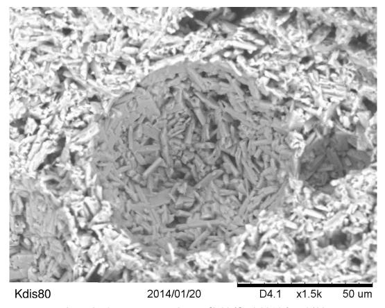
Figure C. 41. MEB: mousse CTAB Kdis80 (d = 0,006 %) - x1500
