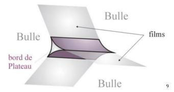
Figure B. 3. Jonction entre plusieurs bulles: Bord de Plateau.
