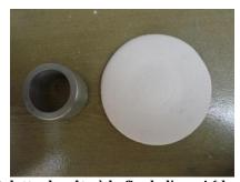
Figure C. 3. Essai étalement : Anneau FLS (gauche) ; Galette de pâte à la fin de l'essai (droite)
