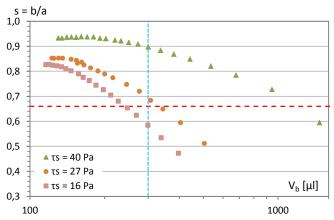
Figure B. 24. Evolution de la sphéricité avec l'augmentation du volume de la bulle  $V_b$ , pour  $V_{\rm r0}$  = 0,5.
