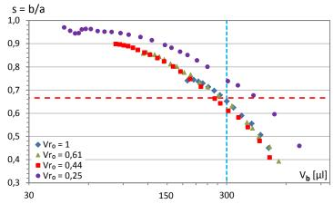
Figure B. 22. Variation du critère de sphéricité s, en fonction du volume de la bulle  $V_b$  ( $\tau_s = 71$  Pa).
