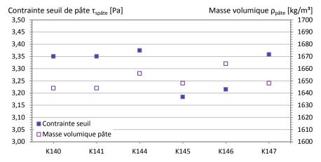
Figure C. 21. Essai de répétabilité. Caractéristiques de pâte.
