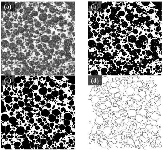
Figure D. 2. Les différentes étapes du traitement d'image.
