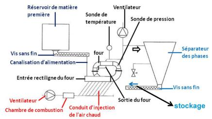
Figure C. 2. Schéma de principe du four flash [126]
