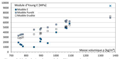
Figure C. 39. Evolution des modules d'Young mécanique et acoustique.
