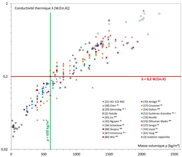
Figure A. 6. Relation entre conductivité thermique et masse volumique des bétons légers. <u>Légende</u>: Granulats légers = GL; Moussage chimique = MC; Malaxage rapide = MR; Mousse préformée = MP
