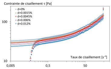
Figure B. 18. Rhéogramme du Carbopol® C07 pour différents dosages en tensioactif.
