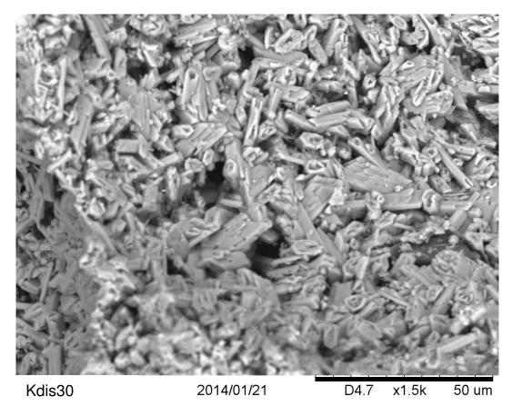
Figure C. 50. MEB: Mousses Cetrimide Kdis30 (d = 0,3 %).
