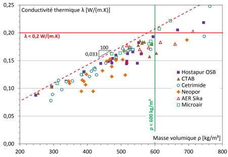
Figure C. 25. Conductivité thermique des mousses minérales.
