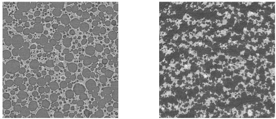
Figure D. 13. Vues en coupe de mousses Hostapur OSB Kdis24 (gauche) et P20 (droite).
