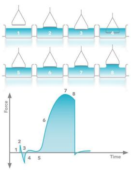
Figure B. 12. Protocole expérimental : Tension de surface [130].
