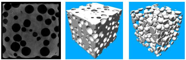
Figure D. 7. Bidisperse - tomographie (gauche). Visualisation 3D (centre / droite).
