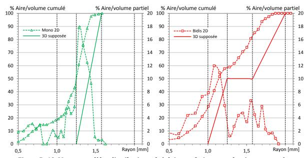
Figure D. 10. Mousse modèle : distributions alvéolaire surfacique et volumique supposée monodisperse E11 (gauche), bidisperse E16 (droite).
