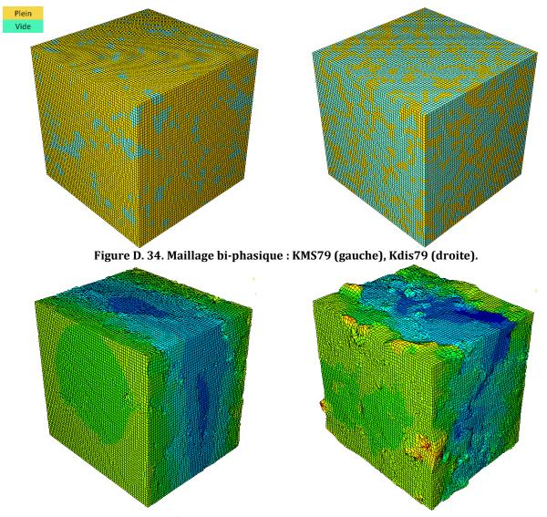
Figure D. 35. Déplacement - mousse KMS79 (gauche), Kdis79 (droite).
