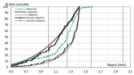
Figure D. 20. Distributions alvéolaires en surface dans le cas de la mousse modèle monodisperse E11 avec R = 1,41 mm.
