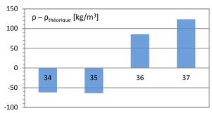
Figure C. 38. Ecarts moyens entre masses volumiques théoriques et expérimentales pour les mousses modèles monodisperses.
