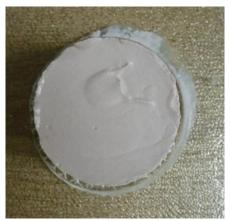
Figure C. 35. Essai d'étalement du plâtre à mouler.
