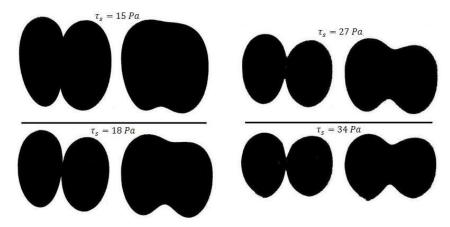
Figure B. 29. Evolution des conditions de coalescence en fonction du seuil ; avant rupture (gauche) ; après rupture (droite).
