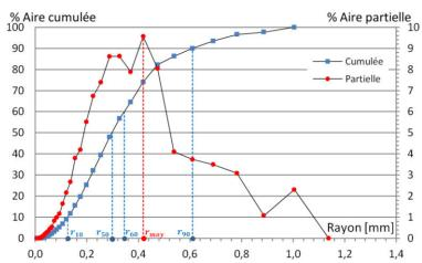
Figure D. 4. Mousse Kdis70 (Hostapur OSB, d = 0,006 % et  $\rho$  = 475 kg/m³) ; Distribution alvéolaire surfacique en fréquence et cumulée.
