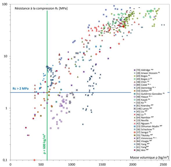
Figure A. 7. Relation entre résistance mécanique et masse volumique des bétons légers.
