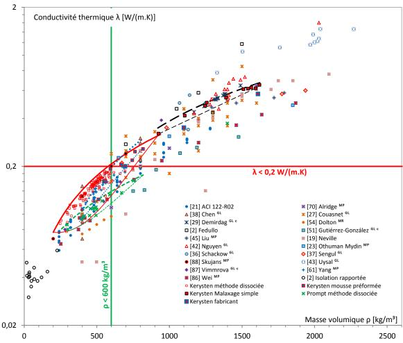
Figure C. 56. Conductivité thermique λ: Comparaisons des mousses de Kerysten® et de ciment Prompt aux mousses issues de la littérature.
