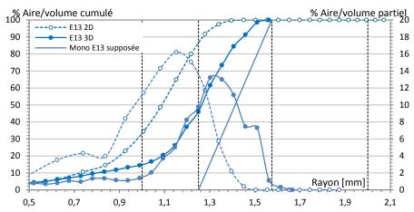
Figure D. 8. Mousse modèle monodisperse E13 : Distributions alvéolaires surfacique, volumique (cumulée, partielle et supposée).
