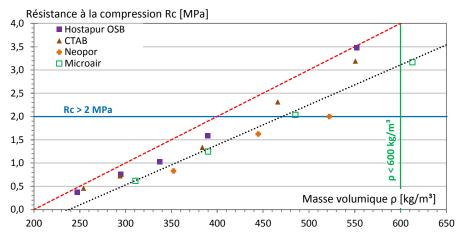
Figure C. 31. Dosage en tensioactif constant : Evolution de la résistance à la compression.
