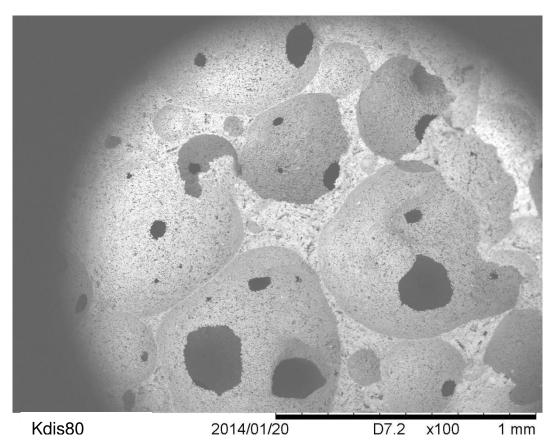
Figure C. 40. MEB : mousse CTAB Kdis80 (d = 0,006 %) -  $\rho$  = 1796 kg/m3 - x100
