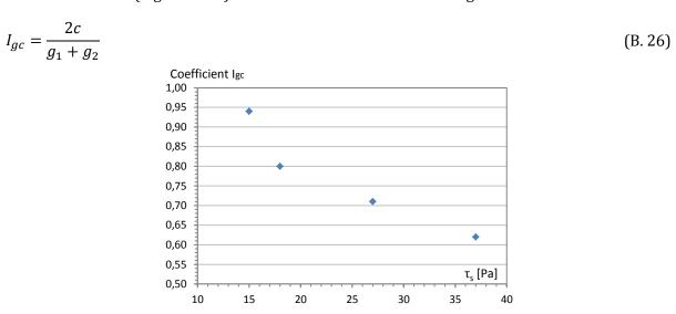
Figure B. 31. Evolution du coefficient  $I_{gc}$  en fonction de la contrainte seuil  $\tau_{s}$ .
