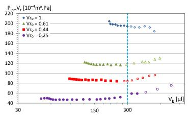
Figure B. 21. Variation du produit  $P_{int}$ .  $V_t$  en fonction du volume de bulle  $V_b$  mesuré ( $\tau_s = 26$  Pa).
