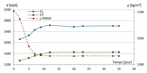
Figure C. 36. Echantillon MMOO sans bille : Evolution de la masse volumique et de la vitesse longitudinale et transversale en fonction du temps.
