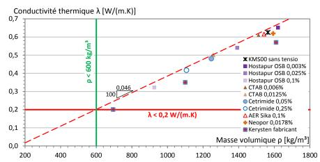
Figure C. 16. Malaxage simple : Conductivité thermique des mousses.
