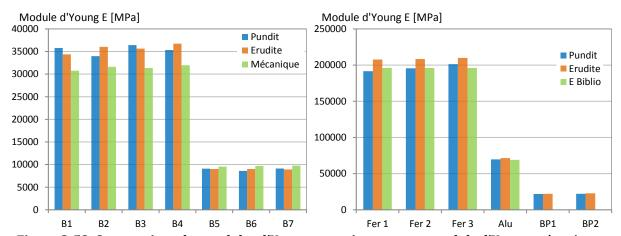
Figure C. 58. Comparaison des modules d'Young acoustiques aux au module d'Young mécaniques issus d'essai mesurés expérimentalement (gauche) et trouvés dans la littérature.
