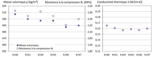
Figure C. 30. Essai de répétabilité. Caractéristiques thermomécaniques de la mousse.
