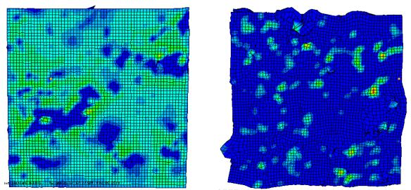
Figure D. 36. Répartition des contraintes dans la section centrale des mousses KMS79 (gauche et Kdis79 (droite).
