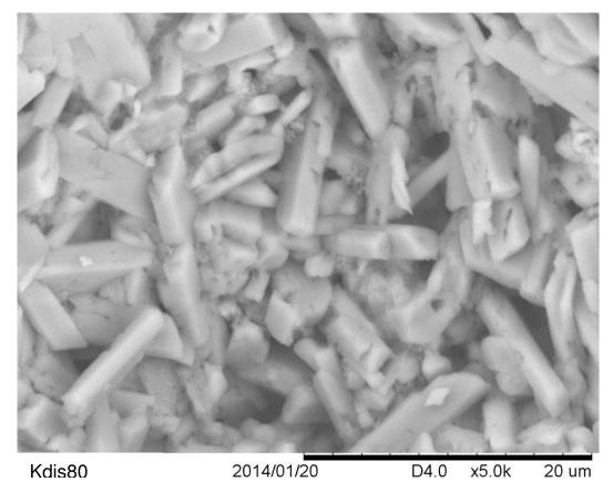
Figure C. 42. MEB: mousse CTAB Kdis80 (d = 0,006 %) - x5000
