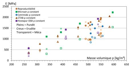
Figure C. 33. Essais acoustiques : Evolution des modules d'Young (Pundit®, Erudite® et mécanique) en fonction de la masse volumique pour les 5 groupes.
