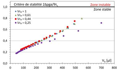
Figure B. 27. Evolution du coefficient de stabilité 2Δρga/9τ<sub>s</sub> en fonction du volume de bulle V<sub>b</sub>.
