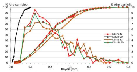
Figure D. 18. Distributions alvéolaires surfaciques des mousses de CTAB Kdis79, KMS79, Kdis82 et Kdis134.
