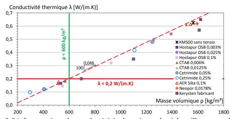
Figure C. 24. Comparaison des conductivités thermiques des échantillons ayant la même composition produits par malaxage simple et méthode dissociée.
