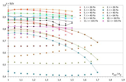
Figure B. 26. Evolution de la sphéricité de bulle en fonction du pas de pression.
