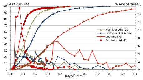
Figure D. 12 Mousses de ciment Prompt P03 et P20 - Mousse Kerysten® Kdis24 et Kdis43 : Distributions alvéolaires surfaciques.
