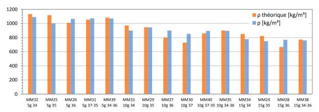
Figure C. 37. Ecarts entre masses volumiques théoriques et expérimentales pour les mousses modèles.
