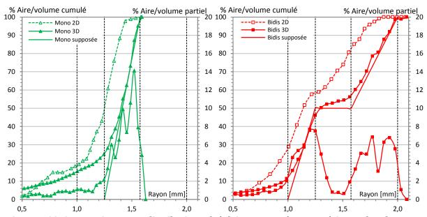
Figure D. 22. Comparaison entre distributions alvéolaires supposées et expérimentales obtenues par analyse d'images (2D) et tomographie (3D) pour les mousses modèles E11 et E16.
