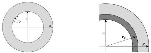
Figure B. 32. Géométrie et chargement appliqué à la sphère sous pression (gauche) ; Progression de la zone plastique à partir de la surface intérieure (droite).
