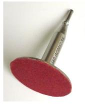
Figure B. 10. Rhéomètre Kinexus – Malvern® (gauche) – Partie mobile de la géométrie plan/plan recouverte de papier de verre (droite).
