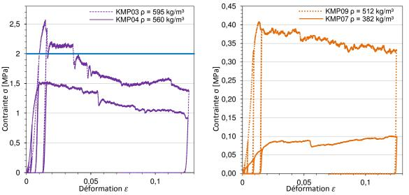
Figure C. 13. Mousse préformée : Essais en compression mousses KMP03 - KMP04 (gauche) ; KMP09 - KMP07 (droite).
