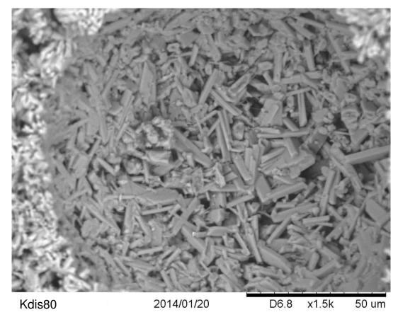
Figure C. 49. MEB: Mousses Kdis80 - grosse bulle (d = 0,006 %)
