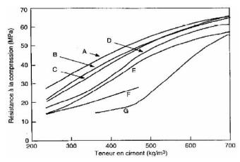
Figure A. 4. Evolution de la résistance à la compression à 28 jours (mesurée sur cube) en fonction du dosage en ciment de bétons ayant un affaissement de 50 mm et confectionnés avec différents types de granulats légers. (A) cendre volante frittée et granulat fin ordinaire ; (B) laitier de haut fourneau en boulette et granulat fin ordinaire ; (C) cendre volante frittée ; (D) schiste fritté ; (E) ardoise expansée ; (F) argile expansée et sable ; (G) laitier expansé [19].
