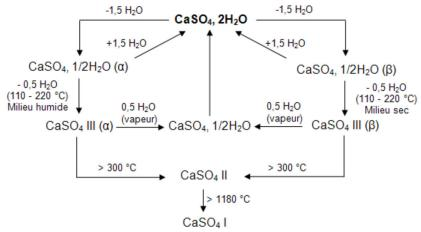
Figure C. 1. Réactions chimiques au sein de la branche β du système CaSO<sub>4</sub> - H<sub>2</sub>O [139].
