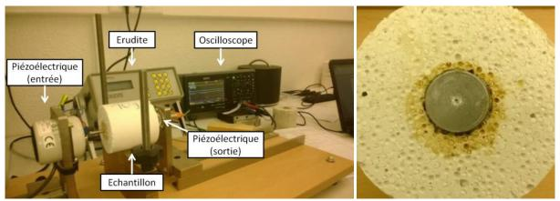
Figure C. 9. Erudite®. Appareil de mesure de la fréquence de résonance (gauche) ; pastille métallique (droite).
