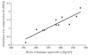
Figure A. 8. Evolution de la résistance à la compression en fonction de la masse volumique [88].
