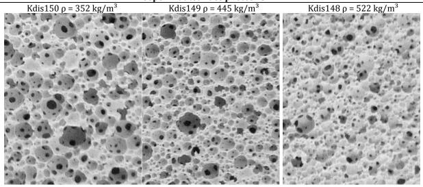
La structure de la mousse de faible masse volumique est plutôt connectée. Sans être monodisperse, cette structure possède tout de même une bonne homogénéité de taille de bulles. L'augmentation de la masse volumique entraîne une diminution de connections entre bulles la taille moyenne de bulle diminue également.
