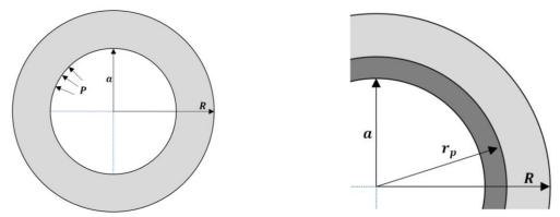
Figure B. 25. Géométrie et chargement appliqué à la sphère sous pression (gauche) ; Progression de la zone plastique à partir de la surface intérieure (droite).
