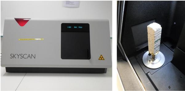
Figure D. 6. Tomographie : Appareil Skyscan (gauche) ; échantillon E11 sur le porte échantillon rotatif (droite).
