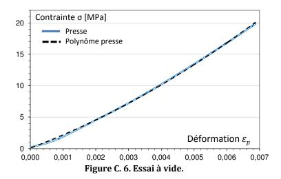
La relation entre contrainte  $\sigma$  et déformation de la presse  $\epsilon_p$  lors de la phase de charge est modélisée par le polynôme d'ordre 2 suivant (Figure C. 6 – courbe en pointillés):
