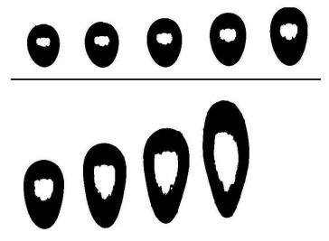
Figure B. 20. Remontée d'une bulle durant l'injection (pas de 10 kPa - Carbopol® :  $\tau_s$  = 71 Pa).
