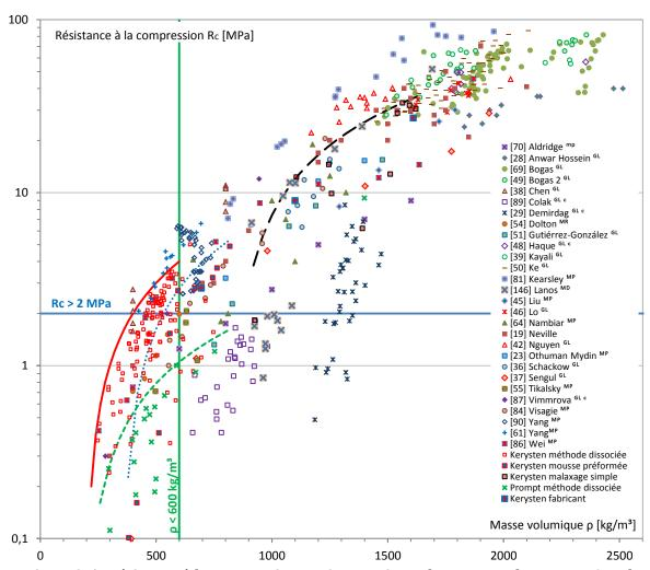
Figure C. 57 Résistance à la compression  $R_c$ : Comparaisons des mousses de Kerysten\$ et de ciment Prompt aux mousses issues de la littérature.
