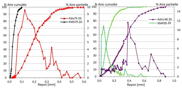
Figure D. 11. Influence de la méthode : Distributions alvéolaires surfaciques des mousses de CTAB Kdis79 et KMS79 (gauche) et de Neopor Kdis148 et KMP09 (droite).
