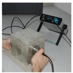
Figure C. 8. Pundit®. Appareil de mesure de la vitesse des ultrasons
