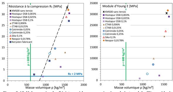
Figure C. 18. Malaxage simple: Résistance à la compression (gauche) et module d'Young (droite).
