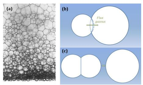
Figure B. 7. Sources d'instabilité : (a) Drainage [96] ; (b) Mûrissement ; (c) Coalescence.
