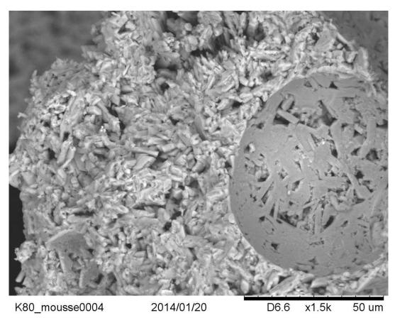
Figure C. 48. MEB: Mousse CTAB Kdis80 - petite bulle (d = 0,006 %)
