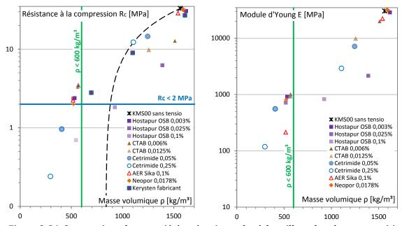
Figure C. 26. Comparaison des propriétés mécaniques des échantillons de même composition produits par malaxage simple et méthode dissociée.
