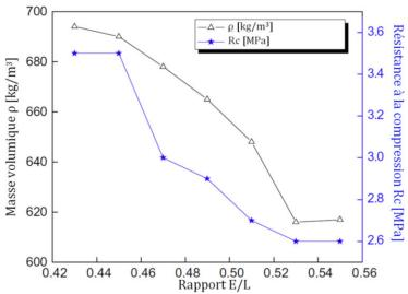
Figure A. 9. Effet du rapport massique eau/liant sur la masse volumique et la résistance mécanique selon Yang et al. [90].
