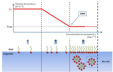
Figure B. 4. Evolution de la tension de surface en fonction de la concentration en tensioactif.
