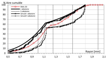
Figure D. 21. Distributions alvéolaires surfaciques dans le cas de la mousse modèle bidisperse E16 (R = 1,13 mm et R' = 1,79 mm).
