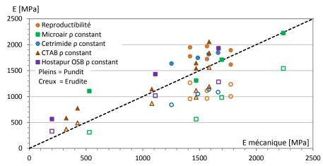
Figure C. 34. Essais acoustiques : Comparaison des valeurs de modules d'Young acoustiques aux modules d'Young mécaniques des mousses de Kerysten® pour les 5 groupes.
