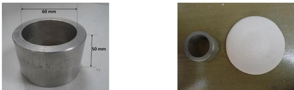
Figure C. 3. Essai étalement : Anneau FLS (gauche) ; Galette de pâte à la fin de l'essai (droite)
