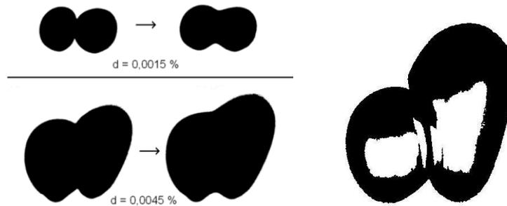
**Figure B. 28. Contours des bulles avant puis après rupture de la membrane (gauche) ; Contact entre 2 bulles de tailles différentes (droite).**
