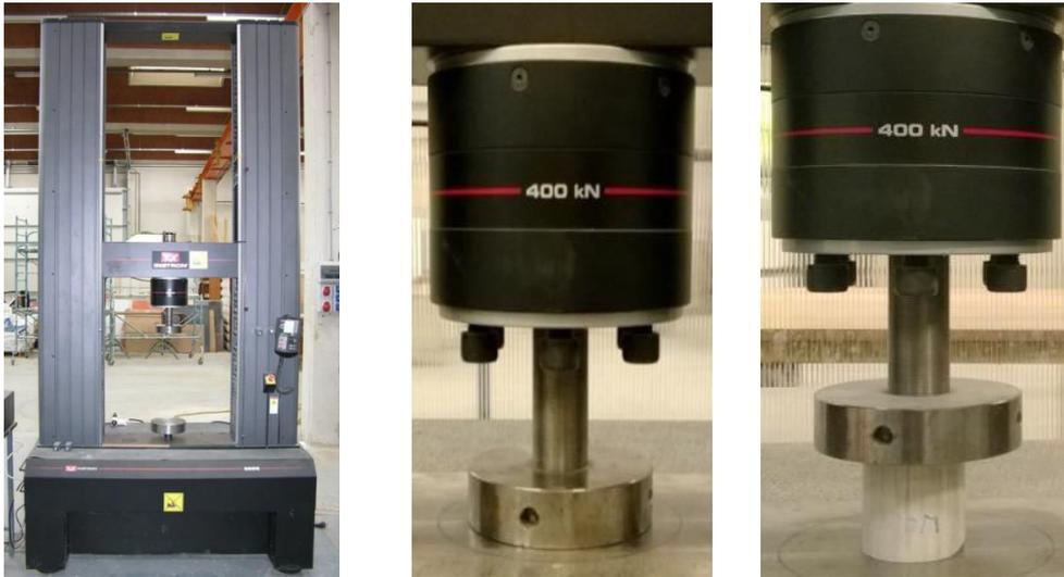
Figure C. 5. Presse Instron® (gauche) ; Essai à vide (centre) ; Essai de mousse en compression (droite).
