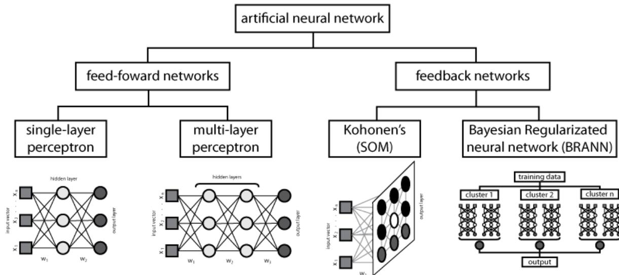
Figure 2.5. Exemples d'architecture des réseaux neuronaux artificiels les plus répandues (d'après Maltarollo et al., 2013)
