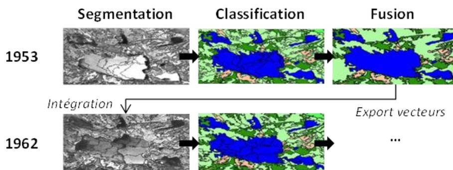
Figure 2. Méthodologie GEOBIA de classification à partir d'orthophotoplans historiques destinée à éviter les erreurs de sur/sous détection liées aux décalages spatiaux inhérents au contexte topographique montagnard
