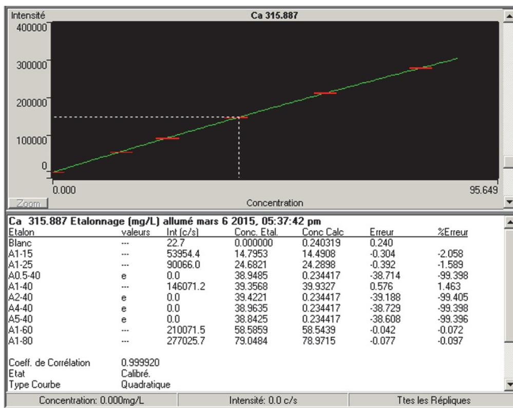
Figure 31 : Capture d'écran du logiciel de l'ICP illustrant la détermination des droites de calibration (en vert) à partir des intensités relatives mesurées pour chaque standard (en rouge) de la gamme étalon.
