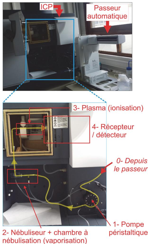
Figure 29 : Schéma de fonctionnement d'un ICP-OES
