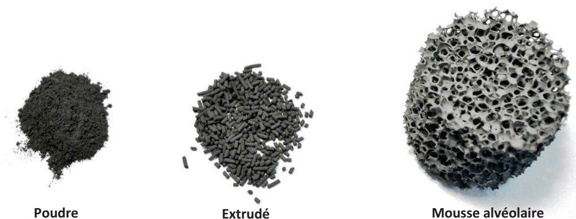
Figure 3. Différentes formes à base de carbure de silicium de structure \beta utilisées pour la dispersion des nanodiamants.
