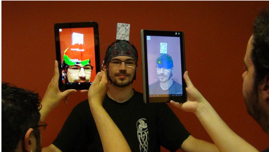
Figure 7 – L’approche “Mind-Window” permet à un seule ou à plusieurs personnes de voir l’activité cérébrale d’une autre personne in situ en utilisant des tablettes et de la RA. L’affichage du cerveau virtuel est mis à jour en temps réel par rapport à l’activité cérébrale de l’utilisateur portant un casque EEG.
