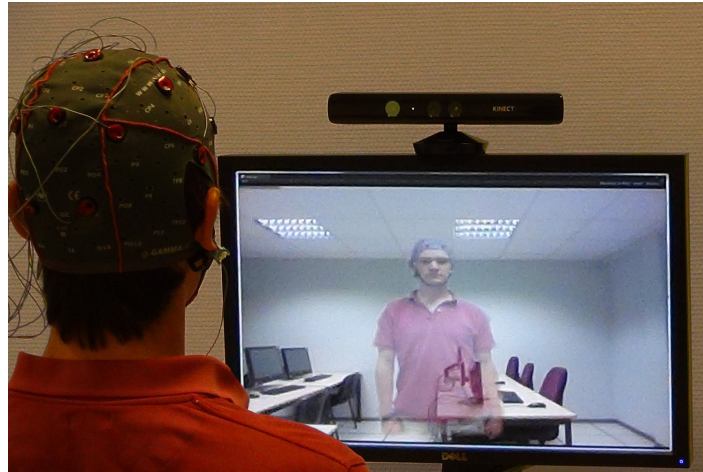
Figure 12 – Le B-C-Invisibility Power permet aux utilisateurs de devenir virtuellement invisibles en exécutant des tâches mentales. Les signaux cérébraux sont extraits en utilisant des électrodes EEG et analysés au sein de l'ICO.
