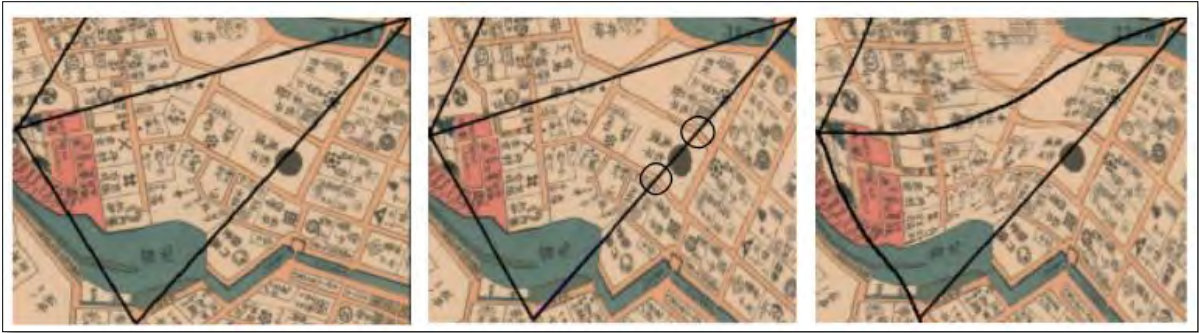
Figure 5-4. Exemples de déformations introduites par le modèle de Delaunay : l'image de droite est l'image originale, l'image au centre est l'image transformée par l'application d'une fonction polynomiale d'ordre 1 et l'image de droite est l'image transformée par l'application d'une fonction polynomiale d'ordre 5 (source : Shimizu et Fuse 2003)
