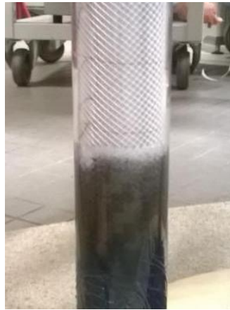
Figure 4.8 : Front de propagation de la résine en cours d'infusion (de bas en haut) ; on distingue la grille de diffusion et le tissu d'arrachage perforé à travers le tube (en haut) et les tissus imprégnés de résine (en bas).
