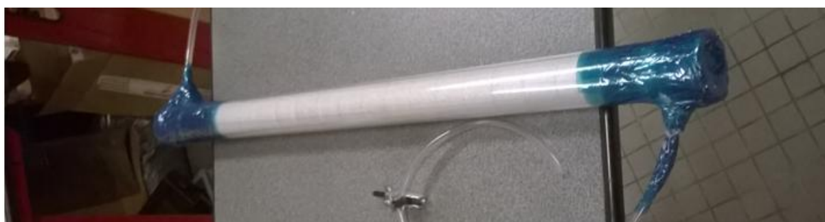
Figure 4.7 : Montage prêt pour l'infusion
