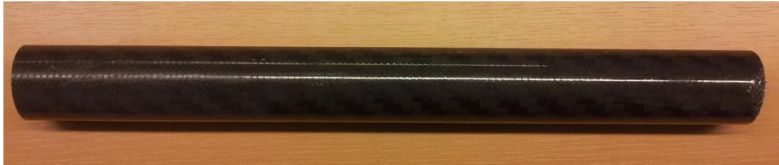
Figure 4.9 : Segment du bras robotique en composite stratifié hybride
