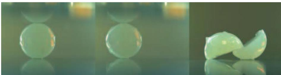
Figure 3.12: photos d'un agrégat imbibé par le didp de diamètre  $5 \text{ mm}$  comprimé entre deux plaques. De gauche à droite: avant, pendant et après la rupture.
