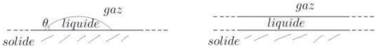
Figure 2.1: les deux régimes de mouillage d'une goutte de liquide déposée sur une surface solide plane. À gauche le mouillage partiel, le liquide prend la forme d'une sphère coupée selon l'angle de contact  $\theta$ . À droite le mouillage total, le liquide prend la forme d'un film.
