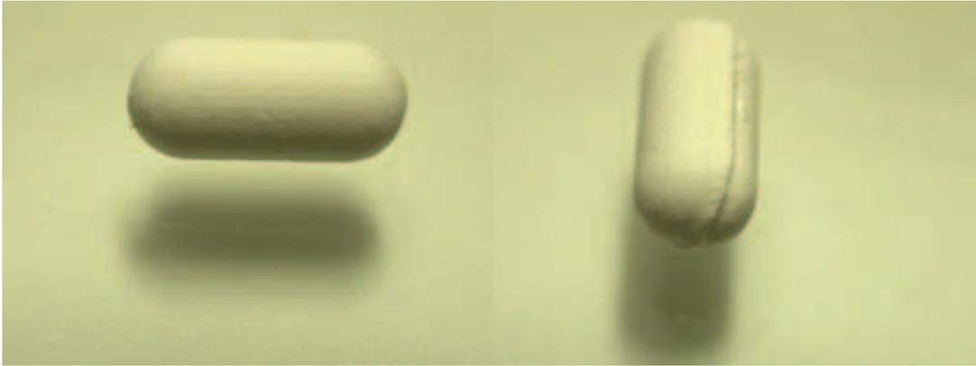
Figure 2.111: photos de l'agrégat en forme de cylindre à bouts sphériques fabriqué. Les dimensions de l'agrégat sont une longueur bout à bout de  $7\text{ mm}$  et un diamètre de  $3\text{ mm}$ .
