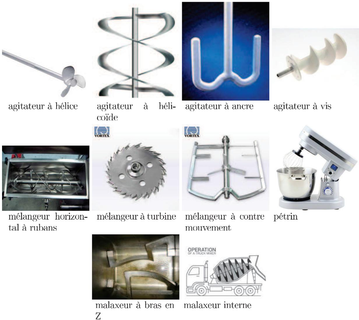
Figure 3.31: images de mélangeurs discontinus indiqués sur l'abaque de la figure 3.30.
