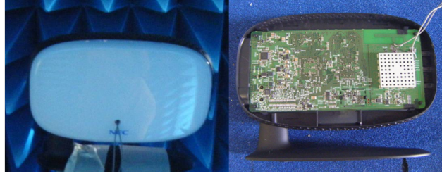
FIGURE 2.4 : Vues externe et interne du système femtocell considéré.
