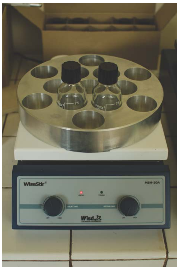
Figure IV-24 : Photographie du dispositif de traitement hydrothermal des silices.
