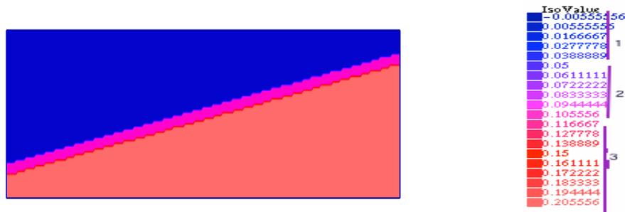
FIGURE 5.4 – Coupe à  $y=1,5$  de la condition initiale 3D à gauche et à la droite la légende des couleurs : on considère que 1 correspond à la zone d’eau douce, 2 correspond à la zone de mélange et enfin 3 correspond à la zone d’eau salée.
