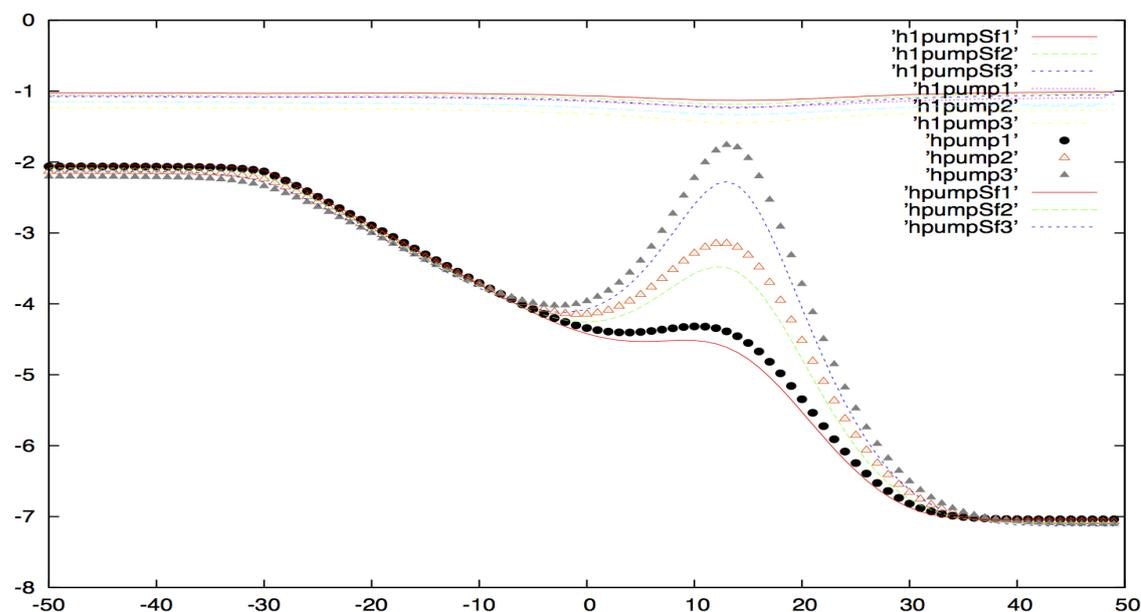
FIGURE 5.27 – Comparaison des interfaces  $h$  et  $h_1$  dans le cas où l'on considère la compressibilité du sol ( $S_f = 0.25$ , ' $S_f$ ') et dans le cas où on a un milieu incompressible ( $S_f = 0$ ) : scénario de pompage (le pompage est constant à travers un puits de rayon  $1m$  centré à  $(15; 50)$ ;  $\phi = 0.3$ ;  $K_f = 39.024m/jour$  et  $\delta = 0.1m$ ).
