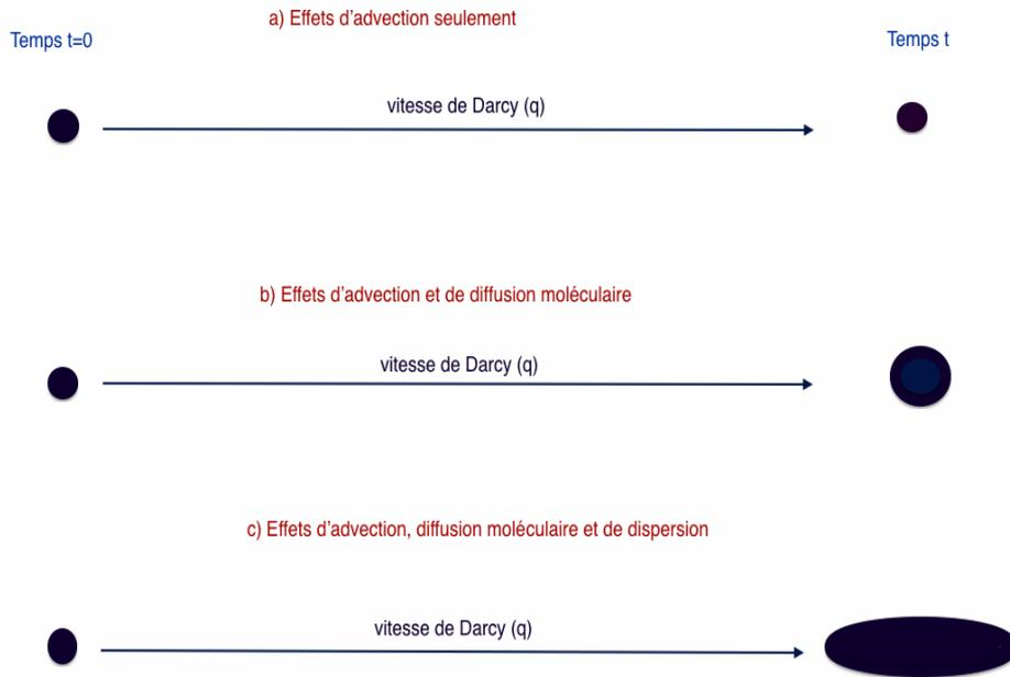
FIGURE 5.1 – Trois mécanismes de transport.
