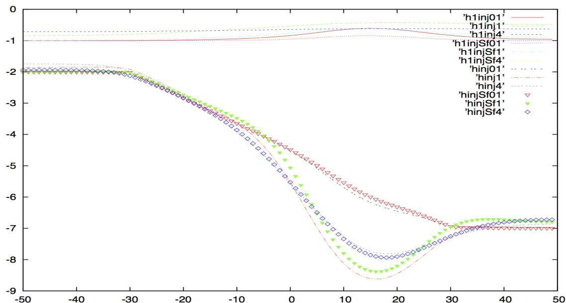
FIGURE 5.26 – Comparaison des interfaces  $h$  et  $h_1$  dans le cas où l'on considère la compressibilité du sol ( $S_f = 0.25$ , ' $S_f$ ') et dans le cas où on a un milieu incompressible ( $S_f = 0$ ) : scénario de remplissage ( $\phi = 0.3$ ;  $K_f = 39.024m/jour$  et  $\delta = 0.1m$ ).
