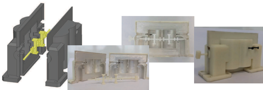
Figure 121: Vues du filtre quatre pôles plastique avec diélectrique en alumine
