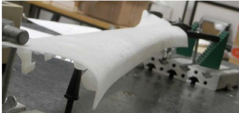
Figure 79 : Montage de mesure du 1<sup>er</sup> montant de baie : appui réglable
