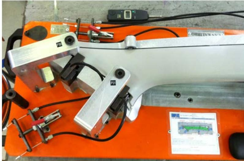
Figure 89 : Moyen de contrôle avec départs de références
