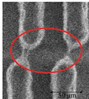
Figure 102 Un exemple sur un défaut de « pont », CD SEM après l'étape de la lithographie
