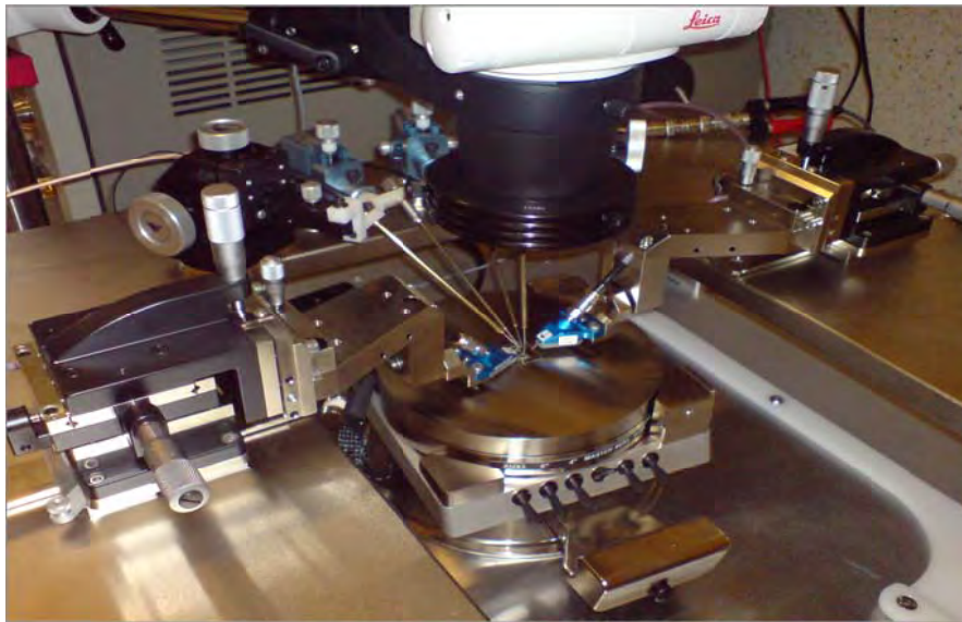
Figure B-45 Les mesures avec un analyseur de réseau vectoriel (VNA).
