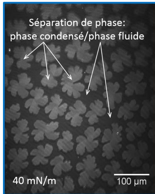
Fig. 25 Image BAM du surfactant pulmonaire à l'interface air-liquide de la cuve de Langmuir. Sa structure est constituée des domaines des lipides condensés ( E \uparrow ) contenant comme on l'a vu auparavant du DPPC en phase solide et du DPPS au centre des domaines. Ces domaines sont repartis dans une masse de phase fluide ( E \downarrow ) constituée d'un mélange de DPPC/DLPC/DPPS dans un état désordonné.
