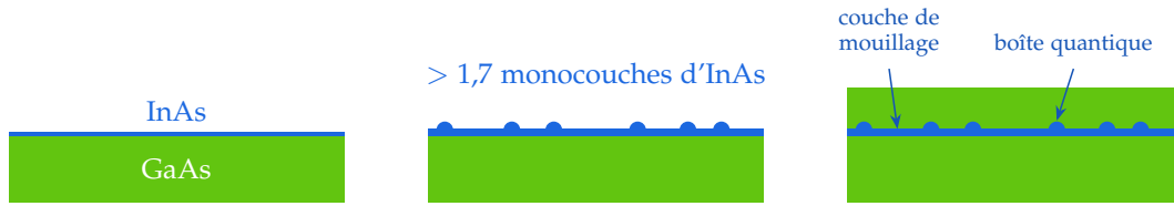
FIGURE 1.2 — Étapes de fabrication de boîtes quantiques InAs/GaAs par la méthode SK.
