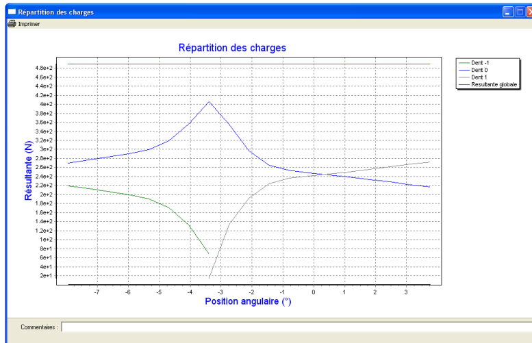
Figure 4.123 : Représentation de la répartition des charges sur 3 dents
