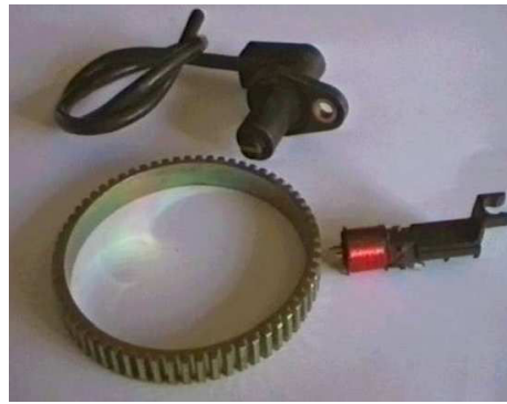
FIG.3.6. Aperçu du capteur de vitesse à réluctance variable (@CEDRAT)
