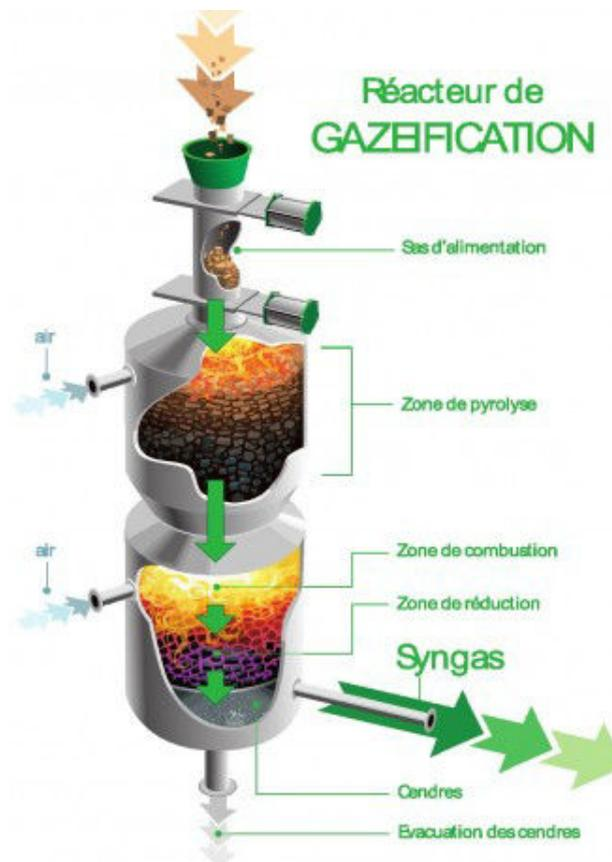
**Figure 1.3 :** Réacteur NOTAR<sup>®</sup> de gazéification à lit fixe étagé développé par XyloWatt.
