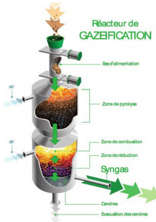
Figure 1.3 : Réacteur NOTAR ® de gazéification à lit fixe étagé développé par XyloWatt.
